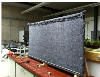
Eine vorbereitete PVC-Platte mit Geovlies, April 2012 und kurz nach Bepflanzung
