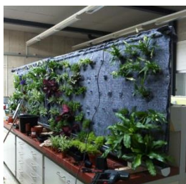
Eine vorbereitete PVC-Platte mit Geovlies, April 2012 und kurz nach Bepflanzung
