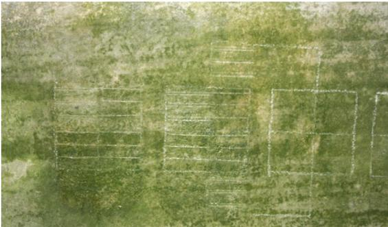
Bild 40: Probefläche Untere Kapelle zur Beurteilung der Festigung im Zusammenhang mit biogenem Bewuchs
