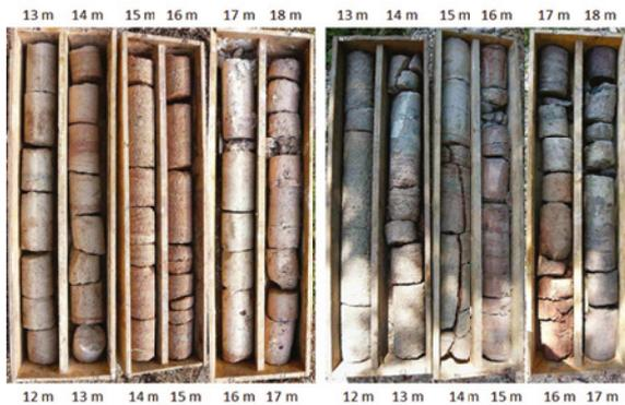
Bild 3: Ausschnitte der entnommenen Bohrkern im Tiefenbereich 12 m bis 18 m. Links: Bohrung 1. Rechts Bohrung 2.
