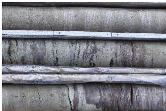
Bild 7: Bohrkern - Schrägschichtung aus Lindenfirstbohrung [Quelle: RP Stuttgart, Bung]
