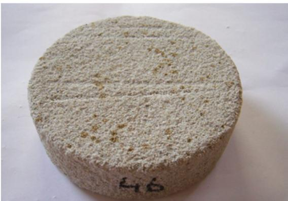
Bild 21: Punktförmige, braune Farbveränderungen der Oberfläche des Probekörpers nach der H<sub>2</sub>O<sub>2</sub> Behandlung
