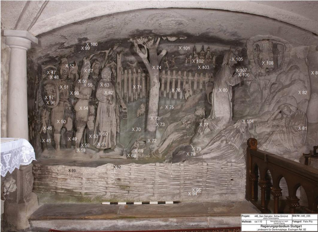
Bild 11 Analysenpunkte der zerstörungsfreien NIR-Messungen am Ölberg [Dokumentationsgrundlage: Landesamt für Denkmalpflege im RP Stuttgart, Felix Pilz].
