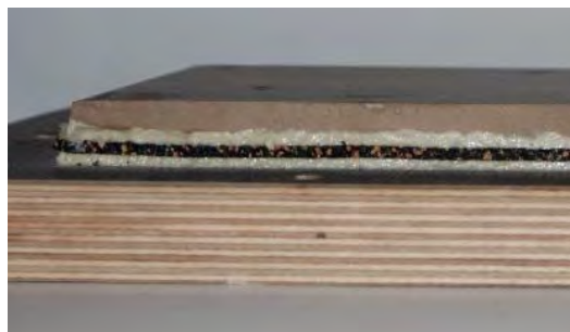
Abb. 65: Beispiel für einen der untersuchten Bodenbeläge (Fliese mit schalldämmender Unterlage Damtec Standard) in seitlicher Ansicht. Zu sehen sind (von oben nach unten):
