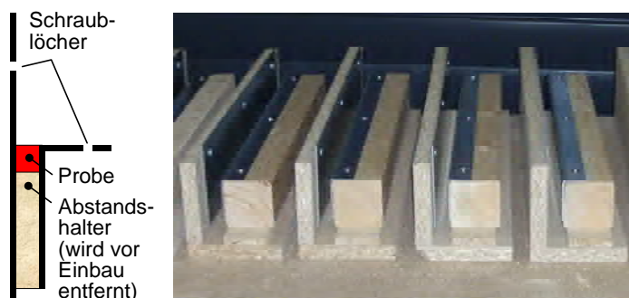
Abb. 54: Schnittzeichnung von Probenhalter und Probe (links) und Vorrichtung zur Herstellung von Fugendichtungen mit definierter geometrischer Form
