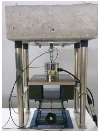
Abb. 29: Aufbau zur Messung des dynamischen Elastizitätsmoduls und des Verlustfaktors von Elastomerproben in Abhängigkeit von der Frequenz. Der dynamische Schwingerreger (es handelt sich um einen Inertial-Shaker vom Typ Data Physics IV40 mit einer Masse von ca. 1,5 kg) ist in eine elastisch gelagerte Holzplatte eingelassen, um Taumelbewegungen der Messanordnung zu vermeiden und eine rein axiale Verformung der Probe sicherzustellen. Die Hebebühne (Scherentisch) dient als Hilfsvorrichtung beim Ein- und Ausbau der Probe und trägt das Gewicht des Shakers, so dass die Probe keiner statischen Vorlast ausgesetzt ist. Das Gegenlager zur Aufnahme der in die Probe eingeleiteten Kraft bildet ein Betonstein mit einer Masse von ca. 25 kg.
