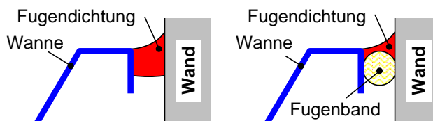
Abb. 61: Verbesserung der Körperschallisolierung einer elastischen Fugendichtung durch den Einsatz eines runden Fugenbandes. Gegenüber der praxisüblichen - schalltechnisch ungünstigen - Ausführung der Fuge (links im Bild) vermindert das Band die Fugenhöhe und damit die Körperschallübertragung erheblich. Die auf der rechten Seite abgebildete Situation entspricht in praktischer und akustischer Hinsicht nahezu dem Idealfall, da einerseits die auf Wanne und Wand vorhandene Klebefläche groß genug ist, um einen Fugenabriss zu vermeiden, die geringe Höhe der Dichtstoffschicht in der Fugenmitte jedoch andererseits die Körperschallübertragung wirksam unterbindet.
