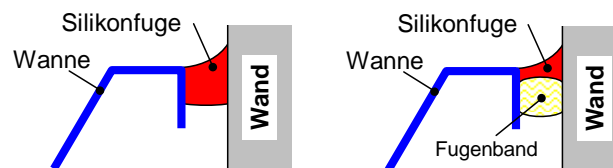
Abb. 16: Beispiel für die akustisch günstige (rechts) und ungünstige (links) geometrische Gestaltung einer Fugendichtung. Als Faustregel gilt: je weniger Dichtstoff sich in der Fuge befindet, desto weniger Körperschall wird übertragen. Um das übermäßige Eindringen von Dichtstoff in die Fuge zu unterbinden, hat sich der Einsatz von Fugenbändern aus weichem elastischem Schaumstoff bewährt.
