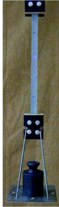
Abb. 24: Bestimmung des statischen Elastizitätsmoduls der untersuchten Dichtstoffe mittels eines Zugversuchs. Die Messungen erfolgten an Probenstreifen mit den Maßen L \times B \times H = 300 \text{ mm} \times 10 \text{ mm} \times 10 \text{ mm} . Gemessen wurde die Dehnung der Probe infolge einer am unteren Ende einwirkenden Zugkraft, wobei die Abstandsänderung zwischen zwei im mittleren Teil der Probe (mit ausreichendem Abstand von den Halterungen) angebrachten Markierungen ermittelt wurde. Selbstverständlich erfolgten die Messungen im linearen Bereich der Federkennlinie.
