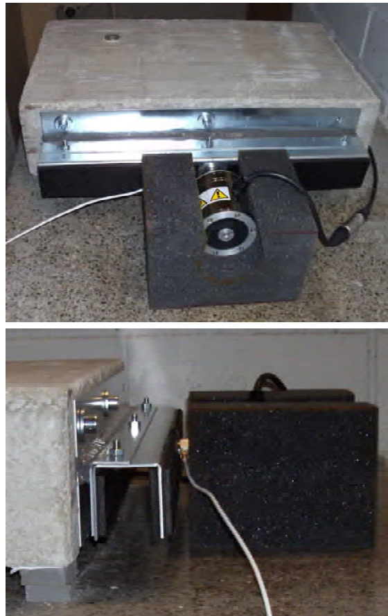
Abb. 53: Foto des verwendeten Versuchsaufbaus. Im oberen Bild ist der gesamte Aufbau in der Vorderansicht zu sehen (von oben nach unten: Betonstein, Probenhalter mit Probe, U-Profil mit Dämpfungsbelag und Shaker im Schaumstoffblock). Das untere Bild zeigt einen Ausschnitt des Aufbaus in seitlicher Ansicht.
