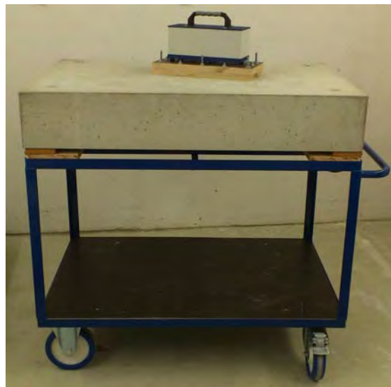
Abb. 64: Gesamtansicht der verwendeten Messvorrichtung mit MIDI-Hammerwerk, Bodenbelag, Probenhalter und elastisch gelagerter Betonplatte. Zum besseren Transport befindet sich die Vorrichtung auf einem Rollwagen.
