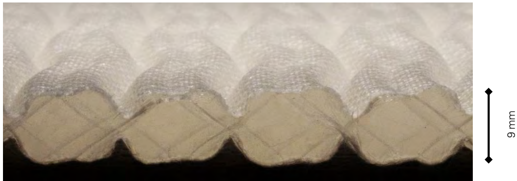
Abbildung 66: Entwickeltes Kollektor-Element: Schnittansicht des fluidgefüllten Taschengewebes
