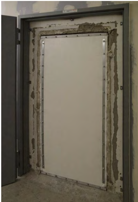
Abbildung 24: Eingebaute Gewebeprobe im Türenprüfstand [1]
