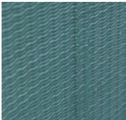
Abbildung 9: Polyestergewebe: Außenansicht in gefülltem Zustand (Foto: ILEK / F. Schmid)
