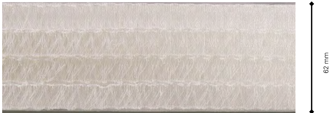
Abbildung 65: Entwickeltes Aerogel-Element: Schnittansicht des folienkaschierten, aerogelbefüllten Abstandsgewirks
