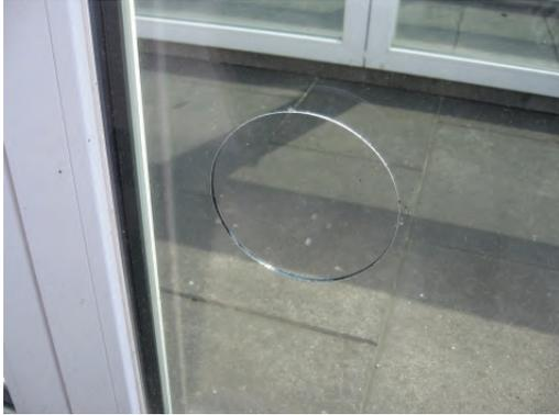
**Abbildung 8** Bohrung in mittlerer Scheibe eines 3-fach MIG-Probekörpers
