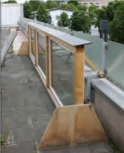
**Abbildung 18** Probekörper der Gruppe D5 in der Freibewitterung
