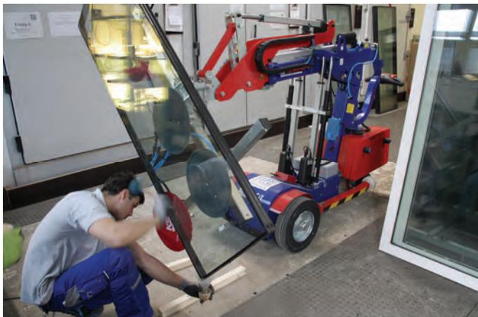
**Abbildung 24** Trockenmittelentnahme an einem Probekörper aus der Pfosten-Riegel-Fassade (R-Gruppen)
