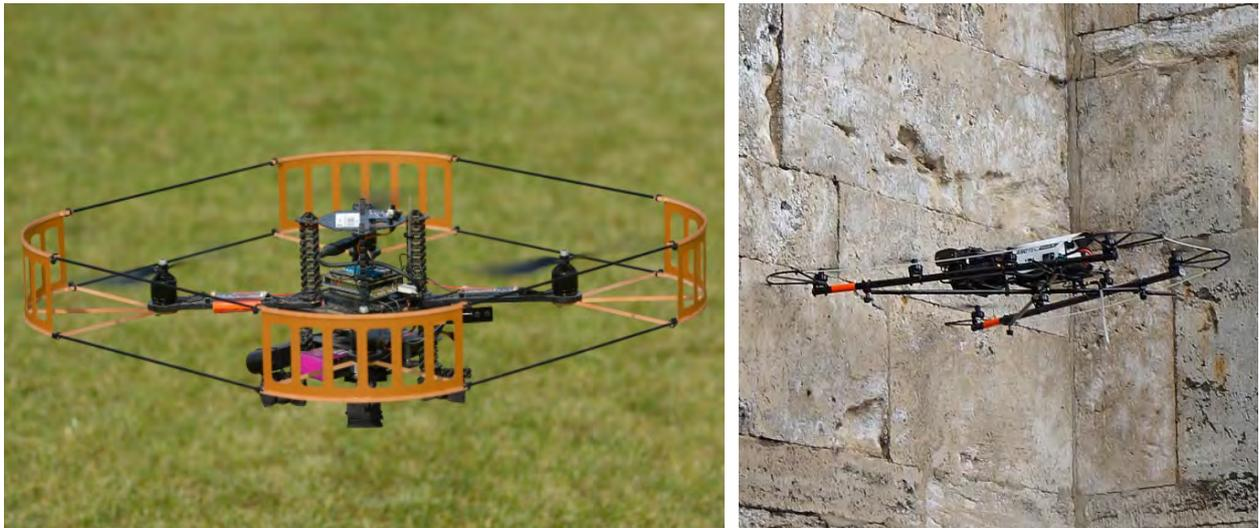
Abbildung 6: Getestete mechanische Anprallschutzmechanismen, links: mechanischer Schutzring am AscTec Pelican [Foto: Späth, AscTec], rechts: Test eines mechanischen Schutzrings am AscTec Falcon 8 beim Kollisionsversuch am Bauwerk
