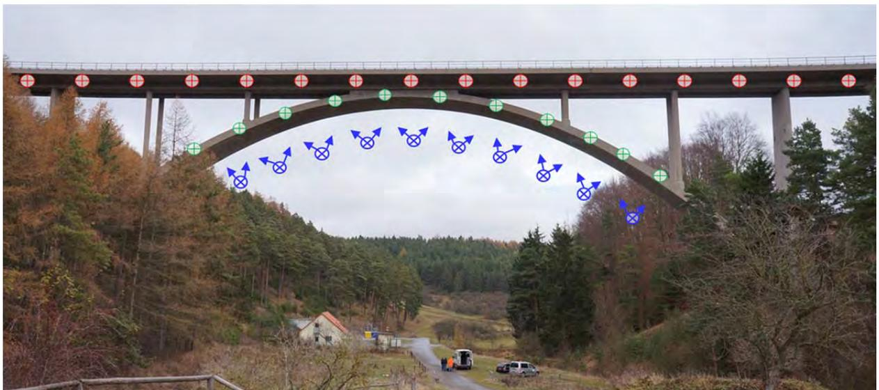
Abbildung 41: Aufnahmepositionen bei der GPS-basierten automatischen Aufnahme der Bogenansicht (grün) und -untersicht (blau) sowie der Ansicht des Überbaus (rot)
