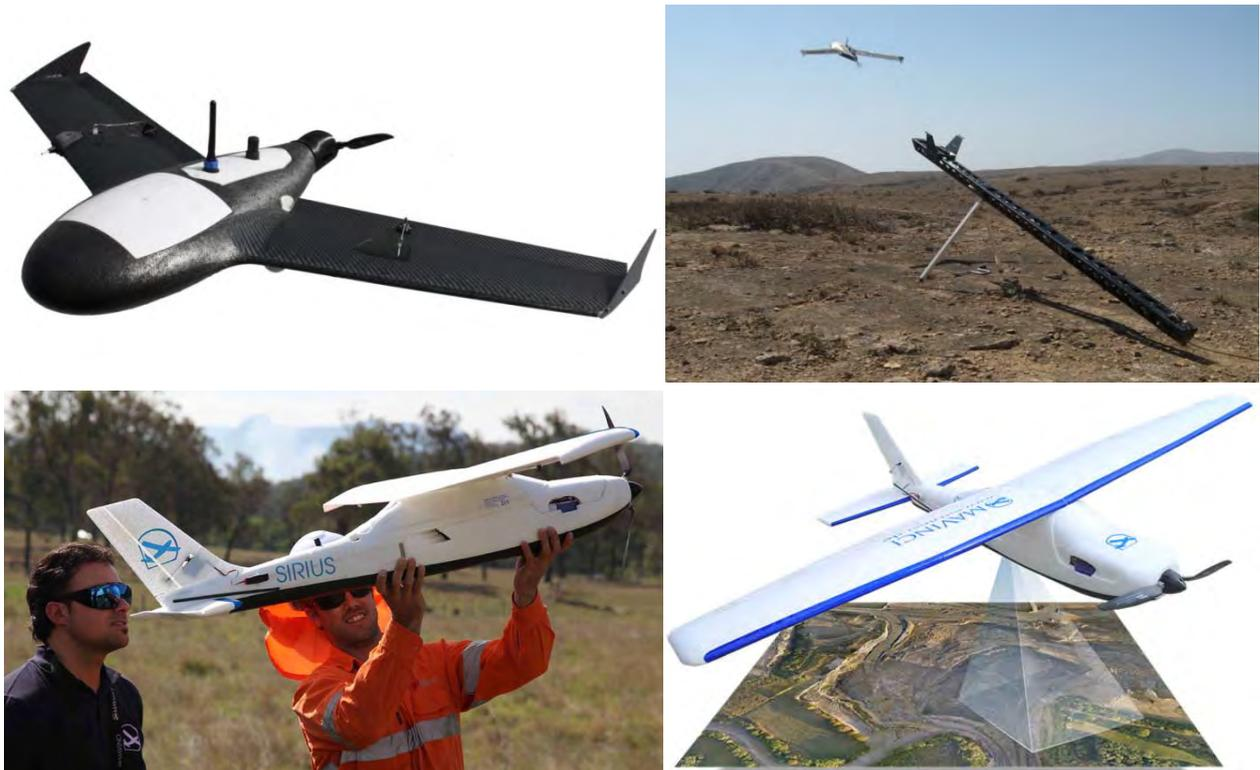
Abbildung 2: Flächen-Flügler-UAS, oben: Gatewing X100 der Firma Trimble mit spezieller Startvorrichtung [7], unten: SIRIUS-UAS der Firma MAVinci [8]
