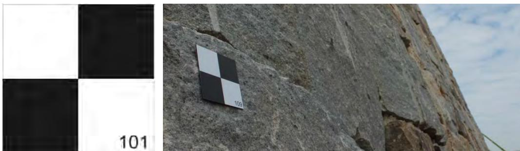
Abbildung 69: Zielmarke 10 cm x 10 cm (links), Passpunkt 109 an der Stützwand (rechts)
