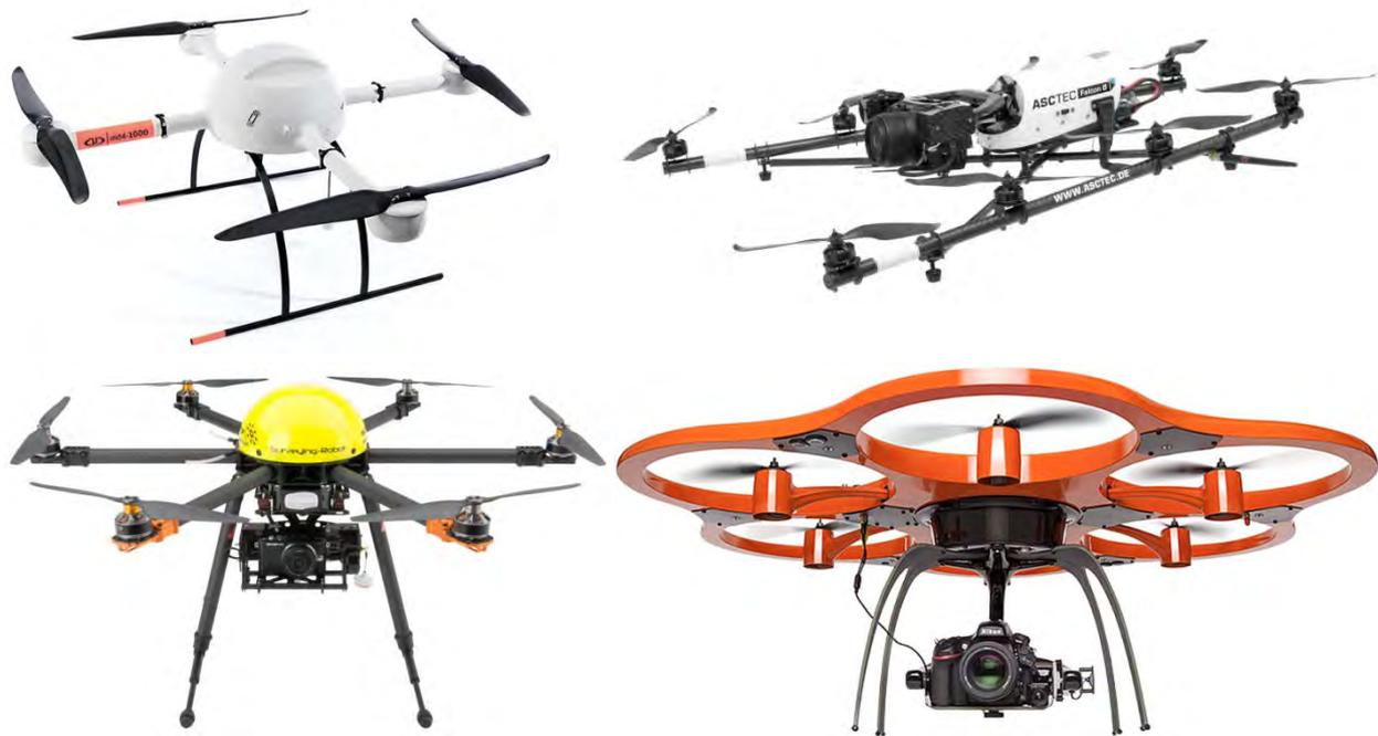
Abbildung 3: Elektrisch betriebene Dreh-Flügler-UAS, oben links: microdrones md4-1000 ohne Nutzlast [9], oben rechts: Ascending Technologies Falcon 8 [10], unten links: Service-drone MULTIROTOR G4 Surveying-Robot [11], unten rechts: Aibotix X6 [12]
