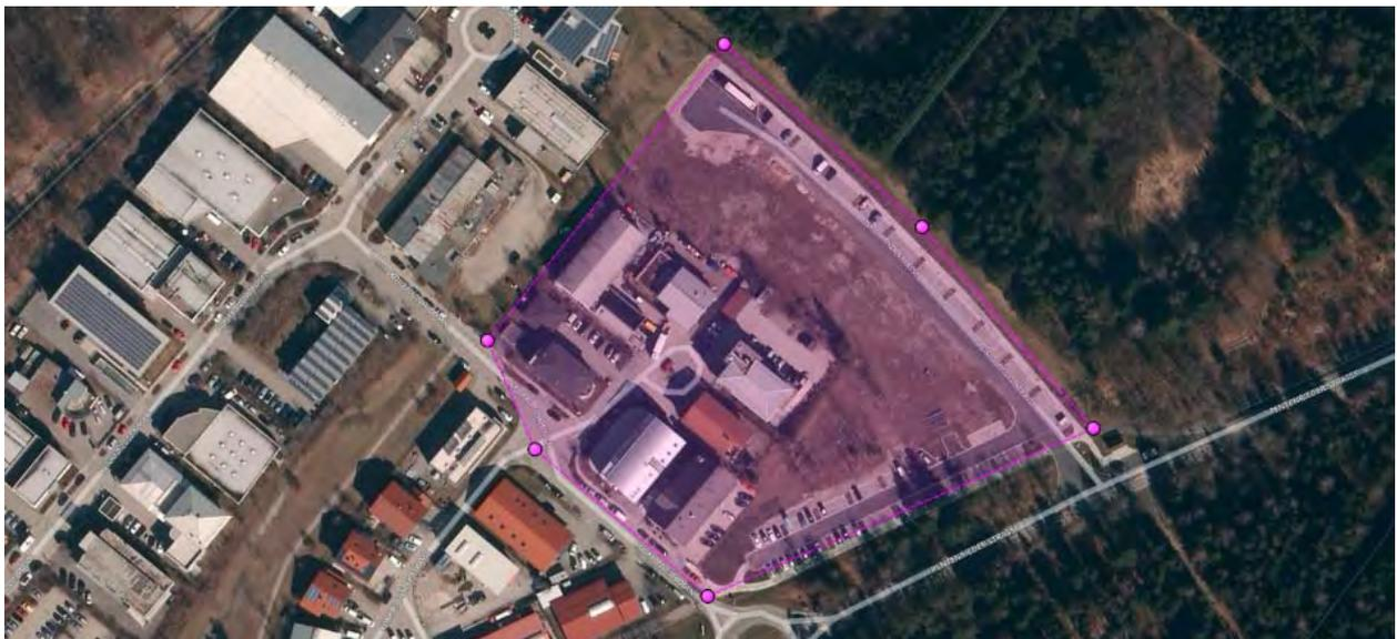
Abbildung 11: Navigationssoftware AscTec Navigator: Aufnahmemodus Matrix, Definition der Aufnahmefläche (farblich gekennzeichnete Polygonzug)
