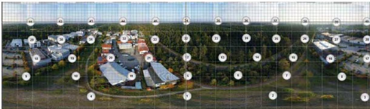
Abbildung 9: Errechnete Bildpositionen bei der Erzeugung eines 360°-Kugelpanorama (Ausschnitt)
