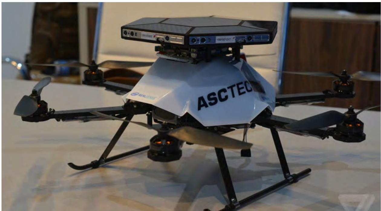
Abbildung 7: Prototyp AscTec Firefly mit Intel RealSense-Technologie (6 Kameras zur Hinderniserkennung) [Foto: Späth, AscTec]
