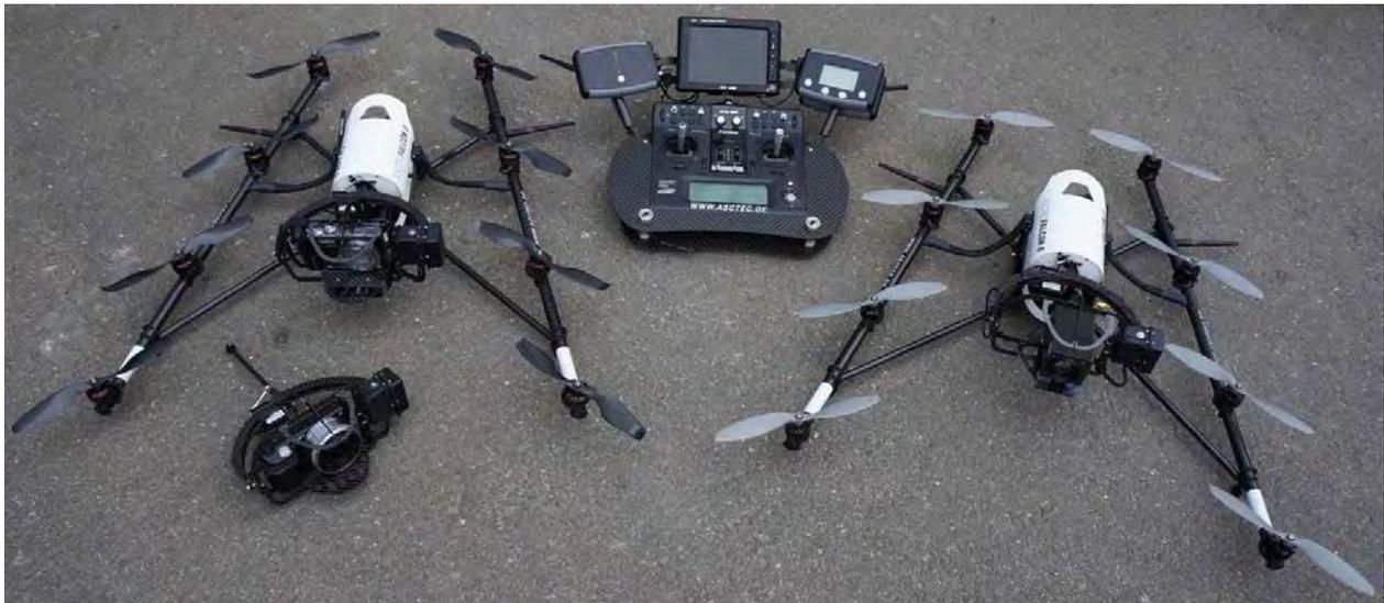
Abbildung 4: Flugsysteme der Bauhaus-Universität Weimar mit mobiler Bodenstation und Kameraausstattung, links: Falcon-Foto mit Panasonic Lumix TZ 22 (auf dem Fluggerät installiert) und Sony NEX-5, rechts: Falcon-Video mit BMS Blockkamera
