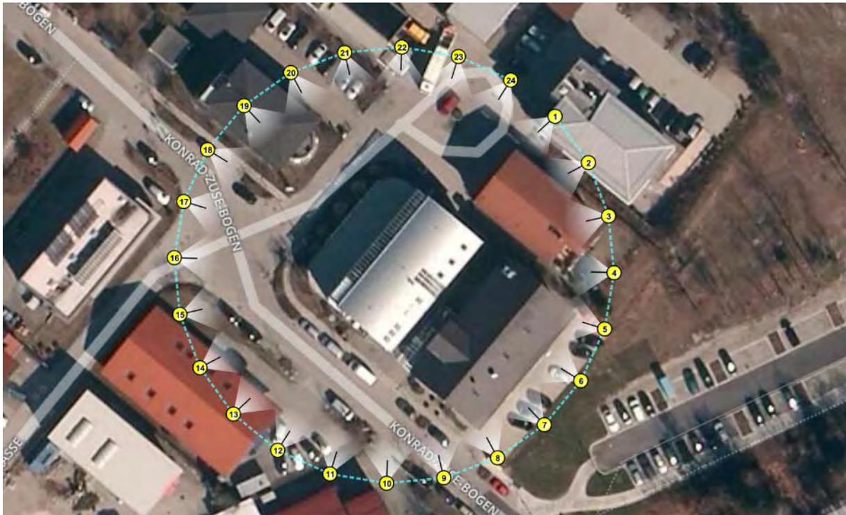
Abbildung 13: Navigationssoftware AscTec Navigator: Aufnahmemodus Circle of Interest (CoI)
