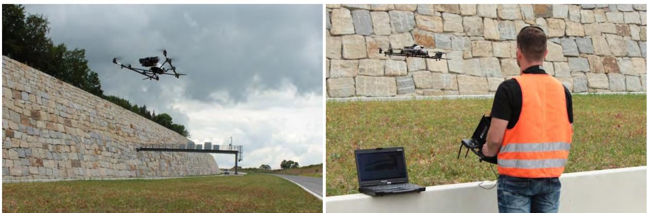
Abbildung 72: Vollautomatische Datenaufnahme mit Hilfe des AscTec Navigator an der Stützwand
