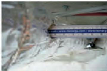
Messung der Dämmstärke im vollständig gedämmten Zustand (mit ablesbaren Werten)
