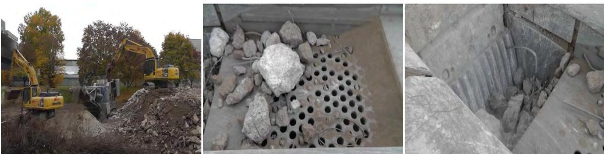
Abbildung 56: Beschicken des Brechers (l.), Auffangtrichter mit Schwerlastsieb (m.) und Einschwingenbackenbrecher (r.)
