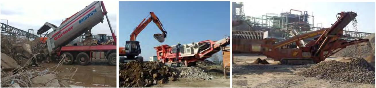
Abbildung 74: Betrieb der mobilen Aufbereitungsanlage
