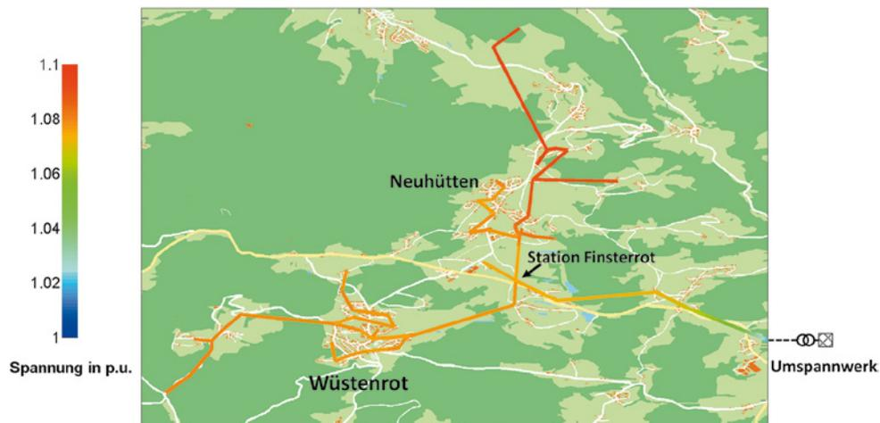
**Abb. 61:** Grafische Darstellung der Spannungsverläufe des Netzgebietes Wüstenrot im extremen Rückspeisefall (Quelle: ifk)
