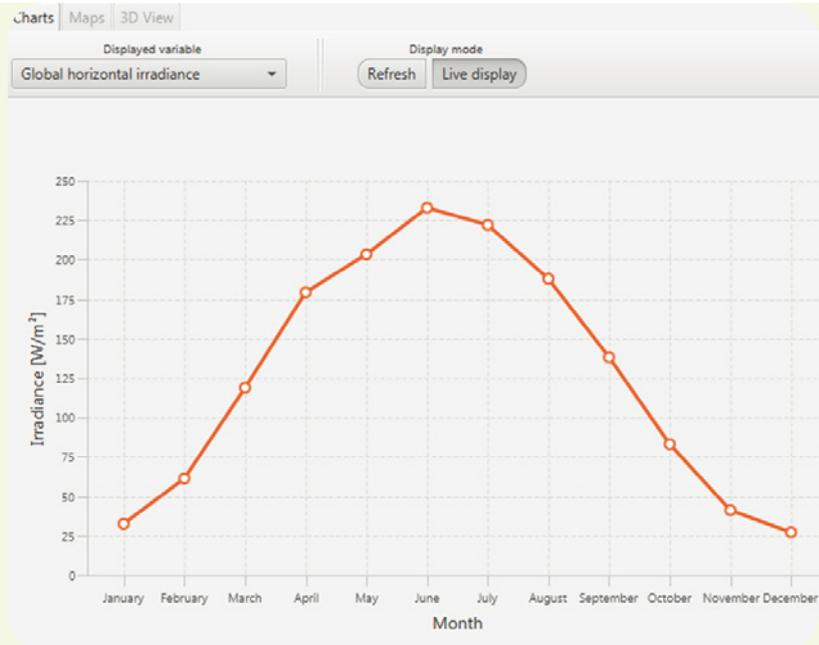
**Abb. 31:** Durchschnittliche Einstrahlung auf die Dachflächen in Wüstenrot (Quelle: zafh.net)
