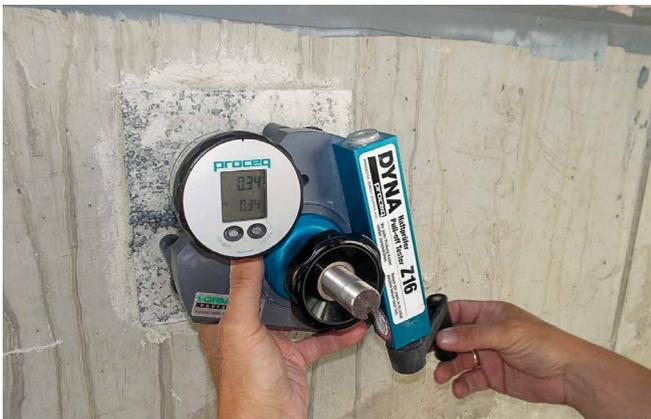
Abb. 17: Haftzugmessung zur Untergrundprüfung
