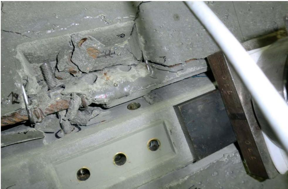
Abbildung 6.18: Versagensbild des Versuchskörpers V1-V1 unter LS 5
