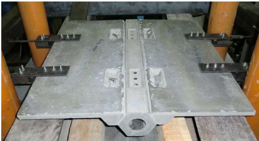
Abbildung 6.14: Montierter Versuchskörper bestehend aus dem Koppелеlement und den beiden Wandelementen
