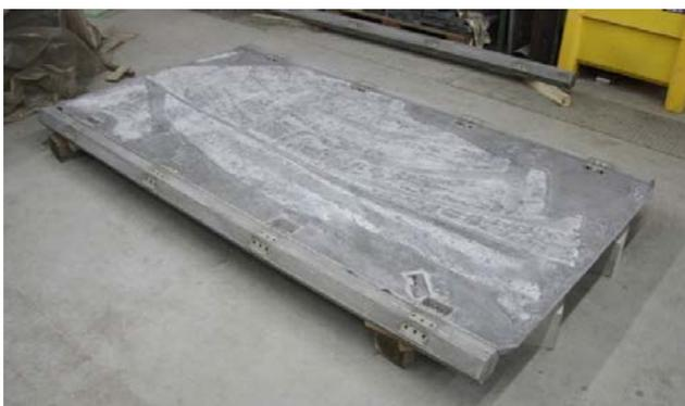
Abbildung 6.59: Fertig montierter Versuchskörper für die Unterdruckversuche
