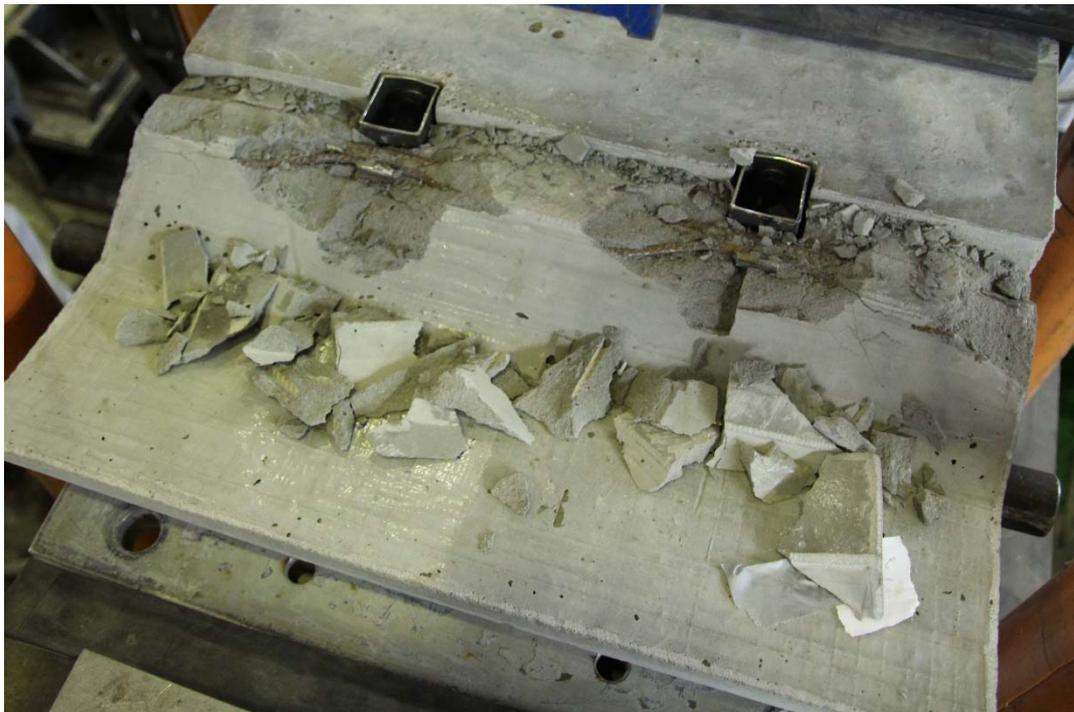
Abbildung 6.49: Durch die Betonabplatzungen sichtbare Stabstahlbewehrung und Anker des Versuchskörpers V3-V1 nach dem Versuch
