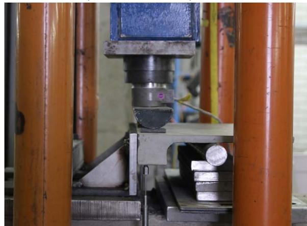
d) Schraubverbindung in Pos.2, Seitenansicht im Prüfstand (Versuche V2-V2)
