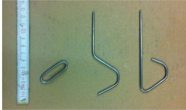
Abbildung 6.4: Bewehrungselemente für den Rand- und Verbindungsbereich der Wandelemente: links: Herstellung auf einem „Biegetisch“, rechts: fertige Elemente.
