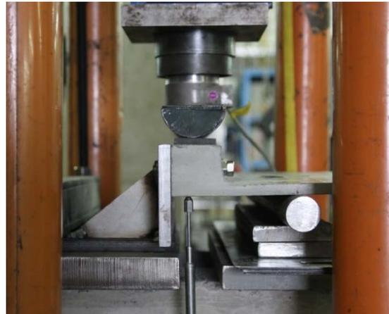
b) Schraubverbindung in Pos.1, Seitenansicht im Prüfstand (Versuche V2-V1)
