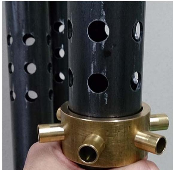
Abbildung 4.19: Manschette und Rundrohr der Stützen
