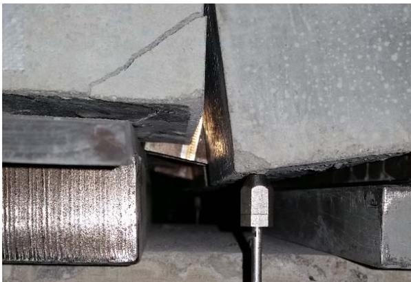
c) Verdrehung des Prüfkörpers (rechtes Beton-element)
