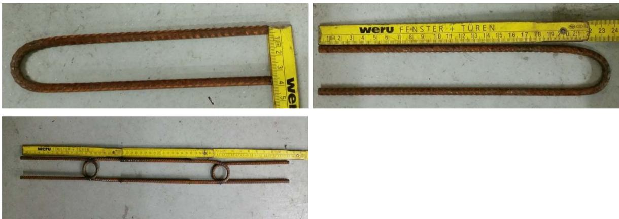
Abbildung 6.30: Schlaufenbewehrung im Verbindungsbereich
