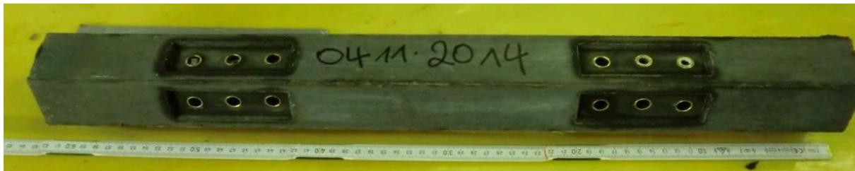
Abbildung 6.13: Ausgeschaltetes Koppелеlement (Stütze)
