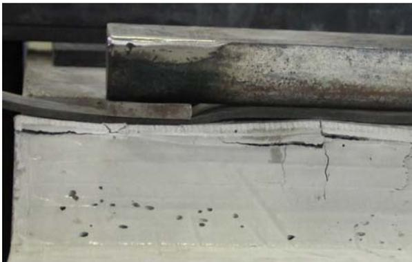
c) Abplatzen der Betondeckung
