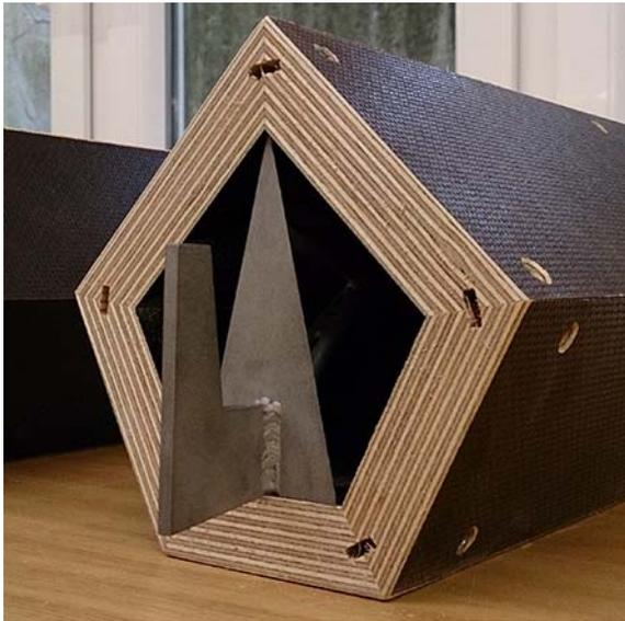
Abbildung 4.16: Kopfplatte und Anschlussstaken der Träger
