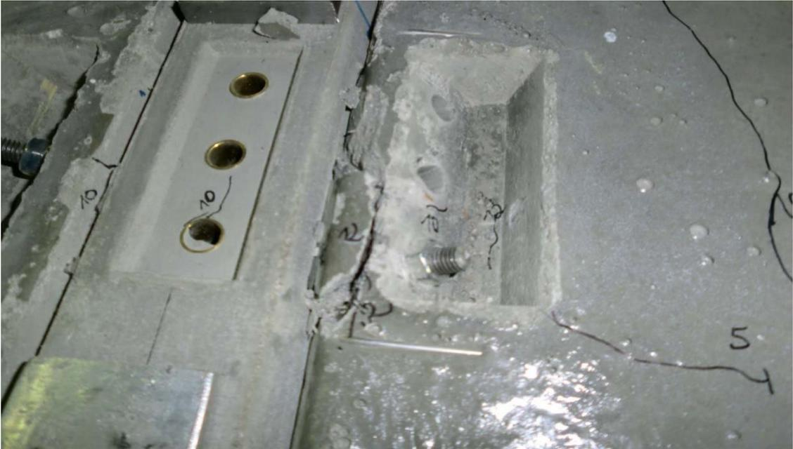
Abbildung 6.17: Verbindungsbereich des Versuchskörpers V1-V1 unter LS 4
