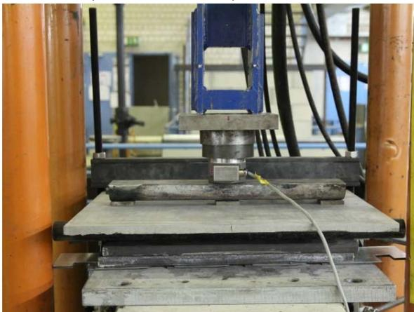
c) Schraubverbindung in Pos.2, Frontansicht im Prüfstand (Versuche V2-V2)
