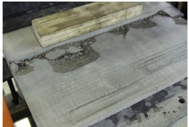
d) Betonabplatzungen im Belastungsbereich
