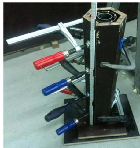
Abbildung 6.11: Stützenschalung mit Bewehrung
