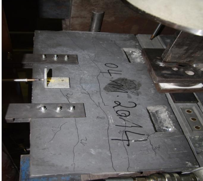
Abbildung 6.21: Versuchskörper V1-V2 unter LS 3
