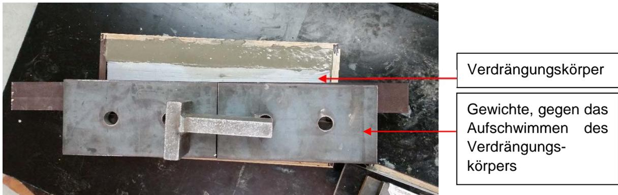
Abbildung 6.29: Betonage der Schraubverbindung
