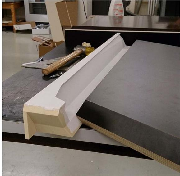
Abbildung 4.6: Detail der 3D-gefrästen Rand-schalung
