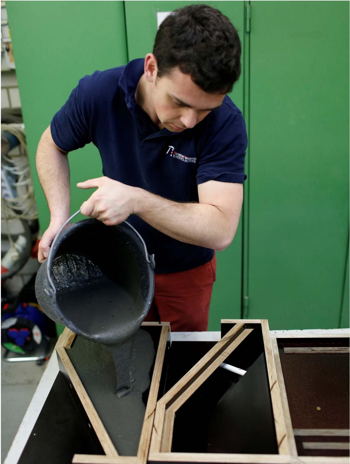
Abbildung 4.11: Einbringen des Feinkornbetons in die vorbereiteten Schalungen
