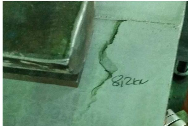
b) Weiterer Riss bei 8,2 kN am rechten Bauteilrand
