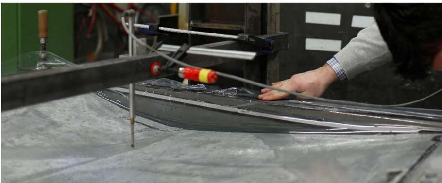
Abbildung 6.63: Späterer Versagensbereich des Wandelements am Randbalken
