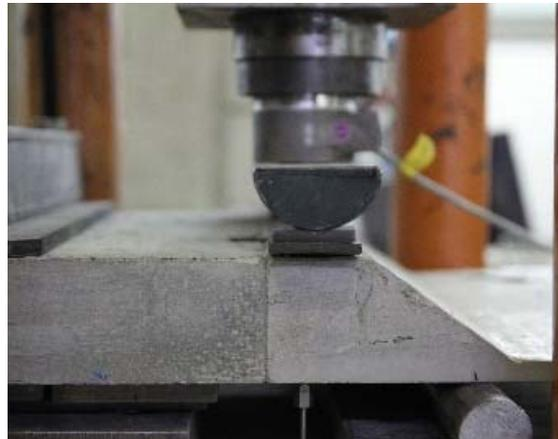
b) Probekörper V3-V2 des Verbindungssystems V3 in Pos.2; Seitenansicht des Versuchstandes
