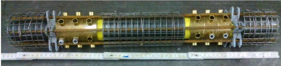
Abbildung 6.7: Bewehrung der Koppellelemente (Stützen)
