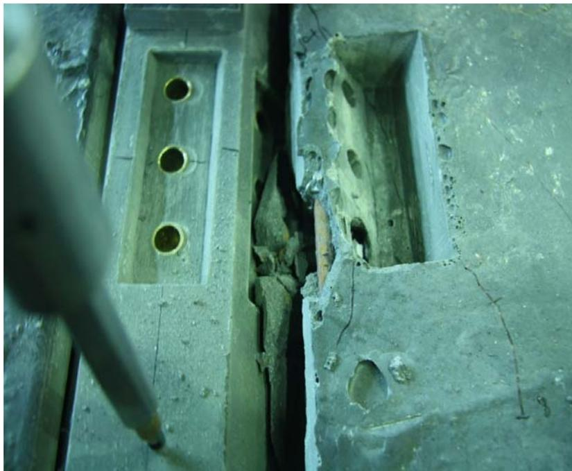
Abbildung 6.22: Versagensbild des Versuchskörpers V1-V2 unter LS 4
