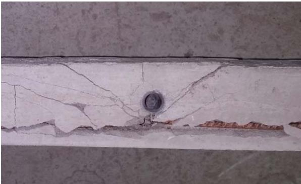
c) Risse im Bereich der Auflagerung an der linken Schraube
