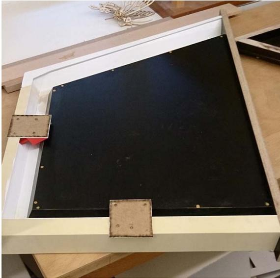
Abbildung 4.5: fertige Schalung eines Wandelements
