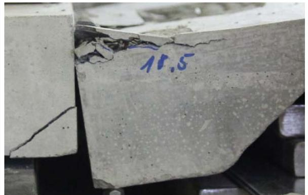
f) Betonabplatzungen über der Mikrobewehrung (rechts) und Risse im Massivkörper (links)
