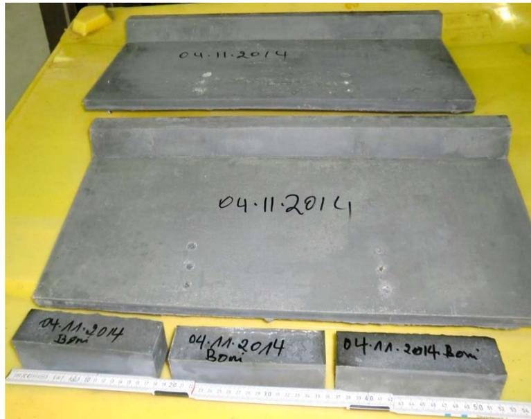
Abbildung 6.12: Ausgeschaltete Wandelemente und Probekörper zur Ermittlung der Betonfestigkeit
