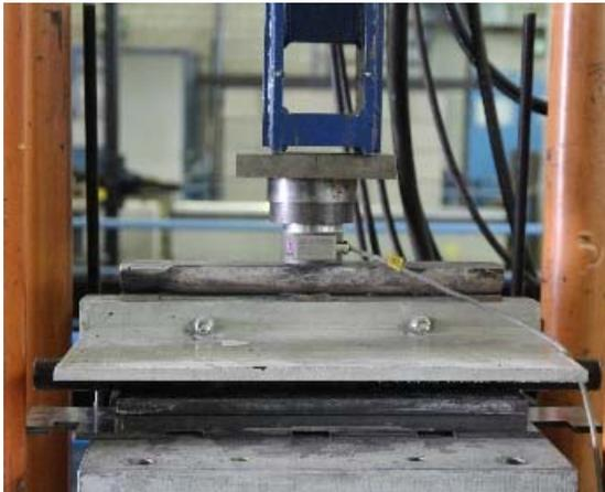
a) Schraubverbindung in Pos.1, Frontansicht im Prüfstand (Versuche V2-V1)
