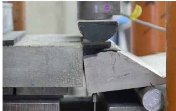
d) Verdrehung des Prüfkörpers und Abplatzen der Betondeckung
