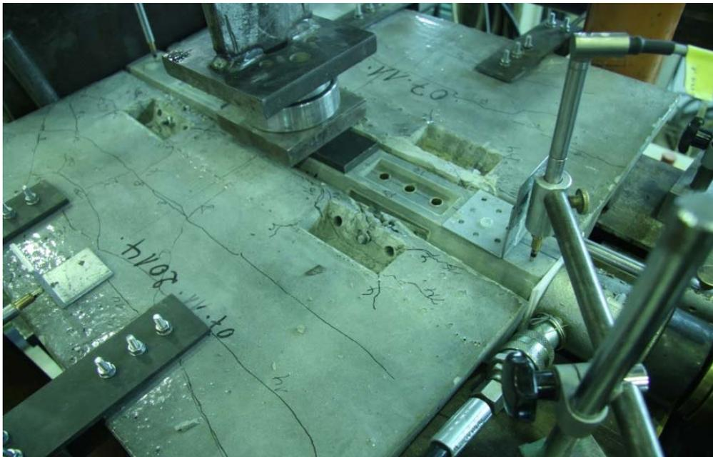
Abbildung 6.26: Versagensbild des Versuchskörpers V1-V3 unter LS 5
