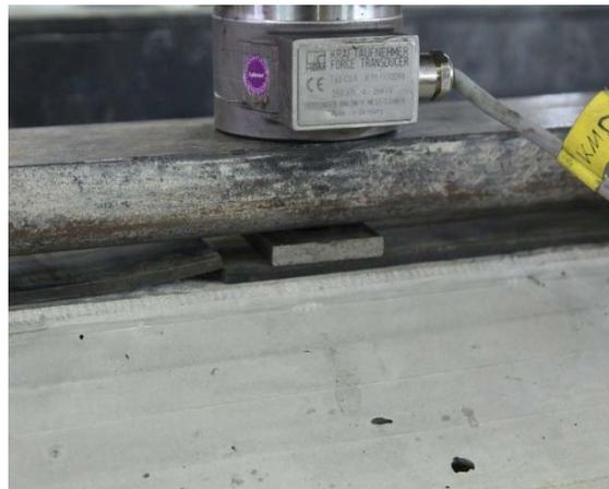
d) Lasteinleitung mittels stählerner Halbschale, Stahlplatten und Elastomerstreifen
