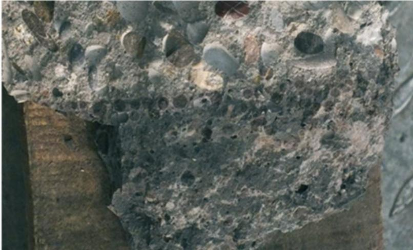
Abb. 6-14: Verbund zwischen Leichtbetonelement (unten) und Beton (oben) nach dem Bruch
