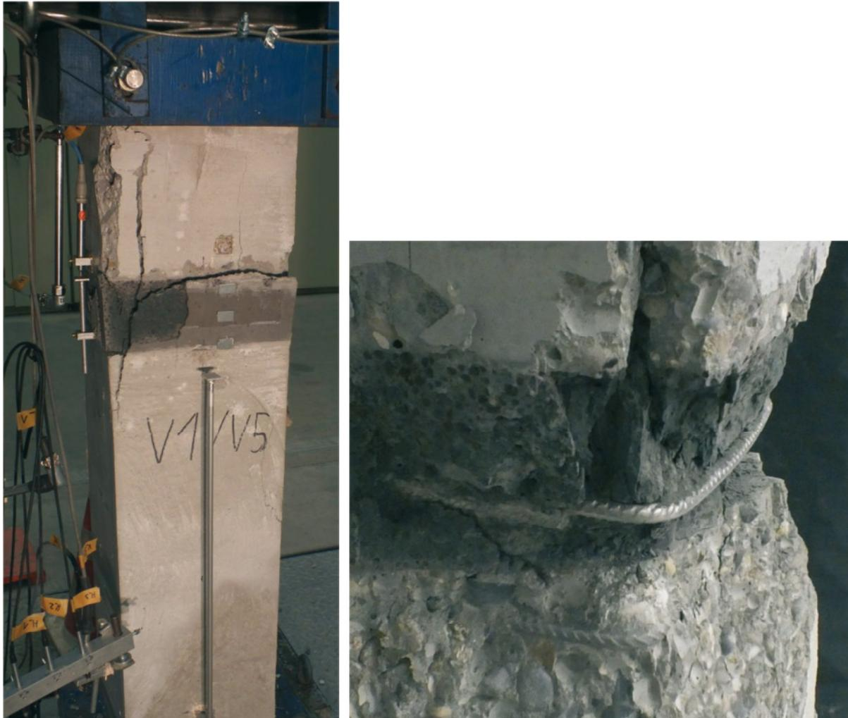
Abb. 6-8: Bruchbild und Detailansicht Bewehrung – V1.1
