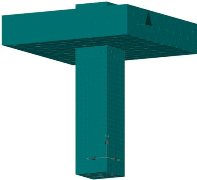
Abb. 8-1: FE-Modell inkl. Deckenplatte
