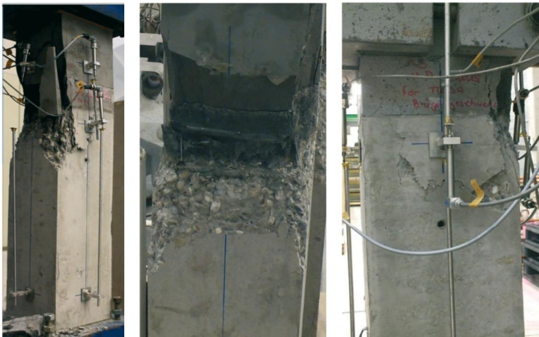
Abb. 6-22: Bruchbilder der Versuchsserie 3 mit V3.1 (links), V3.2 (mittig) und V3.3 (rechts)
