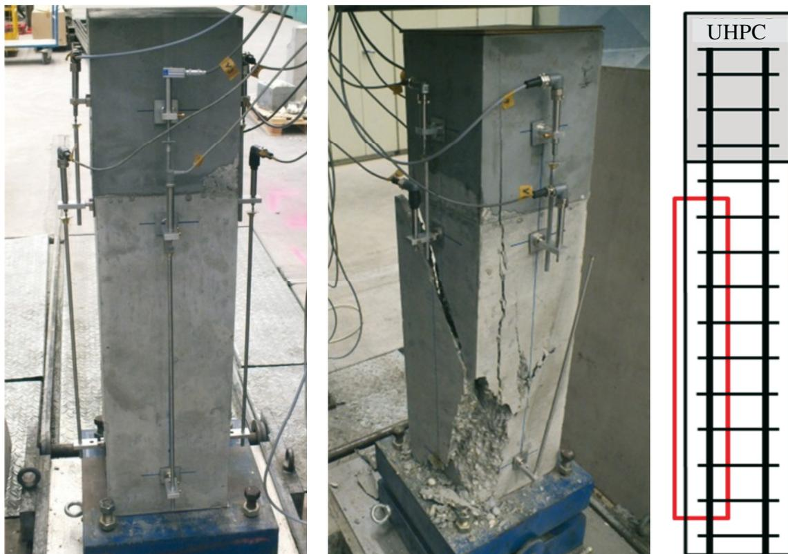
Abb. 6-17: Referenzstütze vor (links) und nach (mittig) der Prüfung, sowie eine schematische Darstellung (rechts)
