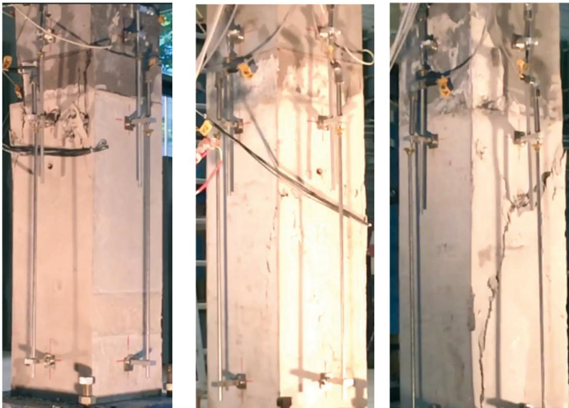
*Abb. 6-26: Bruchbilder der Versuchsserie 4 – Teil 2: V4.4 (links) bis V4.6 (rechts)*
