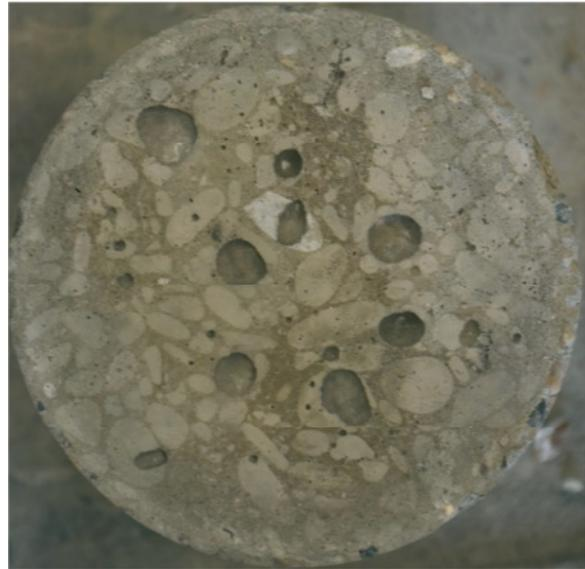
Abb. 6-33: Sichtprobe Normalbeton  $NB_{130}$  (links) und  $NB_{130} + \text{Rütteln}$  (rechts)
