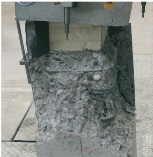
Abb. 6-29: Versuchskörper UHPC\_1 nach dem Bruch
