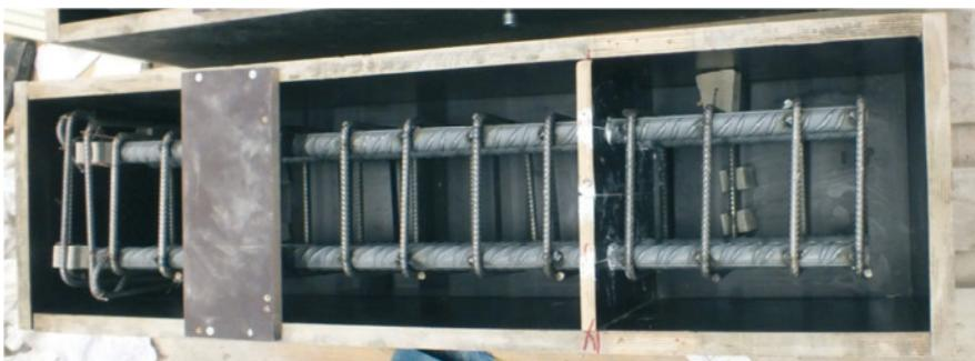
Abb. 6-15: Referenzstütze vor dem Betonieren
