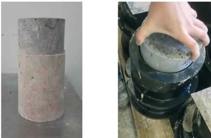
Abb. 6-32: Prüfkörper im fertigen Zustand (links) und während des Herstellungsprozesses (rechts)
