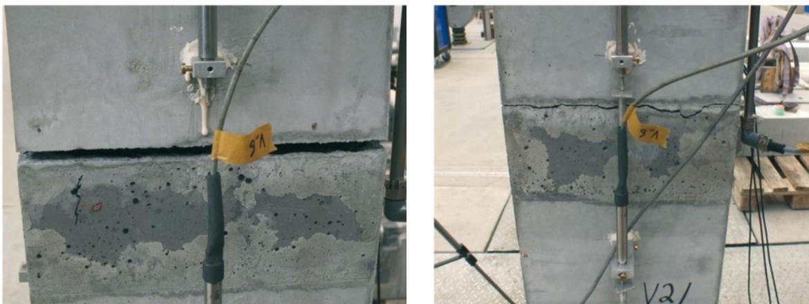
Abb. 6-11: Weniger gedrückte Seite nach dem Versagen (links V1.5 (ohne ComBar), rechts V1.3 (mit))
