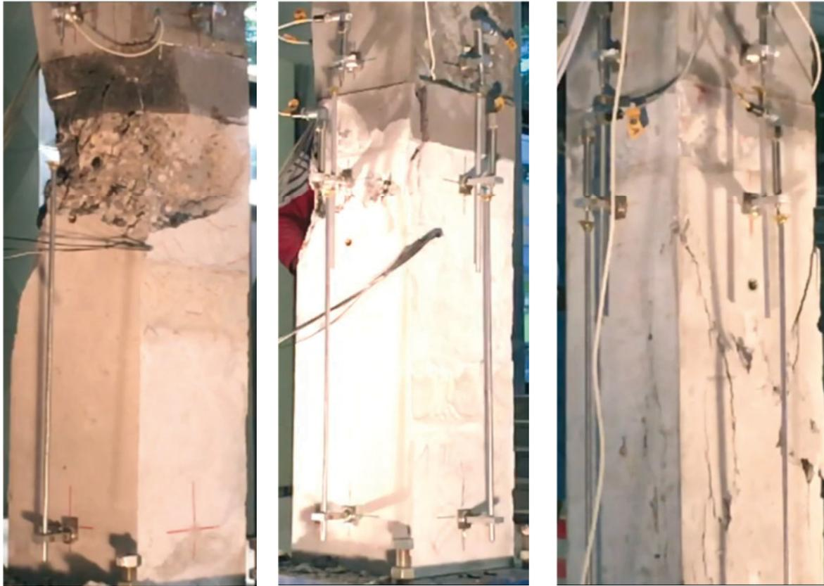
*Abb. 6-25: Bruchbilder der Versuchsserie 4 – Teil 1: V4.1 (links) bis V4.3 (rechts)*
