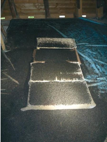
Abbildung 85. Massive Kotalage auf den Musterflächen zum Vergleich der Abdeckungen.
