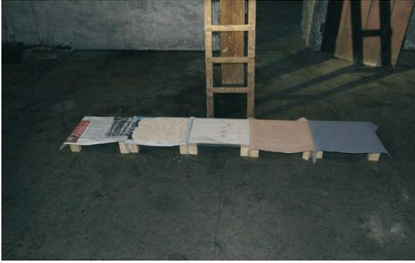
Abbildung 82. Musterflächen unterhalb des Hangplatzes – Bretter belegt mit den folgenden Materialien: Zeitung / Zeitung mit einer Auflage von Katzenstreu / Luftpolsterfolie / orange Unterspannbahn / graue Unterspannbahn (UDB210).
