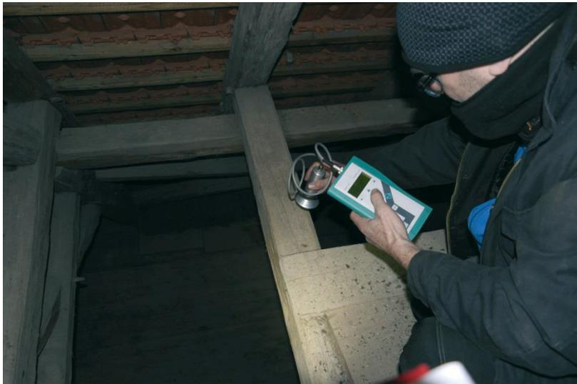
Abbildung 37. Messung der Holzfeuchte mit dem Mikrowellenverfahren.
