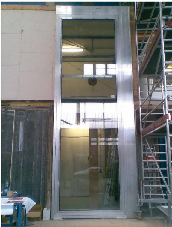
**Bild A 13** Beispiel für eine Elementfassade im Großformat (Bildquelle: ift-Vorgang 12-000232)
