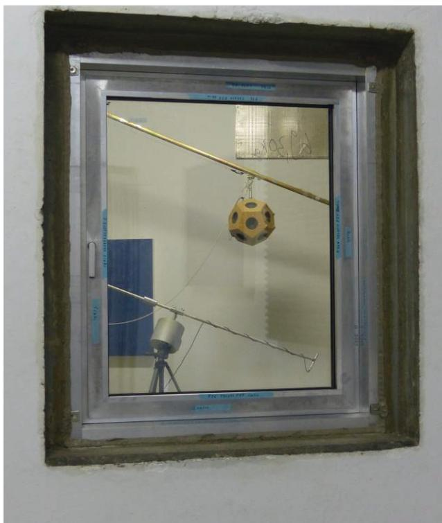
**Bild A 2** Beispiel für ein Einselelement in einem Fassadenrahmen im Normformat (Bildquelle; ift-Vorgang 15-000241)
