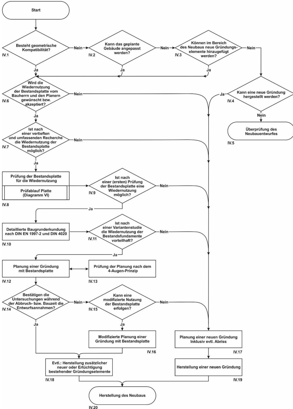
Diagramm IV Untersuchungsablauf Fundamentplatte.
