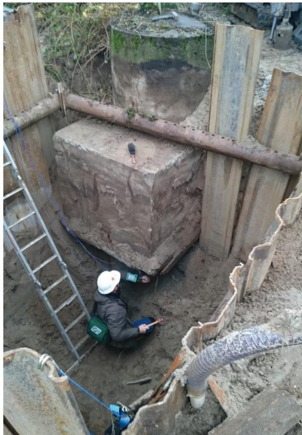
**Bild 30** Untersuchung mit der Low-Strain-Integritätsprüfung an Pfählen unter einem Mastfundament. Die notwendige Freilegung war in diesem Fall nur mit Wasserhaltung möglich. Details zu diesem Projekt siehe Anlage 4. Foto: BAM.
