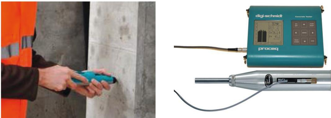
**Bild 5** Rückprallhammer. Links: Handgerät in der Anwendung. Rechts: Digitale Version mit Datenaufzeichnung und integrierter Kalibrierung. Bilder: [www.proceq.com](http://www.proceq.com).
