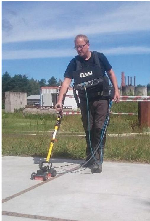
**Bild 29** Untersuchung einer Fundamentplatte mit dem Radarverfahren (REFUND-Testplatte, siehe Anhang 2) Quelle: Implenia/BAM.
