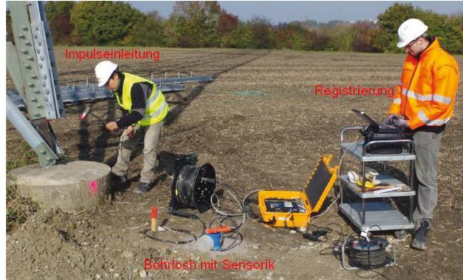
**Bild 24** Parallel-Seismik-Messungen an einem Mastfundament.
