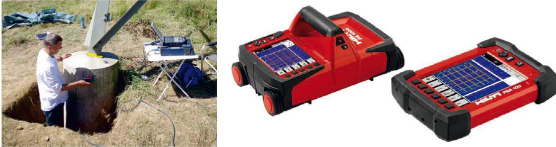
**Bild 8** Typische Messgeräte für das Radarverfahren. Links: Universelles Radargerät mit hochfrequenter Antenne (GSSI, USA). Rechts: Kompaktes Spezialgerät zur Bewehrungssuche und Spannkanallokalisierung bis 25 cm (Ferroskan PS 1000, Hilti/Liechtenstein). Bilder: [www.hilti.com](http://www.hilti.com).
