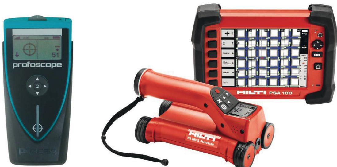
**Bild 6** Typische Messgeräte nach dem Wirbelstromprinzip zur Bewehrungssuche. Links: Handgerät (Profoscope, Proceq/Schweiz). Rechts: Gerät mit getrennten Sensor-/Auswerteeinheiten zur flächenhaften Datenaufnahme (Ferroskan PS 250, Hilti/Liechtenstein). Bilder: [www.proceq.com](http://www.proceq.com), [www.hilti.com](http://www.hilti.com)
