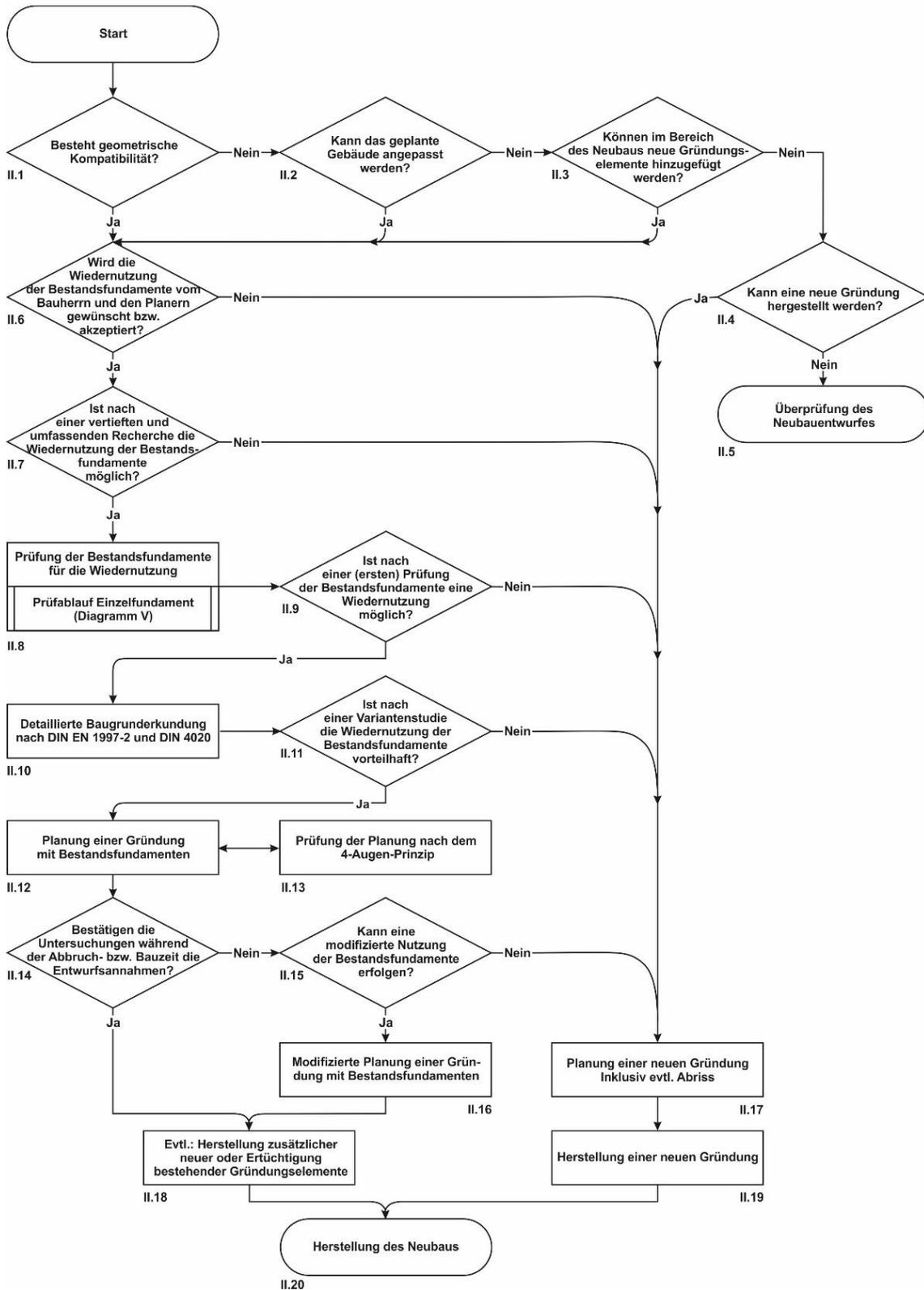
**Diagramm II** Untersuchungsablauf bestehender Einzel- bzw. Streifenfundamente.
