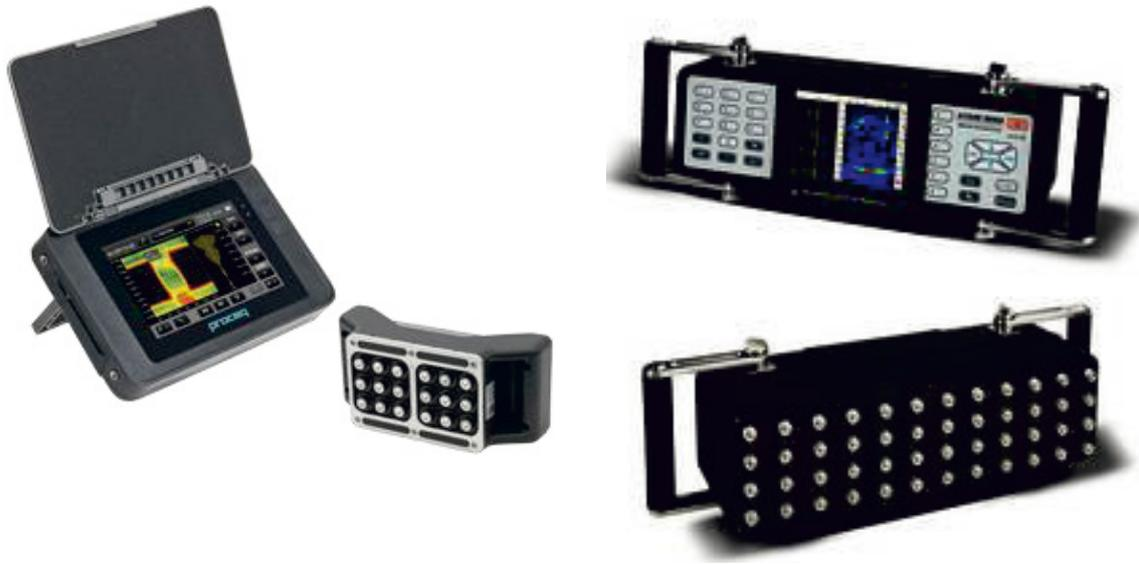
**Bild 10** Typische Messgeräte für das Ultraschallverfahren Links: Einkanaliges Gerät mit je einer 9-köpfigen Sende und Empfangseinheit in einem gemeinsamen Gehäuse mit separater Bedieneinheit (Pundit PL-200PE, Proceq/Schweiz). Rechts: Ultraschallarray mit 10 je 4-köpfigen, automatisch umschaltbaren Sende- und Empfangseinheiten und integrierter Auswertung. (A1040 Mira, ACS Ltd/Russland). Bilder: [www.proceq.com](http://www.proceq.com), [www.acsys.ru](http://www.acsys.ru).
