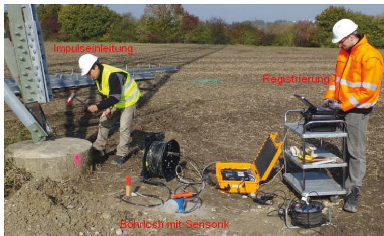
**Bild 47** Parallel-Seismik-Messungen an einem Mastfundament.
