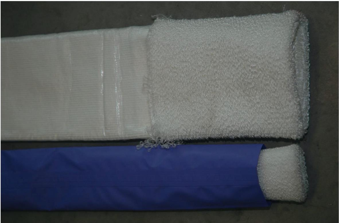
*Abb. 15 Liner in DN 100 und DN 50 sowie Kalibrierschlauch vor der Inversion (Veser 2015)*
