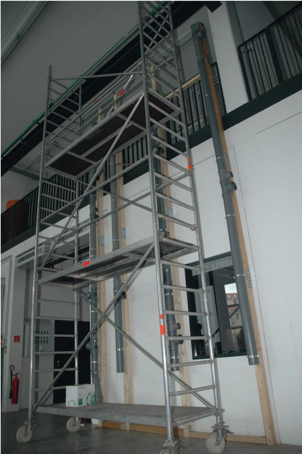
Abb. 14 Aufbau der Teststrecke über zwei Etagen (Veser 2015)
