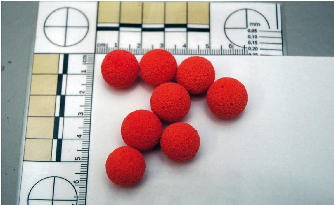
*Abb. 33 Putzkörper zur Reinigung von Kühlsystemen der Fa. Taprogge, Vesper (2015)*
