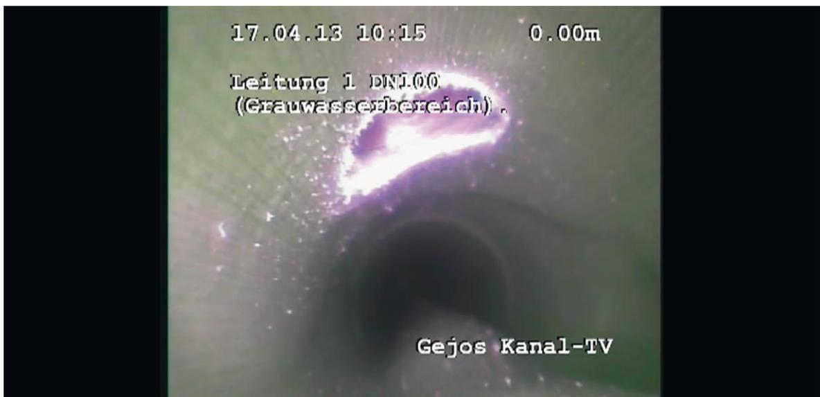
Abb. 23 Rohrleitungsinspektion des GW-Liners mit-Kamera, Ausfräsung der Anschlussstelle Gejos PIC5.5 Peli (Veser 2015)
