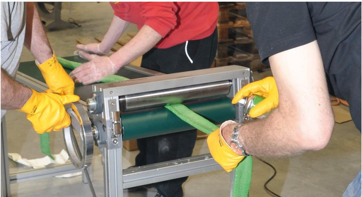
*Abb. 18 Befüllen des DN50 Liners mit Epoxidharz (Veser 2015)*
