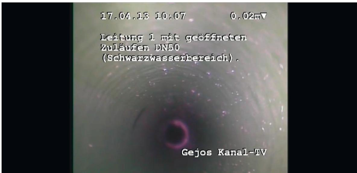
Abb. 19 Rohrleitungsinspektion des SW-Liners an Teststrecke 1 mit-deutlich erkennbarem kreisrunden Querschnitt, aufgenommen mit Kamera Gejos PIC5.5 Peli (Veser 2015)
