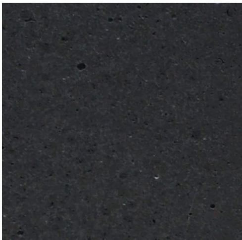
Bild 170: Oberfläche mit Leinöl [66]
