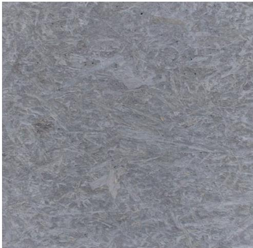
Bild 163: Ergebnis der OSB-Schalung [66]
