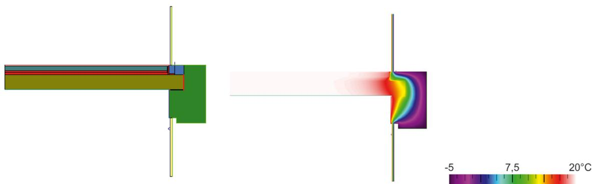
Bild 182: Oberer und untere Fensteranschluss mit Zwischendecke für eine 50cm dicke ILC-Wand
