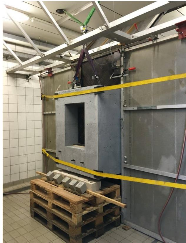
Bild 129 (rechts): Prototyp 2 im Schlagregenstand (von hinten)
