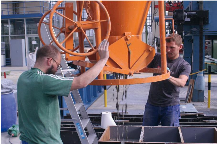
*Bild 176: Befüllen der Probekörper von [65] mit einem Betonkübel*
