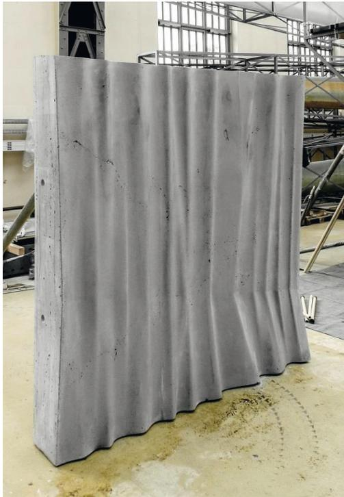
Bild 180: Prototyp 4 – Fassadenelement aus Infralichtbeton
