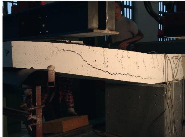
Bild 148: Abbruch des Versuches, Querkraftversagen
