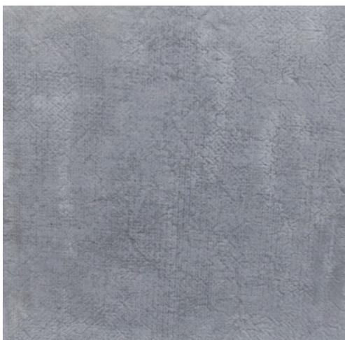
Bild 165: Ergebnis der Schalung mit Filtervlies [66]
