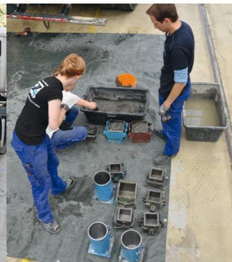
Bild 114: Betonieren von Prüfkörpern
