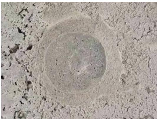
Bild 174: In den Probekörper eingesetzter Betonstopfen mit Spachtelmasse [67]
