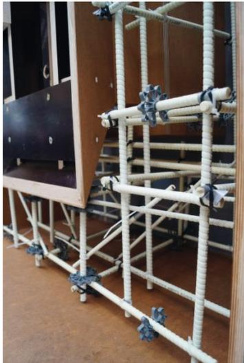
Bild 118: Bewehrung Prototyp 2
