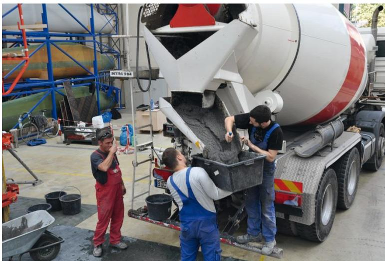
Bild 113: Frischbetonprüfung nach Ankunft
