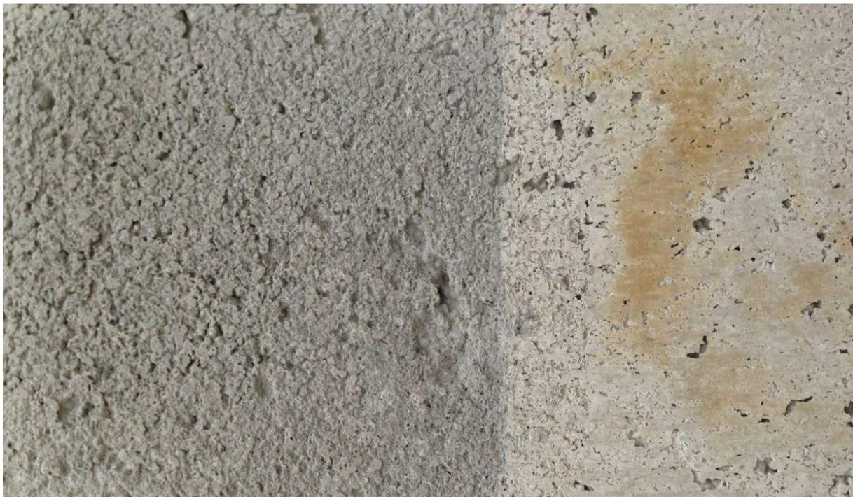
*Bild 172: Abgesäuerte (links) und unbearbeitete Oberfläche (rechts) [67]*
