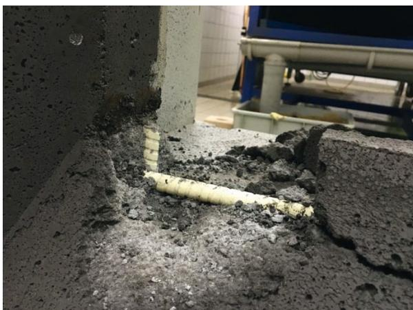
Bild 132: Eindringtiefe im Bereich des Fensterbrettes – dunkle Flächen sind durchfeuchtet
