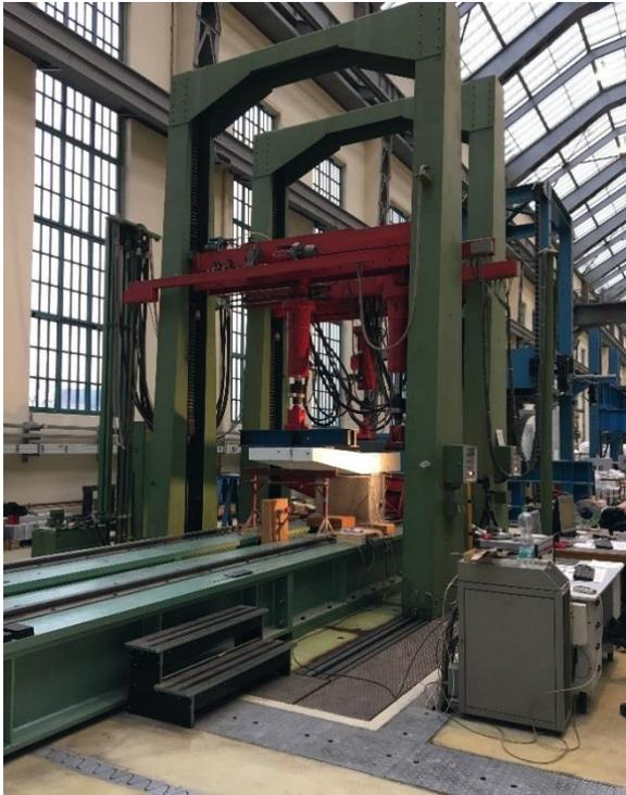
Bild 142 (oben): Plattenbiegemaschine mit verschiebbaren Prüfportalen
