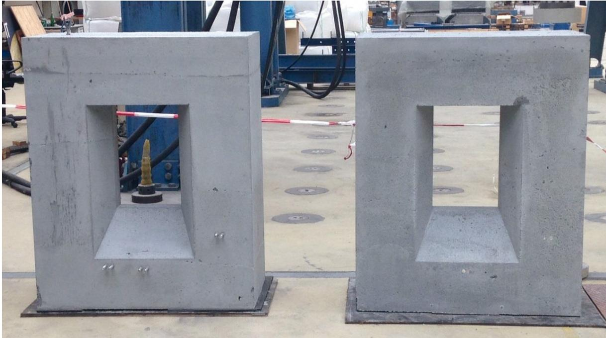
Bild 157: links: PT2-1 aus ILC 800 ohne Einfüllhilfe; rechts: PT2-2 aus ILC 600 mit Einfüllhilfe
