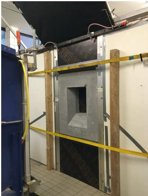
Bild 128 (oben): Prototyp 2 im Schlagregenstand
