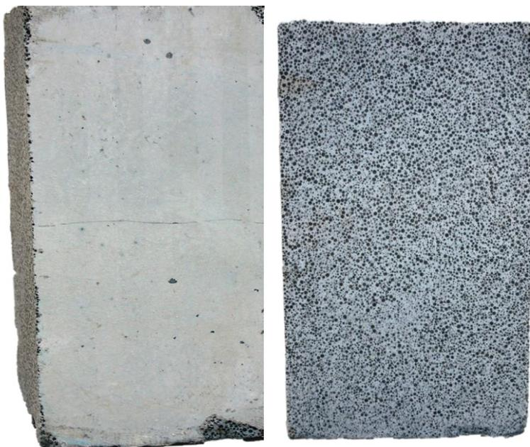
Bild 175: links: Betonierhorizont mit Außenrüttler vermieden (Horizont mit Bleistift markiert); recht: aufgeschnittener Probekörper [65]
