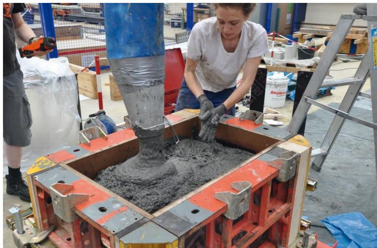
Bild 141: Herstellung des 2. Wandstummels aus Transportbeton inkl. Temperaturfühler (schwarzes Kabel)
