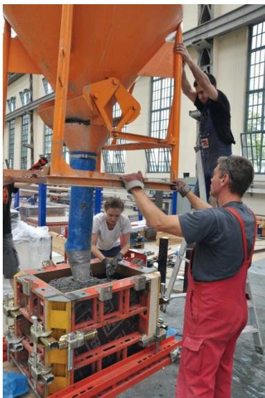
Bild 140: Herstellung des 2. Wandstummels aus Transportbeton
