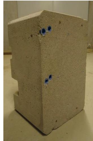
Bild 6: Prinzip der gesteuerten Porosität im Infraleichtbeton; Probekörper mit Kapillarrohrmatten für Wandaktivierung
