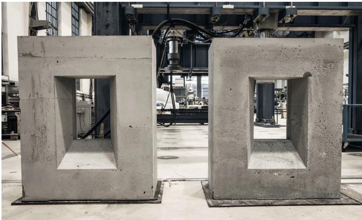
*Bild 179: Prototyp 2 in ILC 800 (links) und ILC 600 (rechts)*
