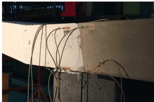
Bild 144: Messfühler zur Messung von Spannungen auf der Bauteiloberfläche
