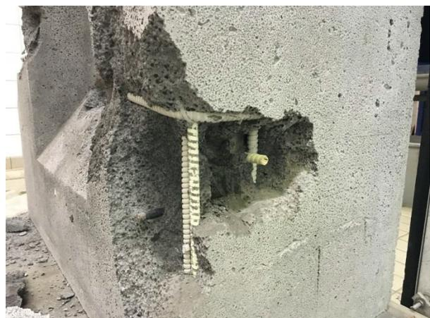
Bild 133: Situation nach 1 Tag, Oberfläche abgetrocknet, Feuchte im Inneren des Bauteiles
