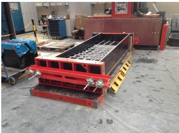
Bild 138: Liegende Schalung für 2. Variante
