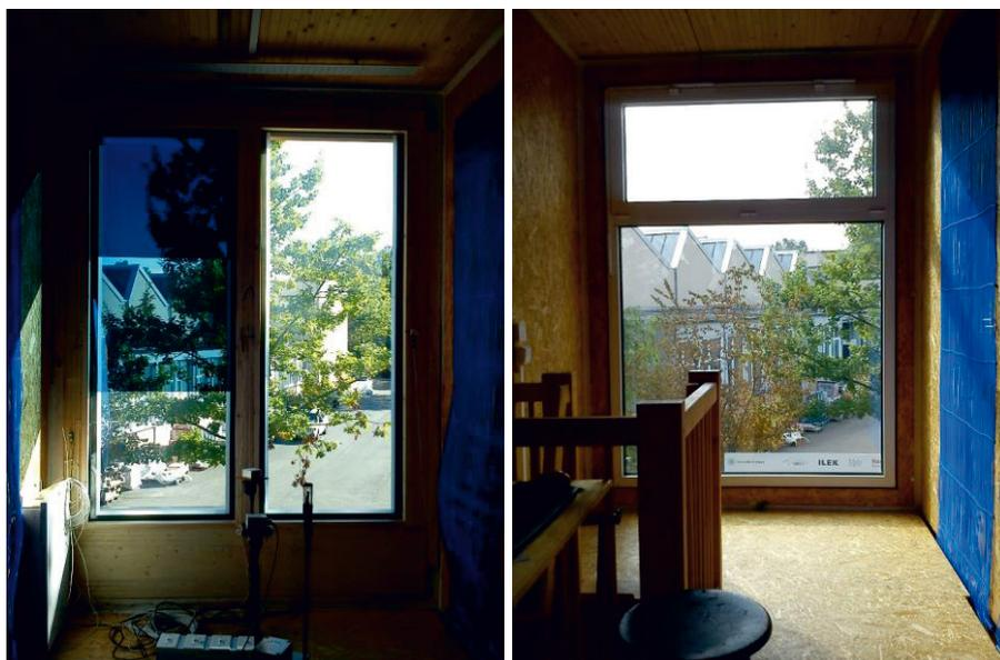
Abbildung 8-26: Testaufbau im Fassadenprüfstand. Links: Testraum 1.1. mit SageGlass® während des Abdunklungsvorgangs, rechts: Referenzraum mit Referenzverglasung 2 an einem sonnigen Herbsttag 29.09.2016
