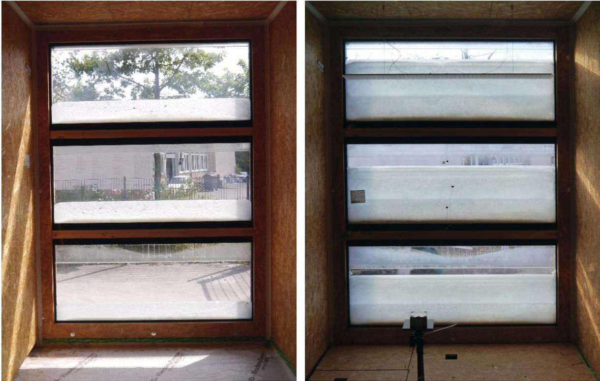
Abbildung 2-7: GLASSX®crystal eingebaut im ILEK-Fassadenprüfstand, links: Zustand an einem heißen Sommertag (13.08.2015), rechts: Zustand an einem kalten Wintertag (12.02.2016)
