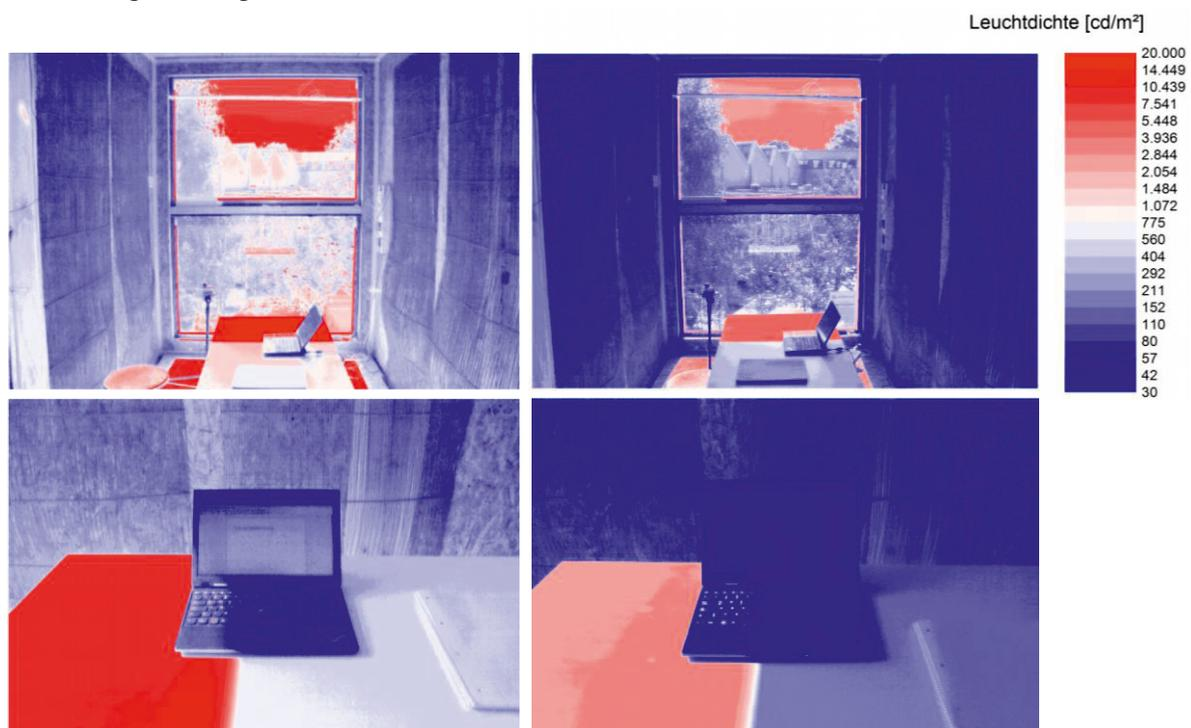
Abbildung 8-15: Messungen der Leuchtdichteverteilung (Fassadenprüfstand, Stuttgart, sonniger Sommertag, 13:30 Uhr, Außenbeleuchtungsstärke ca. 90 klx). Oben: Aufnahmen mit Blickrichtung nach Süden, unten: Aufnahmen mit Blickrichtung nach Westen. Links: Abdunklungsstufe 0, rechts: Abdunklungsstufe 4 der ECONTROL®-Verglasung.
