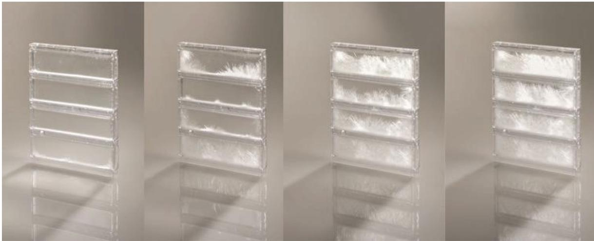
Abbildung 2-5: Kristallisationsprozess innerhalb eines GLASSX®-Verglasungsaufbaus [19]
