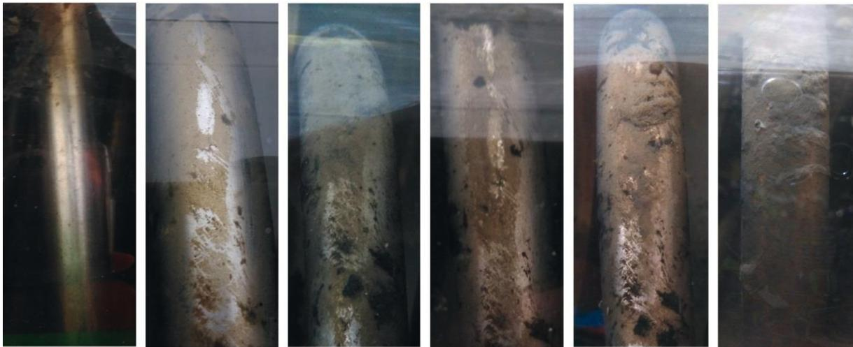
**Abbildung 36:** Verschmutzung des Edelstahlwärmeübertragers
