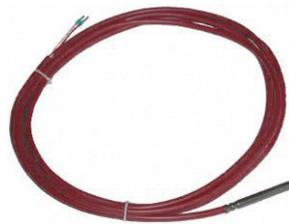
**Abbildung 21:** PT1000 Platinwiderstandstemperatursensoren
