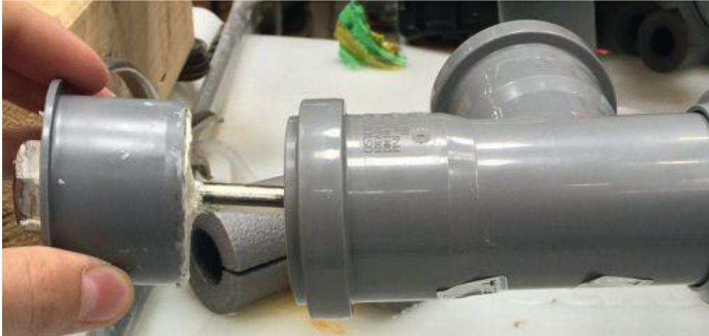
**Abbildung 26:** Einbringung der Temperaturfühler im Abwasserstrom
