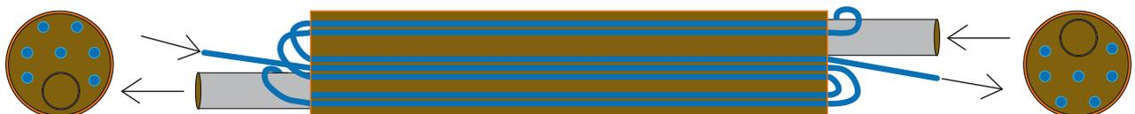
**Abbildung 15** : Bau des 1,7-PTFE-Rohrbündel-Wärmeübertragers
