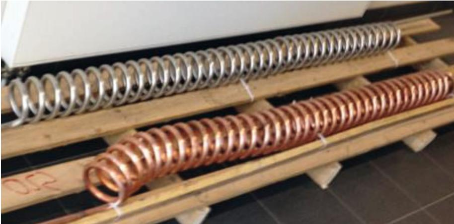
**Abbildung 14:** Verwendete Wärmeübertrager in Kupfer und Edelstahl
