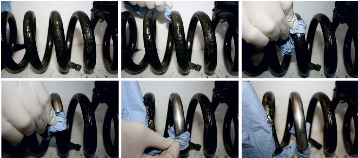
**Abbildung 56** : Mechanische Reinigung des Edelstahl-Rohrwendel-Wärmeübertragers
