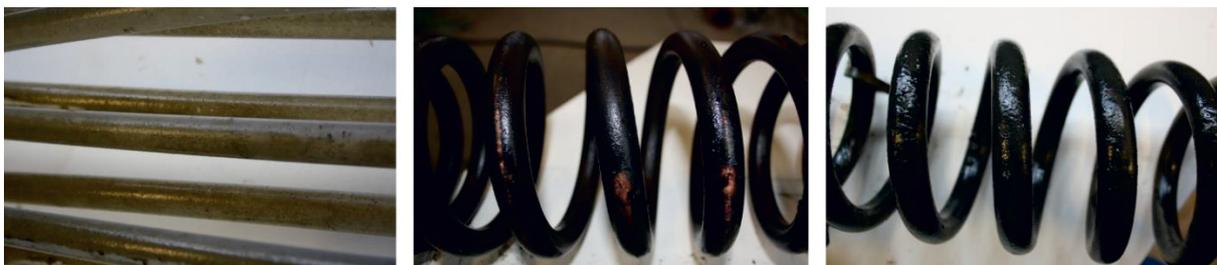
**Abbildung 55** : Foto der Wärmeübertrager PTFE, Kupfer und Edelstahl nach dem Ausbau
