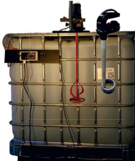
**Abbildung 18 :** IBC mit schematischer Darstellung der Anordnung von Quirl und Heizstab
