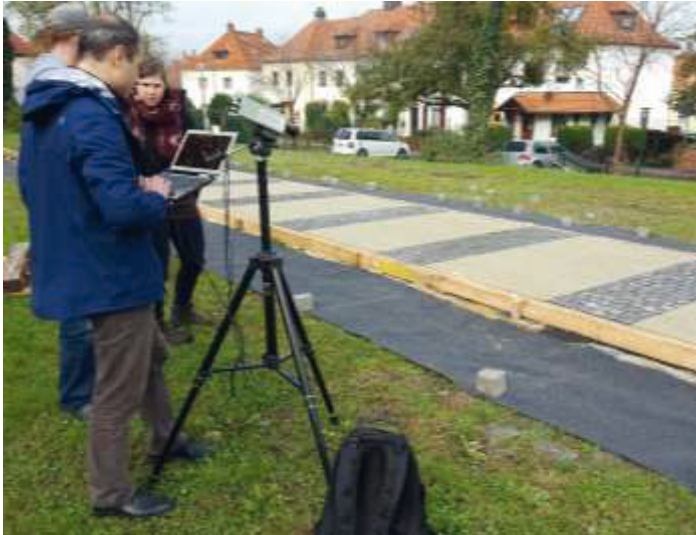
Abbildung 177. Messung der Leuchtdichtekontraste im Außenraum
