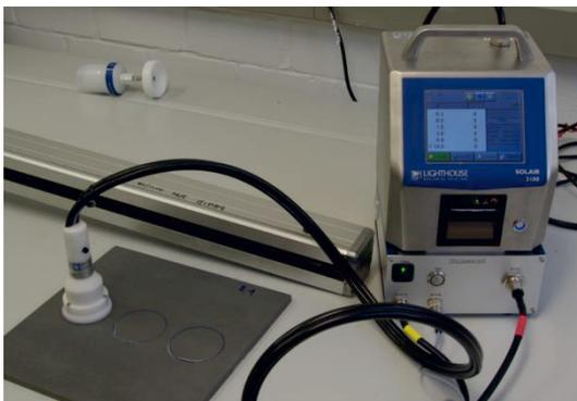
**Abbildung 49:** Messvorgang mit der Oberflächensonde und dem Partikelzählgerät
