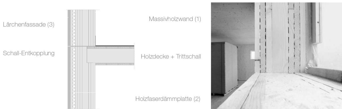
Abbildung 9: Wandaufbau Massivholzwand [32].
