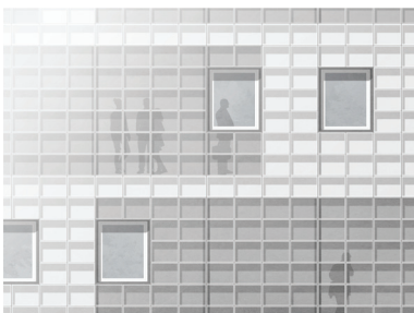
Abb. 212: Organische Photovoltaik auf transparentem Trägermaterial und Antiflex-Deckglas vor festverglasten und opaken Fassadenbereichen Quelle: Eigene Darstellung
