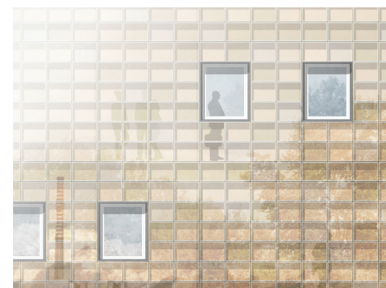
Abb. 205: Transluzente organische Photovoltaik farbig vor Festverglasungen Quelle: Eigene Darstellung
