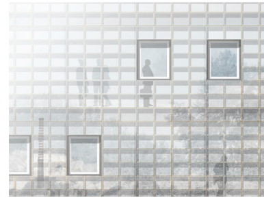
Abb. 204: Transparente organische Photovoltaik vor Festverglasung mit sichtbarem konstruktiven Rost aus Funierschichtholz Quelle: Eigene Darstellung
