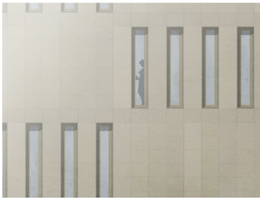
Abb. 214: Kombination schmaler, hochformatiger Fensterelemente mit kleinteiliger, opaker und farbiger Dünnschicht- Photovoltaik Quelle: Eigene Darstellung
