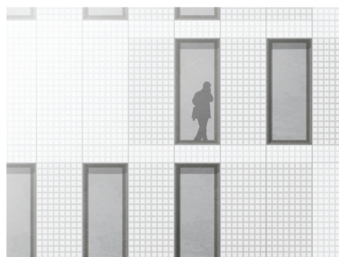
Abb. 222: Monokristalline Wafern in weiß auf großformatigem opaken bzw. transparentem Trägermaterial kombiniert mit hochformatigen Fensterelementen Quelle: Eigene Darstellung
