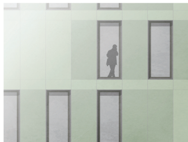
Abb. 221: Großformatige, geschosshohe Fensterelemente kombiniert mit großformatigen Dünnschicht- Photovoltaik-Paneeellen als opake Flächen Quelle: Eigene Darstellung
