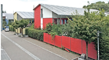
Abb. 4: Beispiel eines Plusenergiegebäudes mit geneigtem Solardach und einer nord- Süd-Ausrichtung im Stadtteil Vauban, Freiburg Foto: Steffen Wurzbacher
