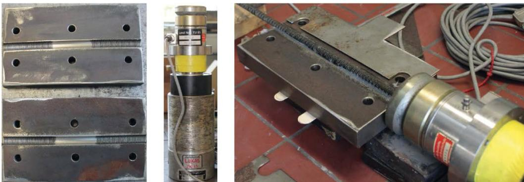
Bild 6-1: Stahlplatten (links), Hohlkolbenzylinder, Kraftmessdose und Kalotte (Mitte) und Vorbereitung der Versuchskörper (rechts)
