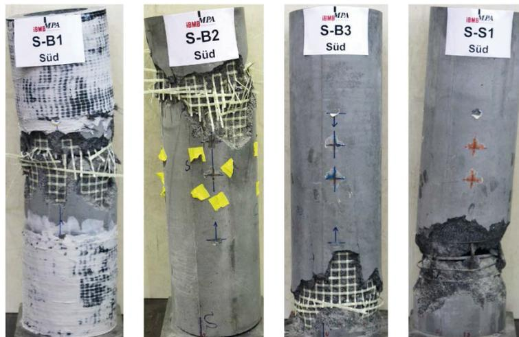
Bild 5-15: Versagensbilder der Versuchskörper
