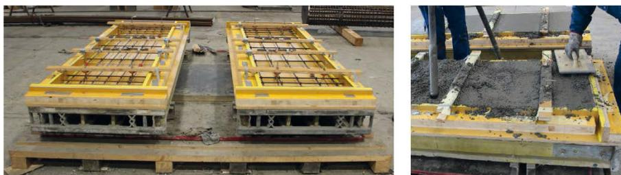
Bild 5-33: Herstellung der Versuchskörper: Schalung (links) und Betonage (rechts)
