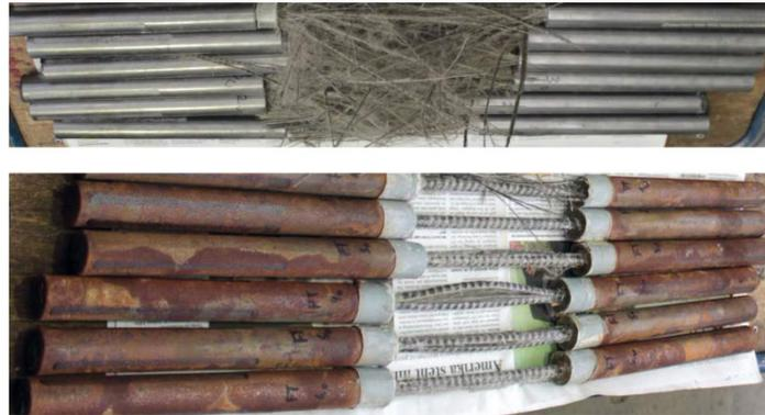
Bild 4-22: Typische Versagensart der BFRP-Rebars ohne (oben) und mit Frost-Tausalz-Beanspruchung (rechts) in den Zugversuchen
