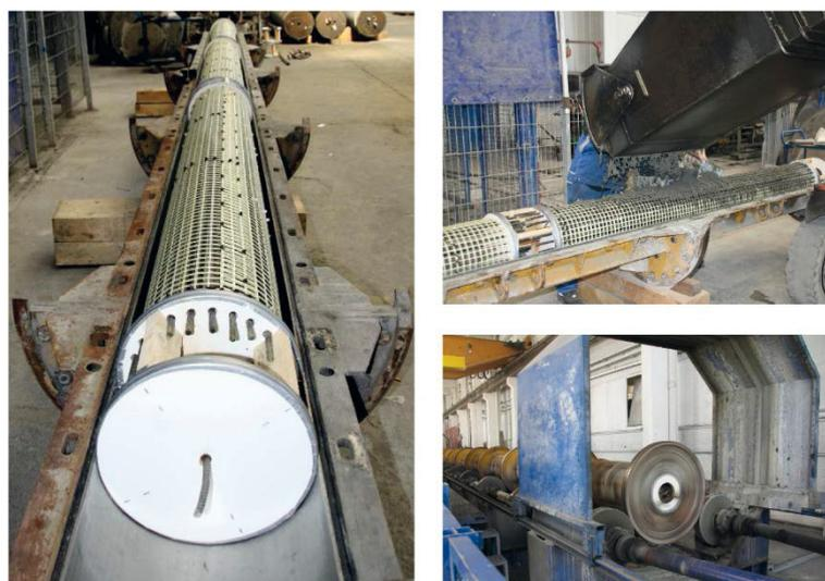
Bild 5-40: Herstellung der Versuchskörper: Schalung und Bewehrungskorb (links), Betonage (rechts-oben) und Schleudervorgang (rechts-unten)
