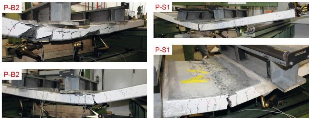
Bild 5-35: Versagensbilder der Versuchskörper P-B2 (links) und P-S1 (rechts)
