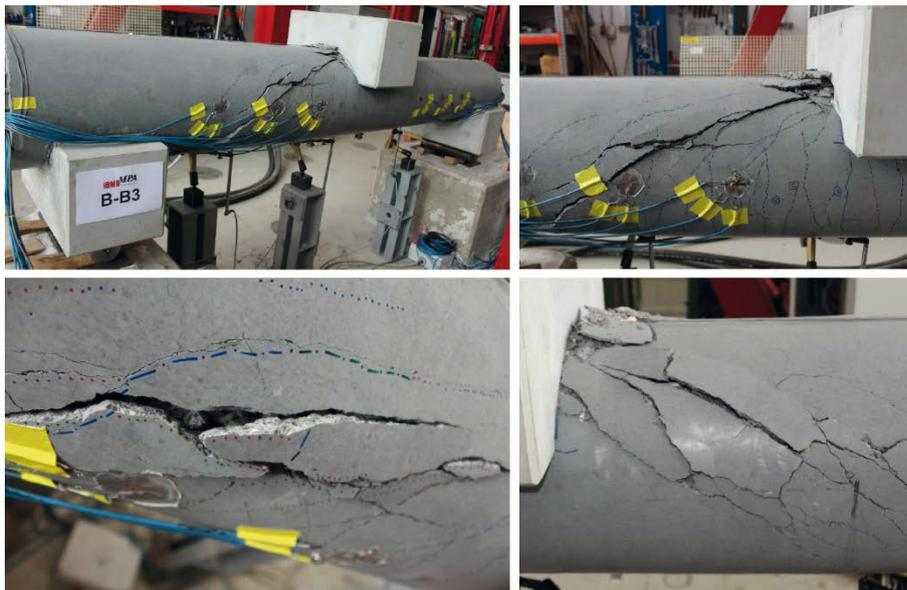
Bild 5-44: Versagensbilder des Versuchskörpers B-B3
