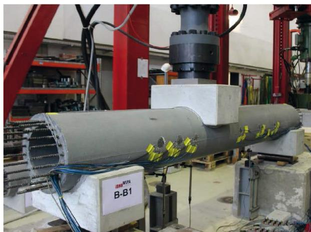
Bild 5-42: Versuchsaufbau der Versuchskörper (hier: B-B1)
