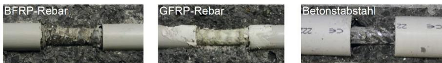
Bild 5-4: Abscheren der Rippen eines BFRP-Rebars (links), GFRP-Rebars (Mitte) und Betonstabstahls (rechts)
