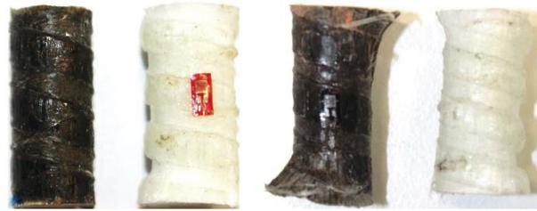
Bild 4-7: BFRP- und GFRP Rebars mit DMS Applikation (links und Mitte-links) und typische Versagensart der BFRP- und der GFRP-Rebars nach den Druckversuchen (rechts und Mitte-rechts)
