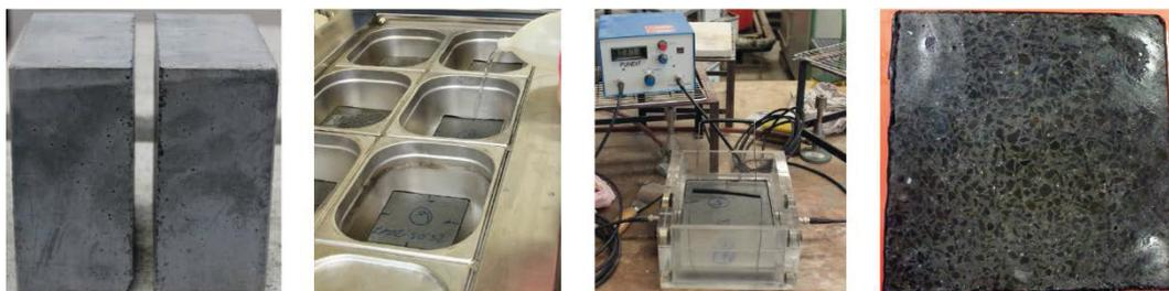
Bild 4-34: Betonwürfel durchgesägt (links), CDF-Test (Mitte-links), CIF-Test (Mitte-rechts) und Versuchskörper nach CDF-/CIF-Test (rechts)
