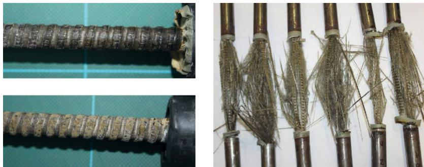
Bild 4-19: BFRP-Rebar vor (links-oben) und nach 105-tägiger Bewitterung (links-unten) und typische Versagensart der BFRP-Rebars in den Zugversuchen (rechts)
