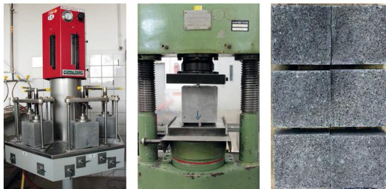
Bild 4-32: WU-Prüfung der Versuchskörper (links), Spaltung der Versuchskörper (Mitte) und Versuchskörper nach der Spaltung (rechts)
