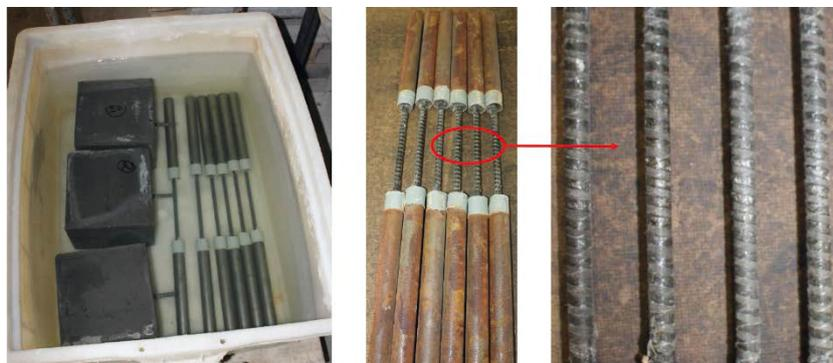
Bild 4-21: BFRP-Rebars im Wasserbehälter (links), nach der Frost-Tausalz-Beanspruchung (Mitte) und Detail-Ansicht der BFRP-Rebars (rechts)
