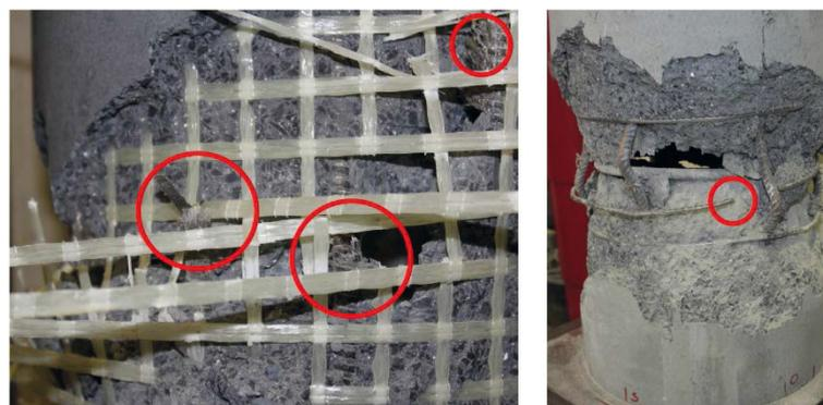
Bild 5-16: Versagen der Längs- und Bügelbewehrung: S-B2 (links) und S-S1 (rechts)
