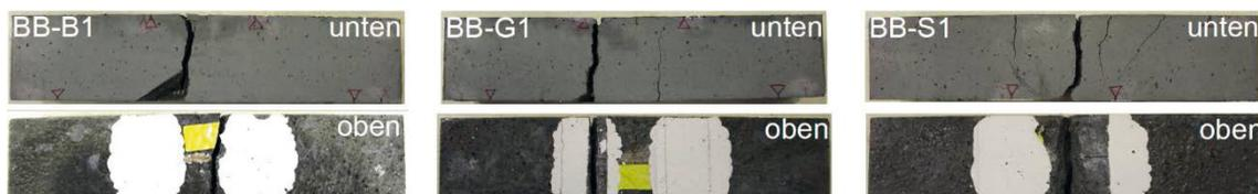
Bild 5-20: Rissbilder der Versuchskörper
