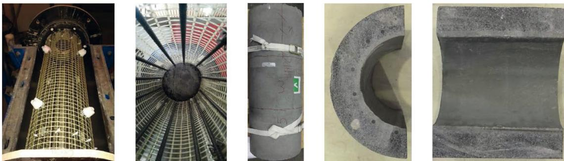
Bild 5-10: Bewehrungskorb (links und Mitte-links), Schleuderbetonbauteil (Mitte) und zerlegtes Schleuderbetonbauteil (rechts und Mitte-rechts)
