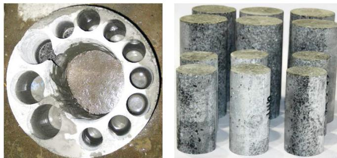
Bild 4-31: Bohrkernentnahme aus Schleuderbetonrohr
