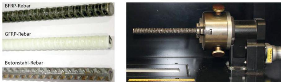
Bild 4-3: FRP-Rebars und Betonstahl (links) und Rippenflächemessung eines BFRP-Rebars (rechts)
