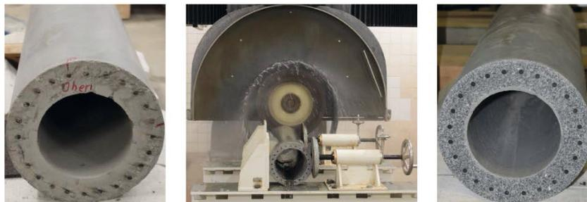
Bild 5-13: Versuchskörper vor dem Schleifen (links), in der Schneid-Schleif-Kombi-Maschine (Mitte) und nach dem Schleifen (rechts)
