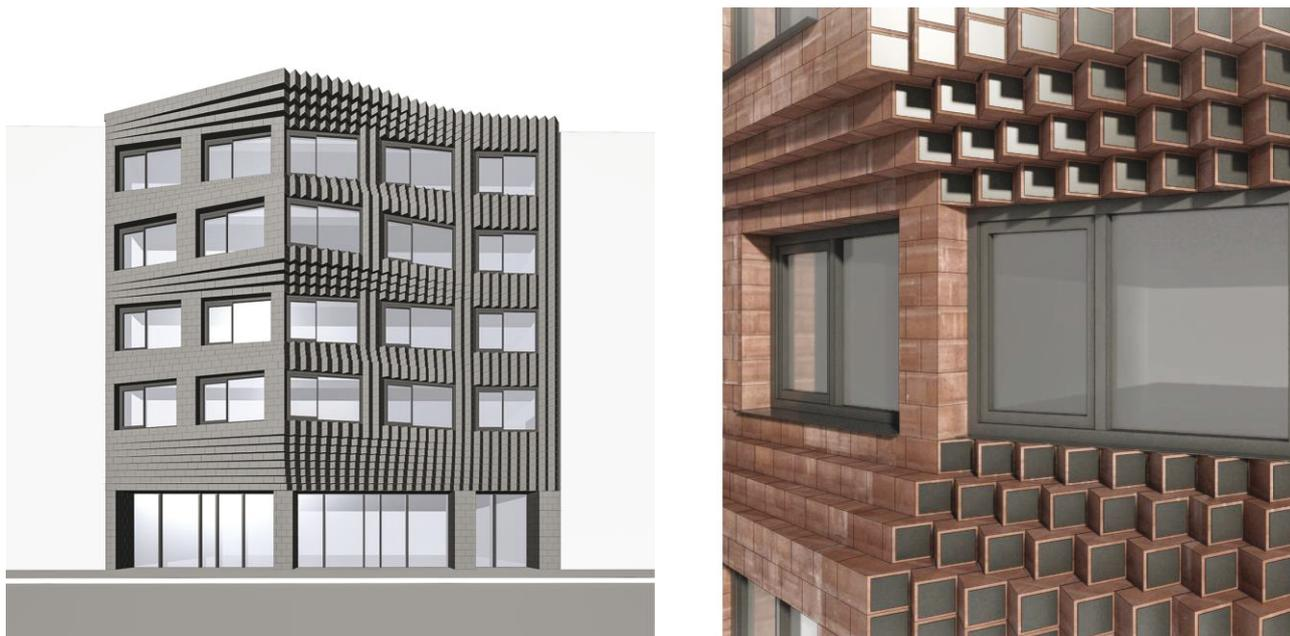
Abb. 55: Ziegelfassade mit integrierten PV-Zellen, Ansicht & Close-Up | CGI: A. Heller, ai:L
