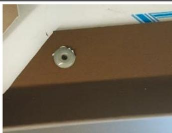
Der Überstand einer Niete über dem Blech beträgt ca. 2 mm. Diese Höhe wurde bei der Berechnung der Rahmentiefe für das PV-Modul zunächst jedoch nicht mit berücksichtigt. In der Folge wurde der Schenkel der Einbuchtung deshalb ein wenig tiefer ausgebildet.
