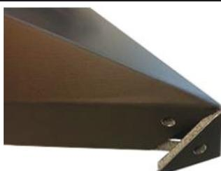
Die rechte Ecke des Elementes hat das gleiche Problem wie die linke. Der Winkel verläuft so spitz, dass an den Schenkeln eine rückseitige Anbringung einer Verbindungsplatte nicht möglich ist, da der vorhandene Platz durch die Materialdicke der Aluminiumverbundplatte ausgefüllt ist. Die Schenkel wurden deshalb an der Spitze erneut auf Gehrung geschnitten.
