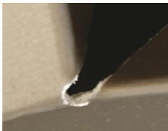
Beim Ausschneiden der Eckkante wurde zu viel Material entfernt. In der Zeichnung für den finalen Demonstrator wurde der Eckschnitt deshalb kürzer ausgeführt.
