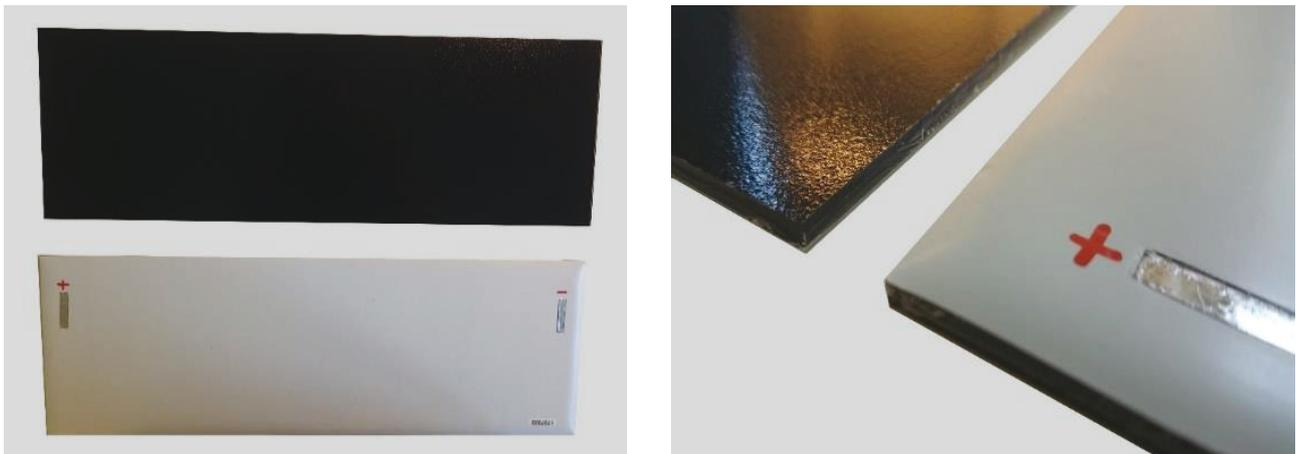
Abb. 89: PV-Modul Typ 2, Vorder- & Rückseite | Schrägansicht: Modulaufbau mit Kontaktstreifen
