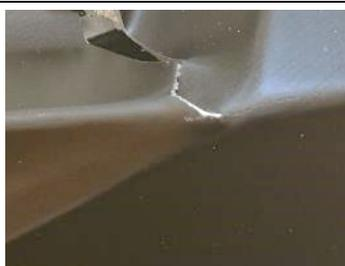
Da der Eckschnitt nicht weit genug ausgeführt wurde, riss das Material bei der Faltung ein. Entsprechend wurde der Schnitt später einfach ein wenig weitergeführt (jedoch nicht zu weit, sonst entsteht Problem Nr. 3).
