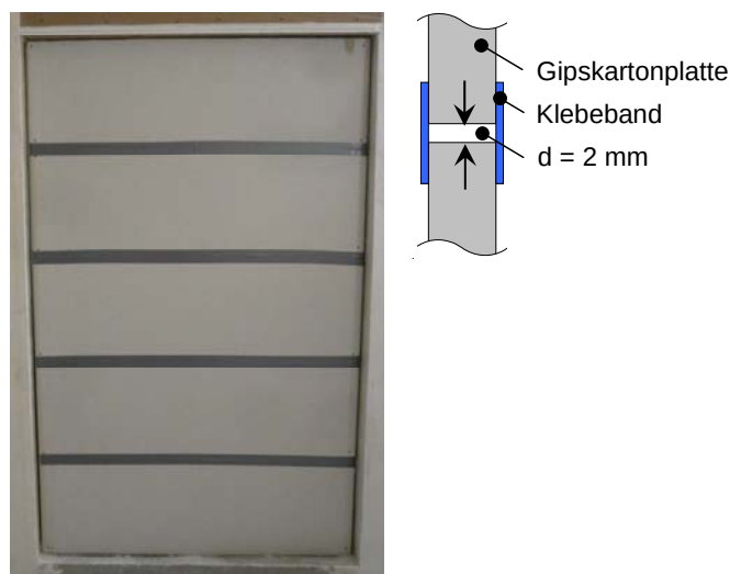
Abb. 19: Beispiel für die Elementierung einer Gipskartonplatte mit den Maßen B \times H = 125 \text{ cm} \times 200 \text{ cm} in fünf Streifen mit einer Höhe von jeweils 40 cm. Die Fugen zwischen den Streifen wurden mit Klebeband beidseitig schalldicht verschlossen (rechts im Bild).
