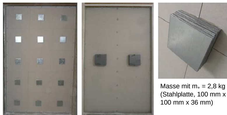
Abb. 50: Beschwerungen mit einer Gesamtmasse von etwa 17 kg/m 2 . Die Massen waren auf einem Gitter mit einem Rastermaß von 40 cm angeordnet (links) oder an zwei Stellen der Plattenoberfläche konzentriert (rechts). Die zugehörigen Messergebnisse sind in Abb. 51 dargestellt.
