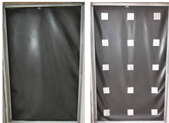
Abb. 67: Folie mit und ohne Beschwerung in der Einbauöffnung des bauakustischen Prüfstands.
