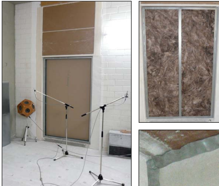
Abb. 13: Fotos der Einbausituation im Prüfstand. Die Prüföffnung befand sich zwischen den Räumen P9a (Senderraum) und P10a (Empfangsraum) im bauakustischen Kombi-Prüfstand des IBP.
