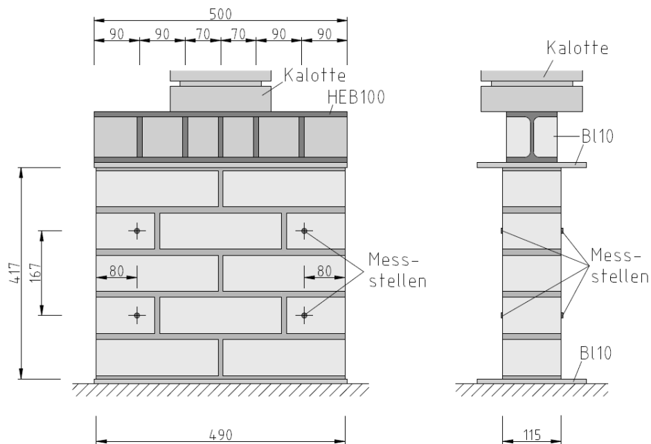
Abbildung 25: Versuchsaufbau zur Bestimmung des Elastizitätsmoduls des Mauerwerks (Maße in mm)
