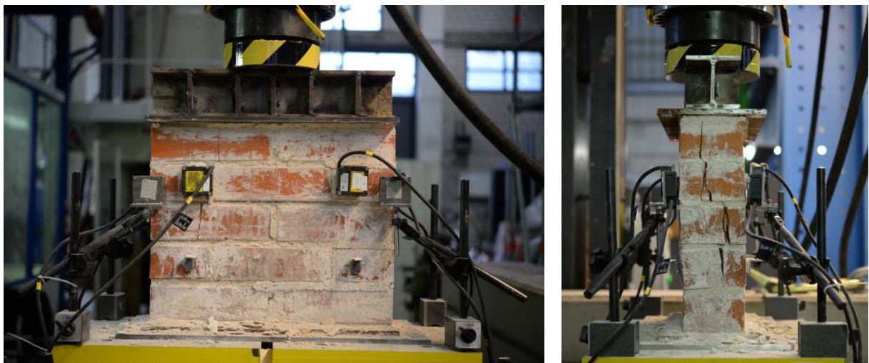
Abbildung 26: Bruchbild einer zentrisch belasteten Mauerwerksprobe im Rahmen der Bestimmung des Elastizitätsmoduls
