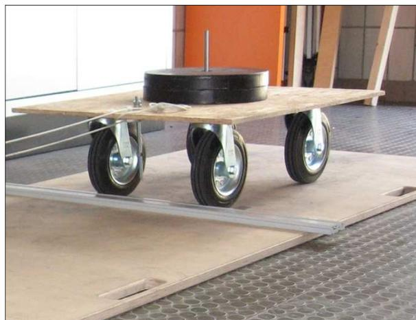
**Abbildung 32** Realisierter Rollwagen zum Versuch zur Überrollbarkeit von Schwellen. Zusatzgewicht 40 kg in Plattenmitte fixiert. Position auf der Bewegungsfläche vor der eingebauten Schwelle.
