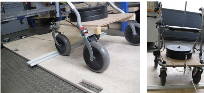
**Abbildung 33** Rollatorwagen aus einem umgebauten Standard-Rollator. Vollgummi-Rollen mit 190 mm Durchmesser.
