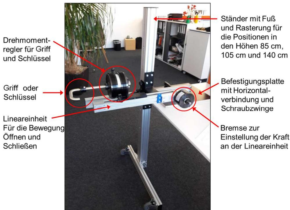
**Abbildung 3** Entwickelter Bedienkraftsimulator zur Messung der möglichen Bedienkräfte von Nutzern
