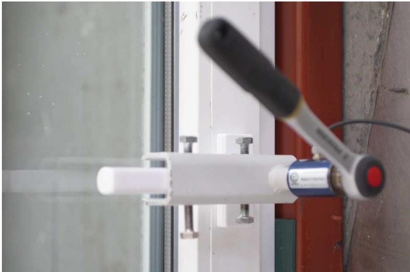
**Abbildung 8** Messung des Drehmomentes an einem Fenstergriff. Am Griff ist eine Manschette angebracht, dabei liegt die Aufnahme für das Drehmomentmessgerät in der Drehachse des Griffs. Das Drehmomentmessgerät ist mit einem Aufzeichnungsgerät verbunden.
