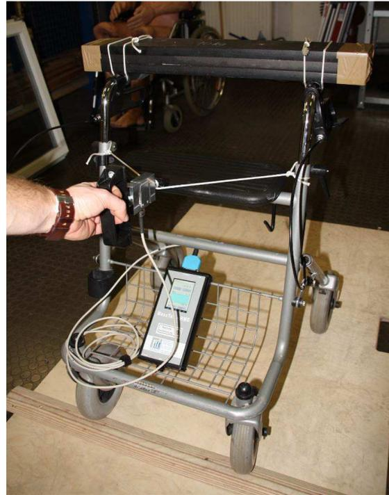
**Abbildung 30** Prüfmittel für Überrollversuche an Schwellen
