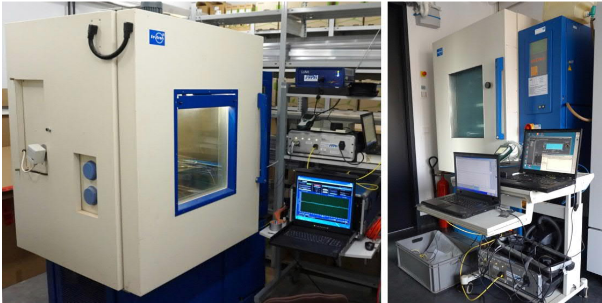
Abbildung 10: Versuchsaufbauten für Klimalagerung und Temperaturwechselbelastung
