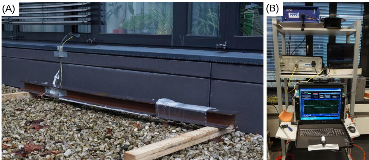
Abbildung 11: (A) Feldversuch an einem CFK-verstärkten Stahlträger mit in der Klebfuge integrierten Sensoren und (B) eingesetzte faseroptische Messtechnik
