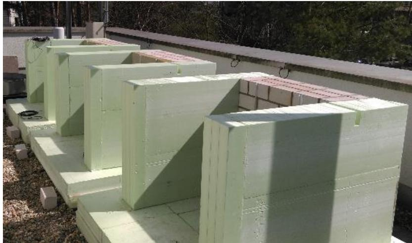
Abbildung 62: Testwände mit Styrodur-Seitenwänden
