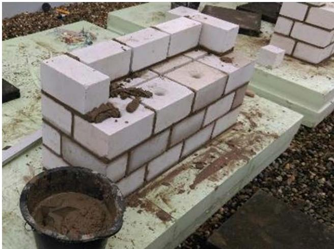
Abbildung 60: Aufbau der Testwände (Kalksandsteinmauerwerk)
