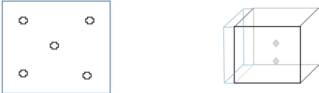
Abbildung 59: a) Ansicht Wand, Lage Messpunkte in den Bauteilschichten; b) Lage Innentemperaturfühler (blau: Mauerwerk)
