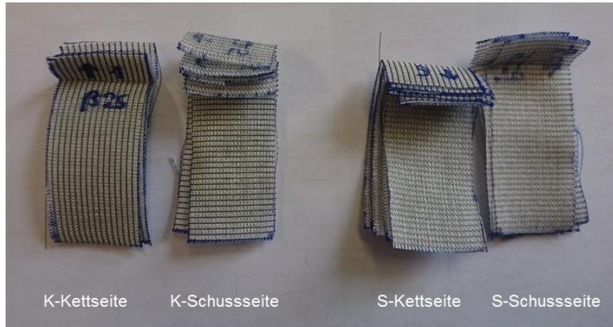
Abbildung 59: Gefaltete Proben, Knitterbankverfahren
