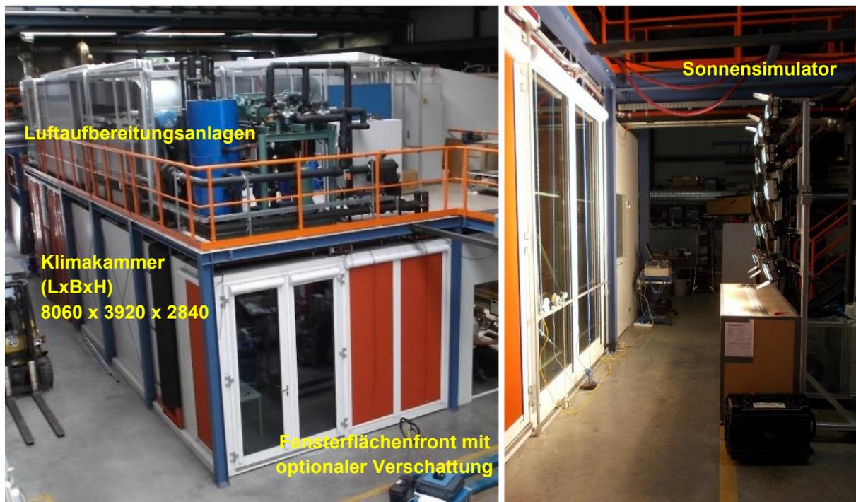
Abbildung 22: Raumströmungslabor (links) und Sonnensimulator (rechts) im Versuchsfeld des ILK Dresden
