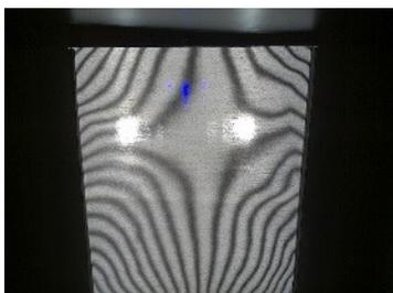
Abbildung 91: Durchsicht „Ettlin  $\beta 35$ “ mit Beschichtung und mit Bestrahlung von 1.000 W/m<sup>2</sup>
