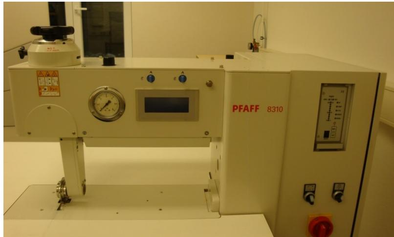
Abbildung 83: Ultraschall-Schweißmaschine, Pfaff 8310
