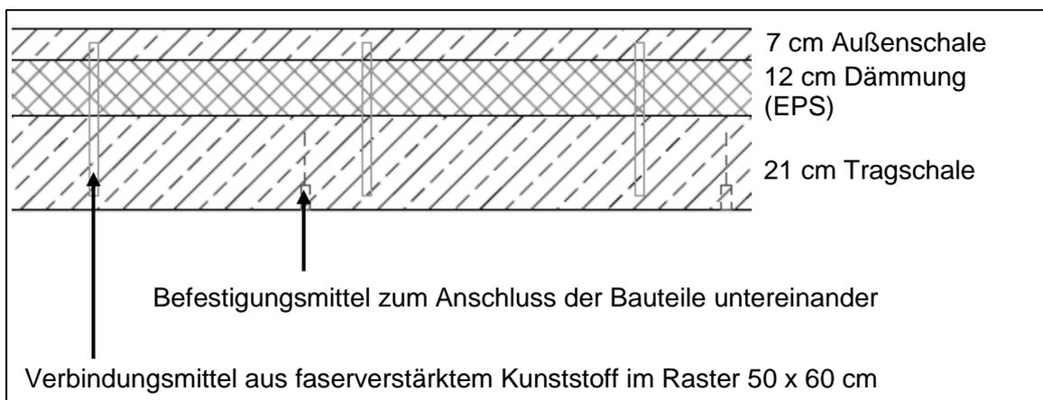
Abbildung 26: Schichtaufbau der Dachelemente
