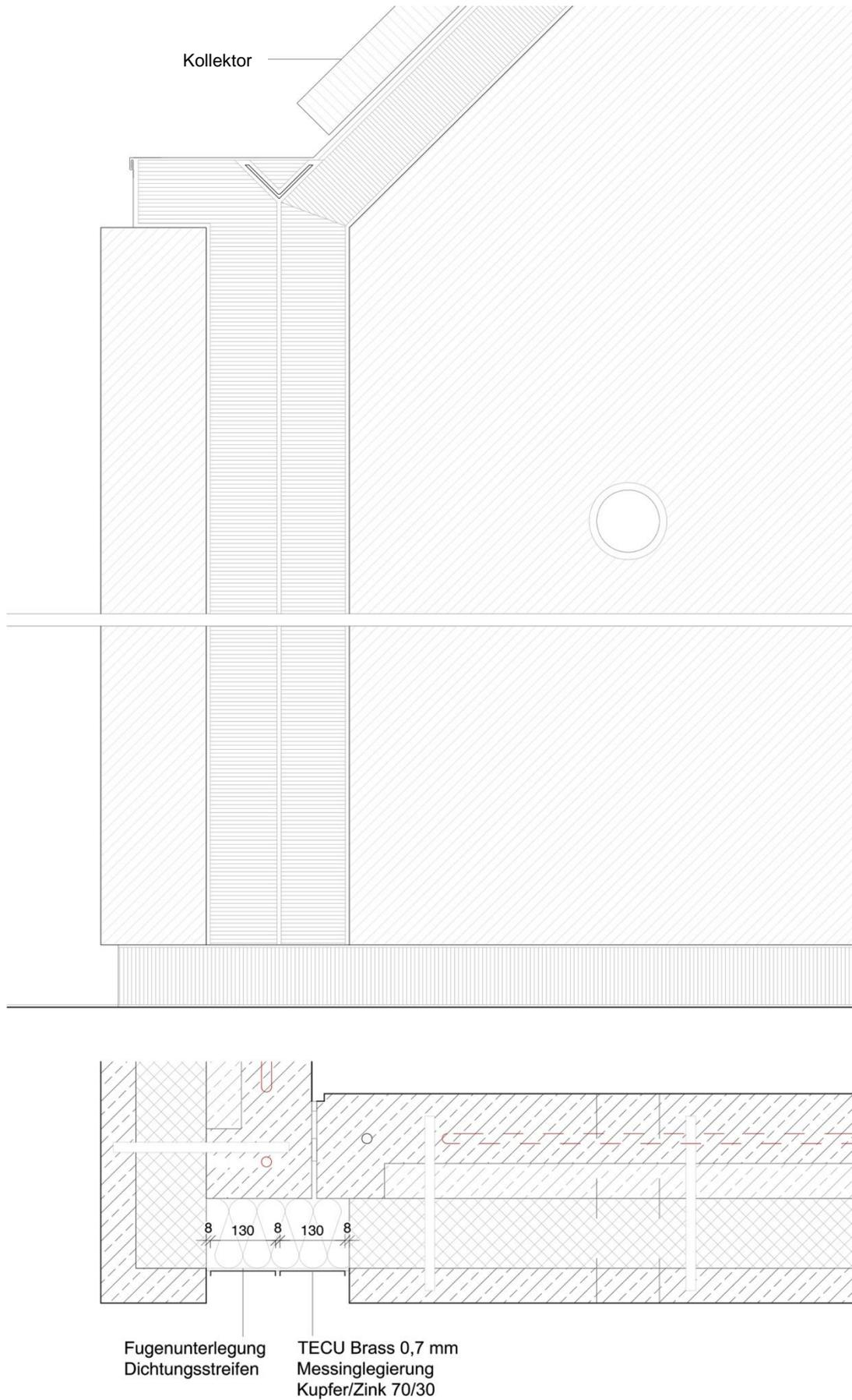
Abbildung 7: Ecklösung in Detailansicht und Horizontalschnitt
