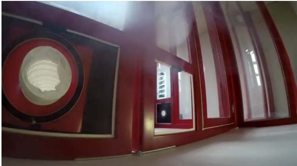
Bild 6: Test der Absaugeffizienz des modularen Schleusensystems mittels Smoker (Quelle: http://www.innenraum-luft.de/videos/video-03/index.php , aufgerufen am 28.9.2018).
