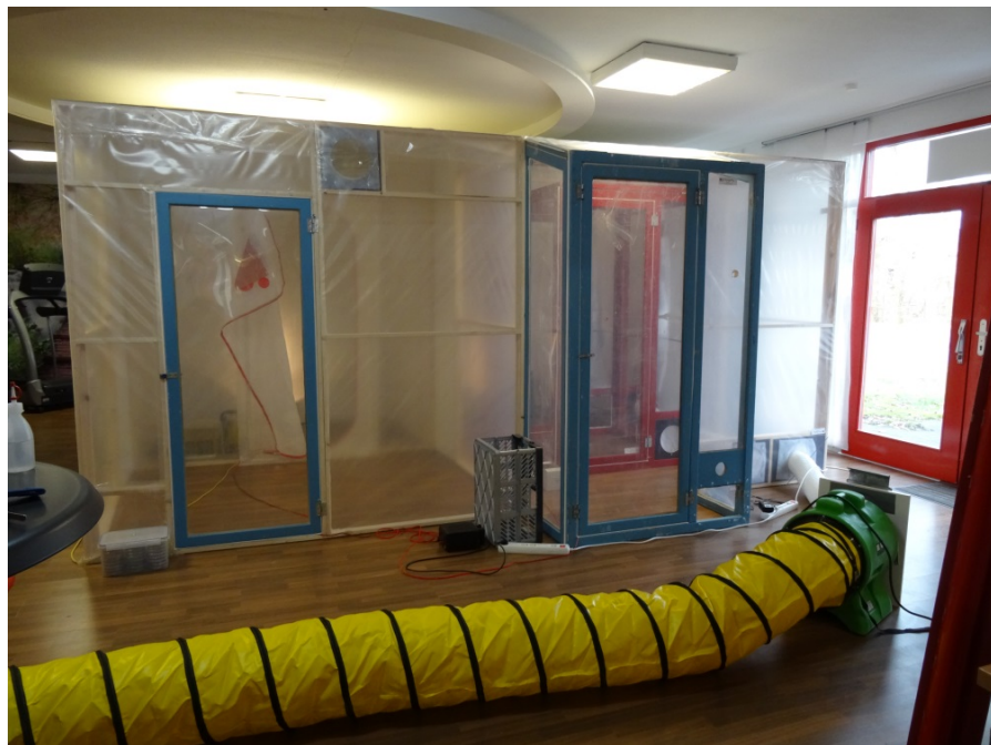
Bild 7: Gesamter Versuchsaufbau mit Blick auf die Vorräume, dahinter erkennbar die Testräume mit Baustellenabschottungen.
