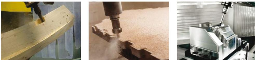
Abb. 08: (v.l.n.r): CNC-Abbundmaschine; 6-Achs-Roboter (Fräse); 5-Achs-CNC-Fräse
