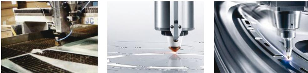
Abb. 07: (v.l.n.r): Wasserstrahlschneider; 2D-Laserschneider; 3D-Laserschneider
