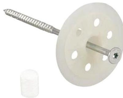
**Abb. 24:** Aufnahme der zur Befestigung der WDVS verwendeten Dübel (der abgebildete Polystyrol-Propfen wird nach dem Anziehen der Befestigungsschraube in den Dübel eingeschoben und verhindert das Entstehen einer Wärmebrücke zwischen Schraubenkopf und Putzschicht). Eine zusätzliche Befestigung des WDVS mit Dübeln ist laut Bauordnung erforderlich, wenn Gebäudehöhe und / oder Windsog vorgegebene Grenzen überschreiten.
