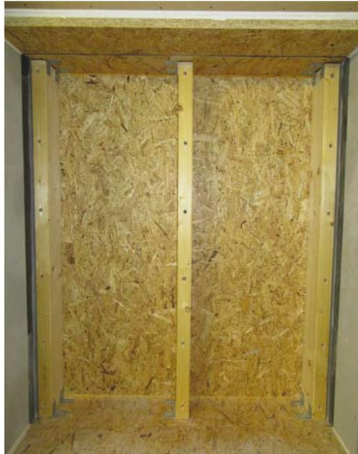
**Abb. 13:** Beispiel für den Einbau einer Holzständerwand in die Öffnung des Prüfstands (Ansicht vom Senderaum her). Die Ständer und die innenseitige Beplankung sind bereits montiert, die Gefachdämmung und die außenseitige Beplankung mit dem WDVS fehlen noch. Die in den Ständern erkennbaren Bohrungen dienen zur Montage des WDVS mittels Gewindestäben und Einschlagmuttern.
