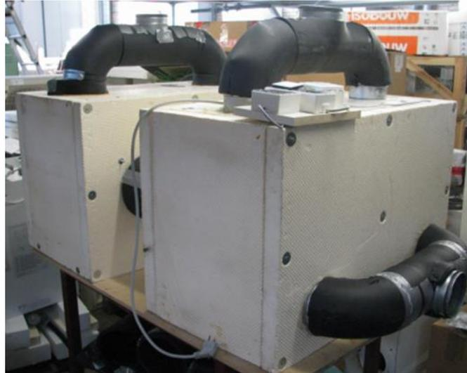
Abbildung 45: Spülluftkammern der Prüfstelle HLK
