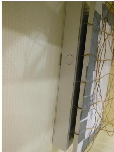
Abbildung 25: Thermoelemente zur Messung der Austrittstemperatur von Gerät 236
