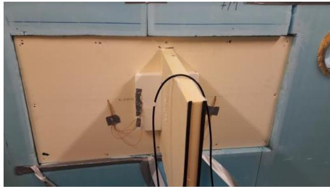
Abbildung 53: Platte zur Verhinderung von Kurzschlussströmung beispielhaft bei Gerät C auf der Außenseite
