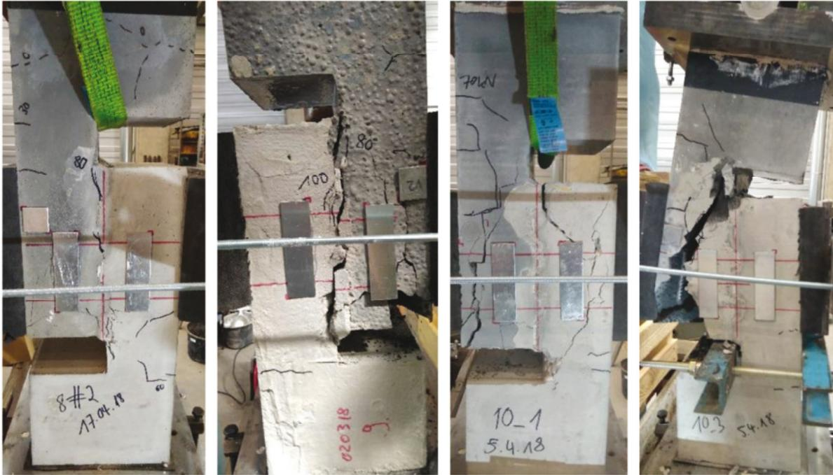
Abb. 6-23: Prüfkörper 8.2 (links), Prüfkörper 9.3 (Mitte links), Prüfkörper 10.1 (Mitte rechts) und Prüfkörper 10.3 (rechts) nach dem Versagen
