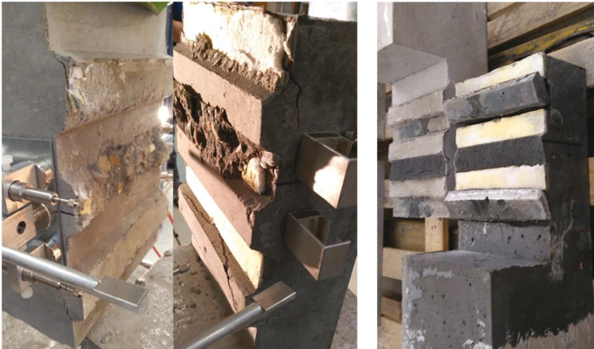
Abb. 6-17: Versuchsreihe 5 (beide Bilder links) und Versuchsreihe 7 (rechts) nach dem Bruch
