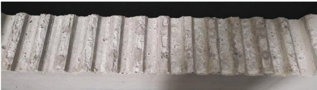
Abb. 6-7: Ergebnis der Verzahnung im zweiten Versuch
