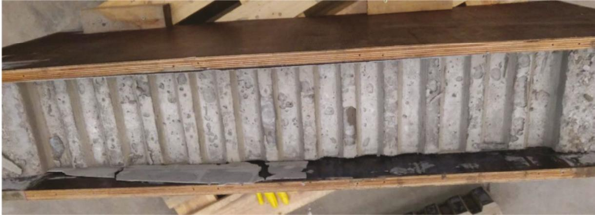
Abb. 6-5: Ergebnis der Verzahnung im ersten Versuch (Draufsicht)
