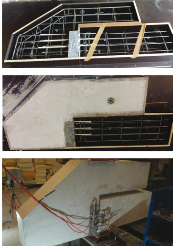
Abb. 8-2: Herstellungsschritte der Versuchskörper
