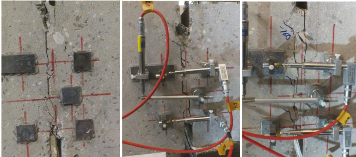
Abb. 8-8: Prüfkörper b1 (links), b2 (Mitte) und b3 (rechts) nach dem Versagen
