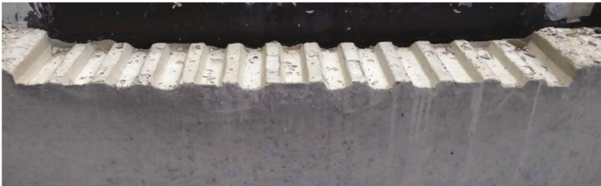
Abb. 6-6: Ergebnis der Verzahnung im ersten Versuch (Ansicht)
