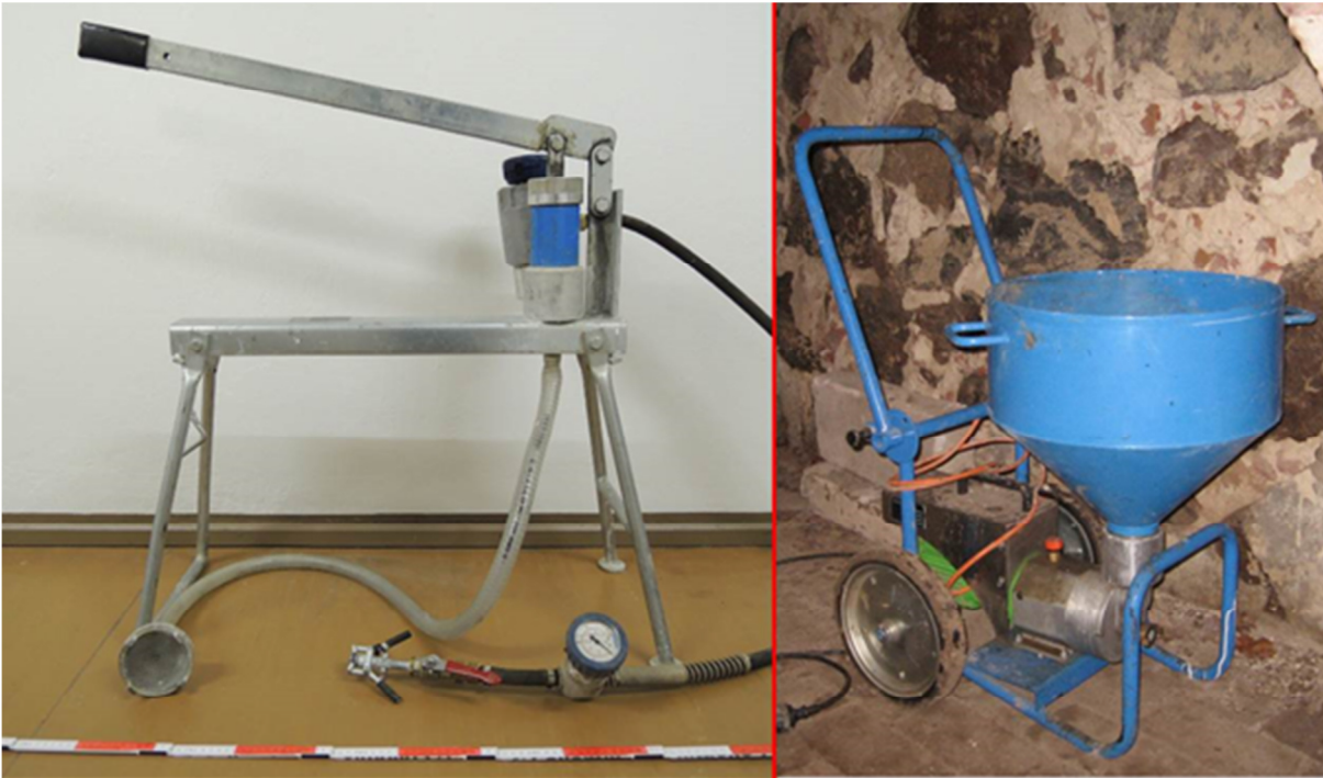
Bild 103 Links Handhebelkolbenpumpe, rechts elektrische Schneckenpumpe.
