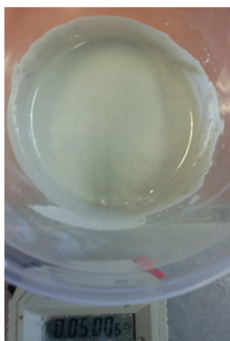
Bild 69 Blasenfreier Frischmörtel nach 5 min Reaktionszeit
