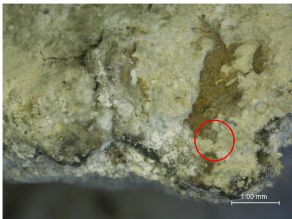
Bild 29 Detailaufnahme aus Bild 28, Neubildungen wachsen in alle Hohlräume
