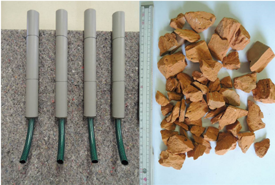
Bild 6 Links sind vier HT-Rohre mit Schlauchanschlüssen zu sehen. In diese Rohre wird das poröse Substrat – in diesem Fall Ziegelbruch – eingefüllt (rechts im Bild).
