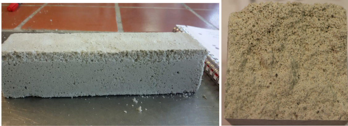
Bild 72 CASEA-HGE-Schaummörtelprisma, rechts Bruchfläche
