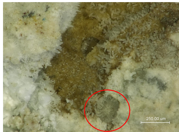
Bild 30 Detail aus Bild 28, nadelförmige Kristalle wachsen im gesamten Gefüge
