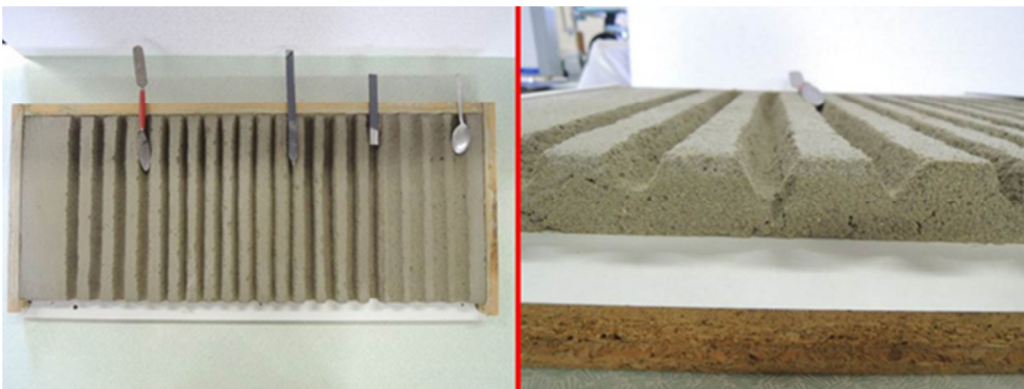
Bild 12 Putzplatte mit unterschiedlichen Rillengeometrien zum Ermitteln der Fließfähigkeit in porösen Medien
