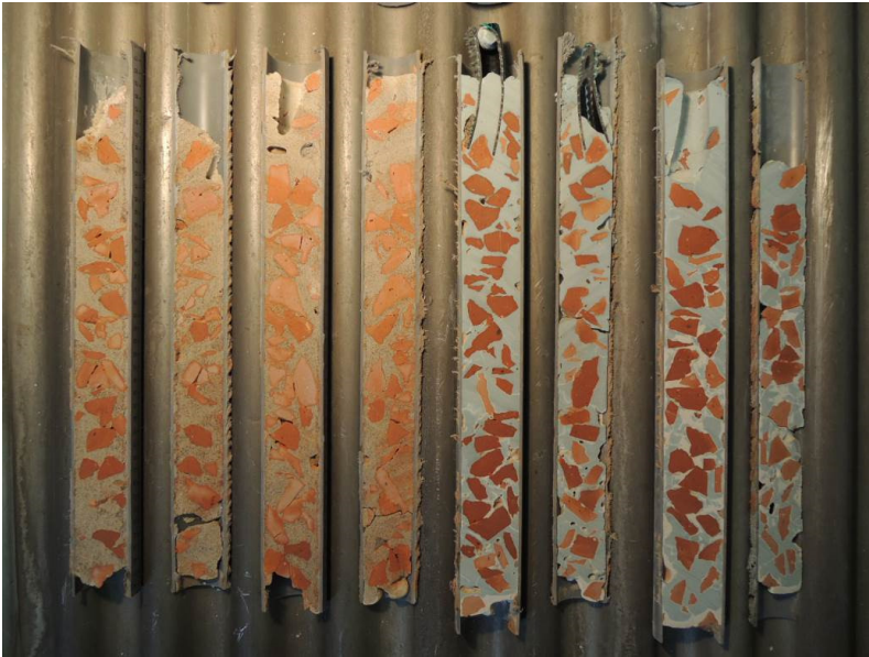
Bild 7 Aufgesägte Rohren nach dem Verpressversuch
