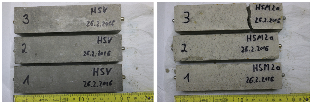
Bild 34 Geschädigte sulfatbelasteten Probekörper, links HSV und rechts HSM 2a
