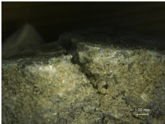
Bild 27 Geschädigter Probekörper aus Romanzement Marfil
