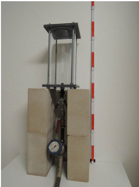
Bild 10 Prototyp aus Acrylglas für Versuche zum Verpressen von Hohlräumen mit Substratfüllung
