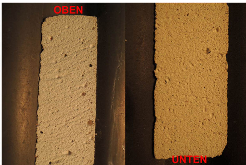
Bild 9 Oberes und unteres Ende eines aufgesägten Mörtelzylinders
