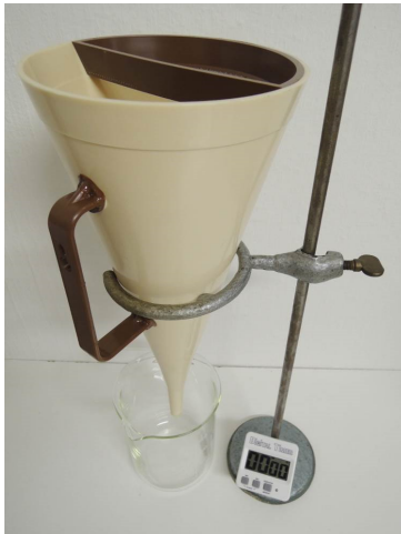
Bild 13 Marsh Trichter mit genormtem Auslass und 1 Liter Becherglas und Stoppuhr
