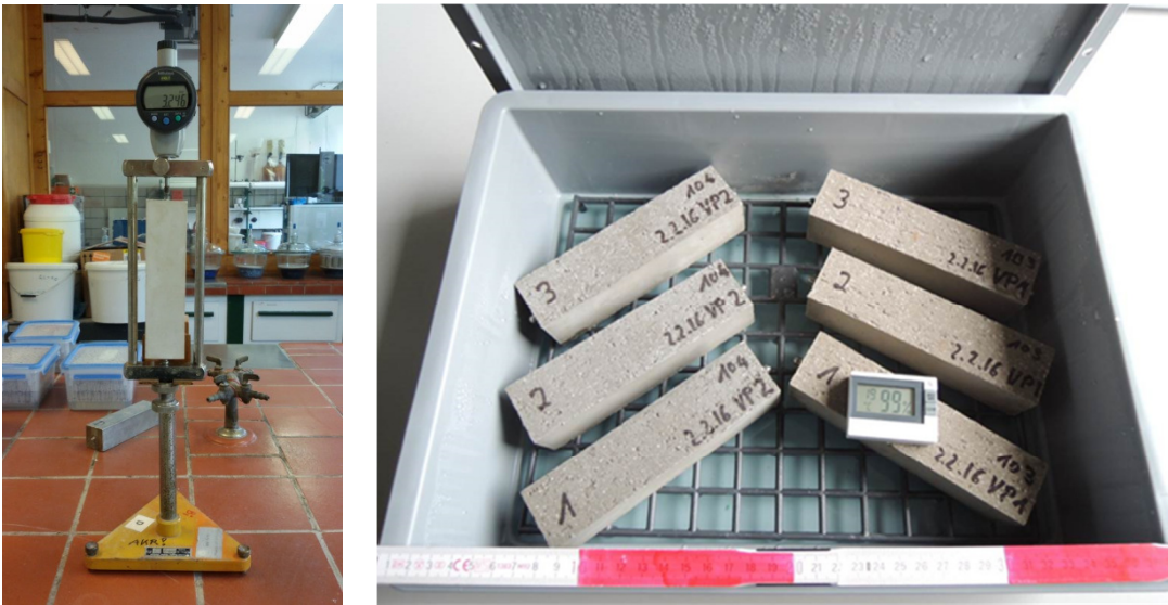
Bild 23 Links Messeinrichtung zum Ermitteln der Längenänderung, rechts Kunststoffbox mit Gitterboden für die über Wasserlagerung
