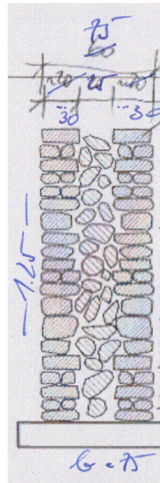
Bild 96 Mehrschalige Modellmauer zum Verfüllen mit dem im Projekt entwickelten Schaummörtel
