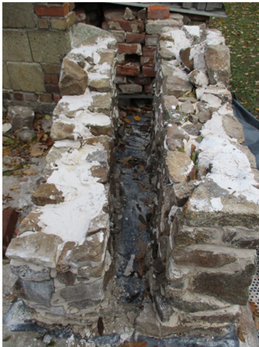
Bild 96 Mehrschalige Modellmauer zum Verfüllen mit dem im Projekt entwickelten Schaummörtel
