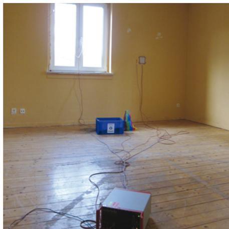
Abb. 19: U-Wert-Messung Außenwand, außen
