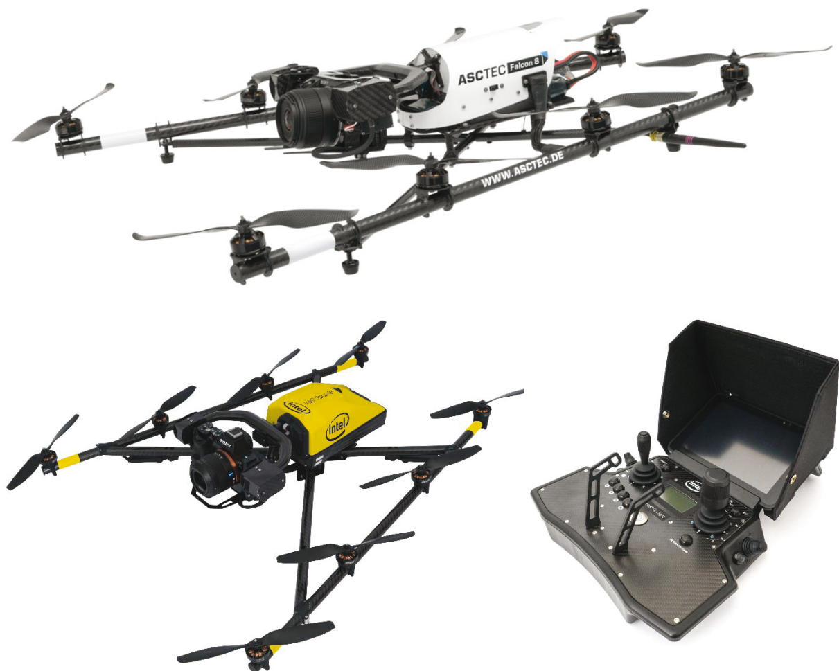
Abbildung 1: Flugsysteme vom Typ Intel Falcon 8 (oben) und Falcon 8+ (unten links) mit mobiler Bodenstation
