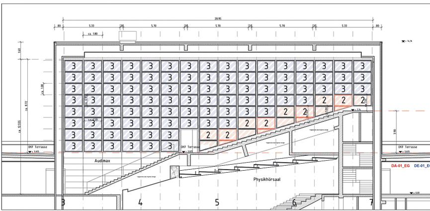
Abb. 4: Innenansicht Glasfassade Nord/Süd (spiegelgleich); blau: Innenverglasung 6 mm ESG, nicht scharf splitternd; rot: absturzgefährdeter Bereich, 6 mm VSG aus ESG-H
