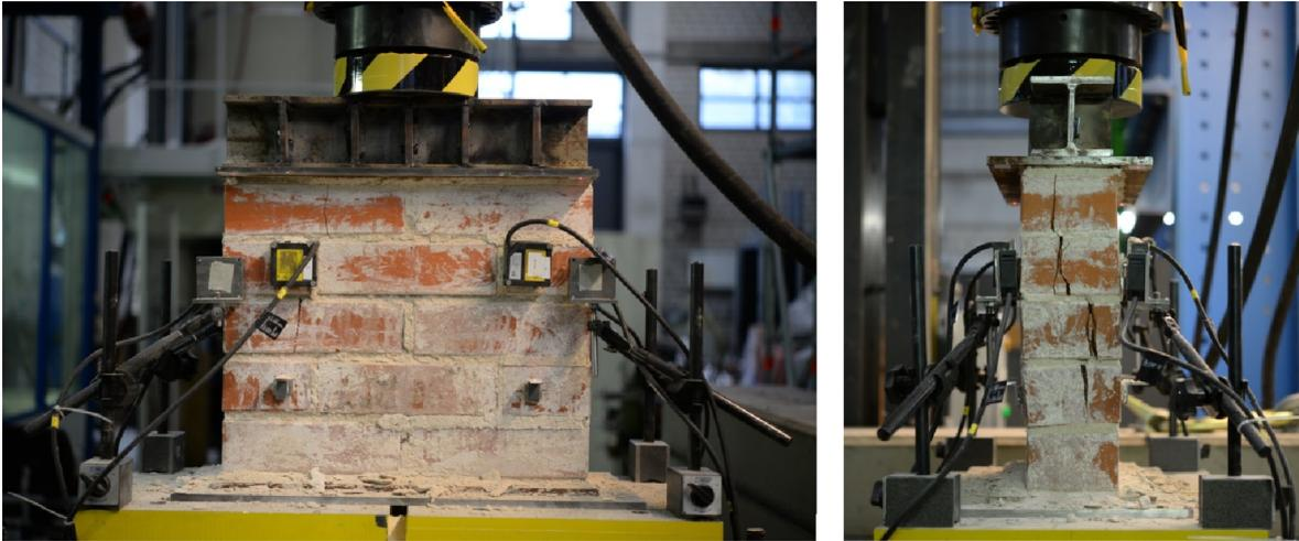
Abbildung 30: Bruchbild einer zentrisch belasteten Mauerwerksprobe im Rahmen der Bestimmung des Elastizitätsmoduls
