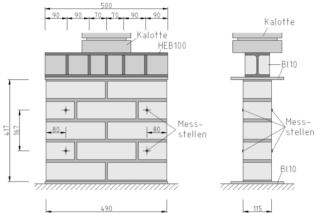
Abbildung 29: Versuchsaufbau zur Bestimmung des Elastizitätsmoduls des Mauerwerks (Maße in mm)
