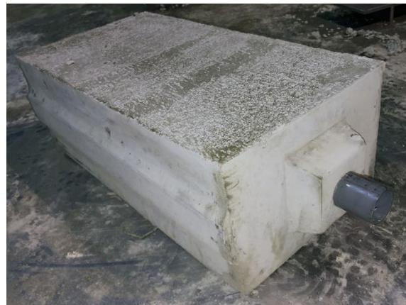
Bild 192. RC-Betonstein 4, Anti-Noppenseite
