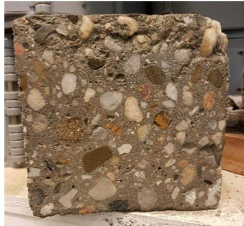
Bild 267. Gebrochener RC-Betonwürfel    Bild 268. Geschliffener Normalbetonwürfel
