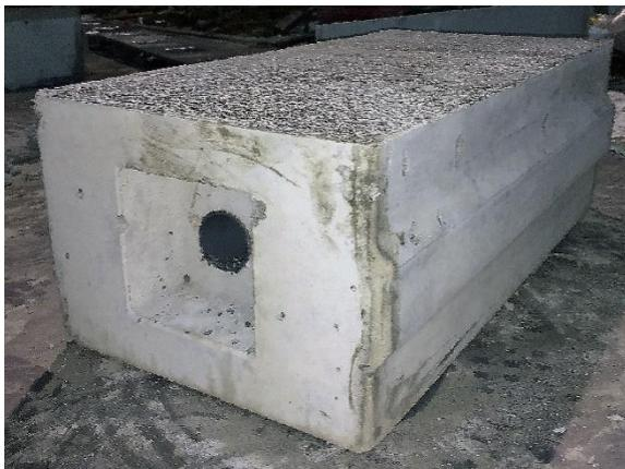
Bild 191. RC-Betonstein 4, Noppenseite
