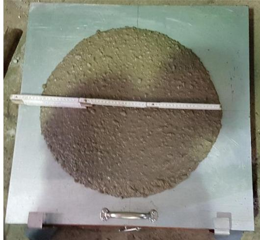
*Bild 265. Überprüfung des Ausbreitmaßes gemäß DIN EN 12350-5*
