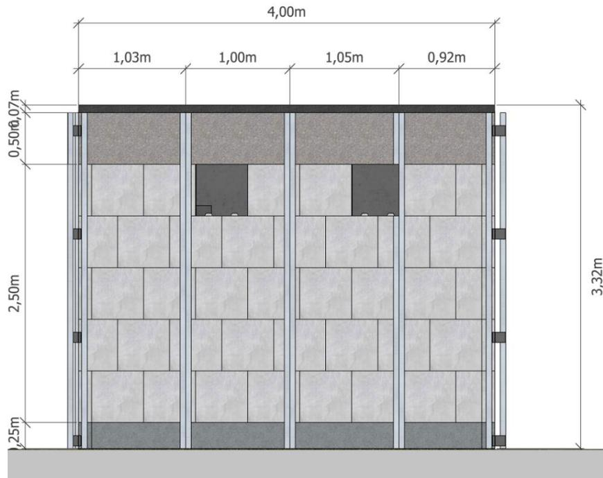
Bild 45. Ansicht West-Ausbau-Fassadenkonstruktion
