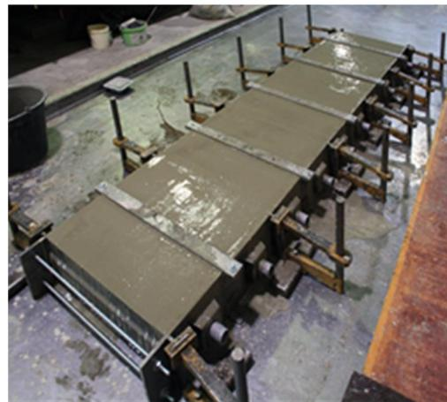
*Bild 169. Betonier-Vorgang RC-Betonsteine Bild 170. Fertig betonierte RC-Betonsteine/ Glätten*
