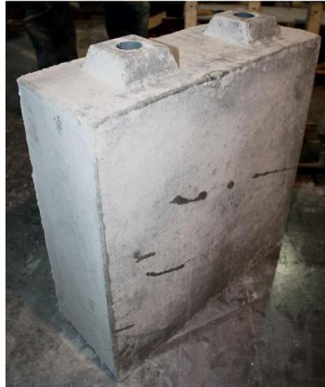
Bild 175. RC-Betonstein 2 nach Aus-Bild 176. RC-Betonstein 2 nach Ausschalen, Ansicht-Nut
