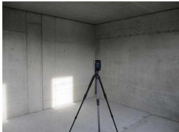
Bild 254. Durchführung des Belastungs-Bild 255. 3D-Verformungsmessung/ Laser-Scanning vor und nach der Durchführung des Belastungstestes
