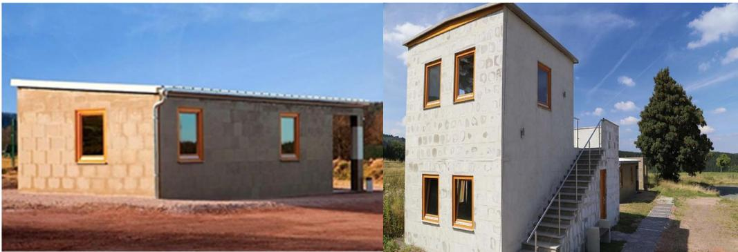
Bild 9. Polycare: Haus aus Polymerbeton. in: <https://www.ingenieur.de/technik/fachbereiche/umwelt/dieses-haus-lego-steinen-wuestensand/>, 30.04.2018.
