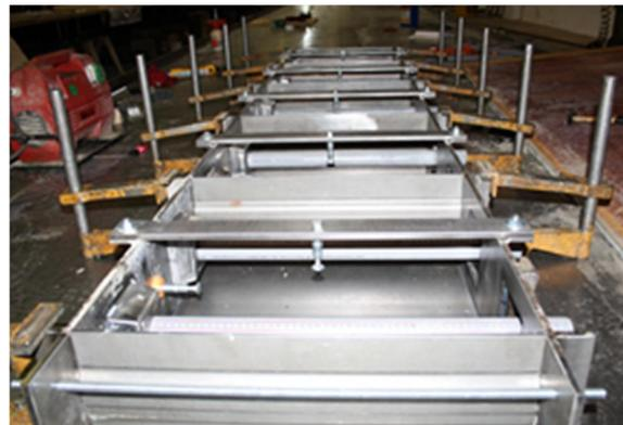
*Bild 167. Fertiges Schalsystem, Einzelstein*
