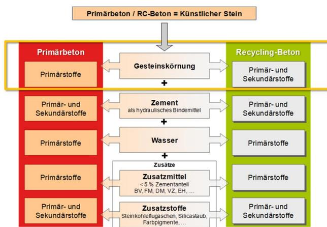
Bild 5. Synopse Zusammensetzung Primärbeton mit RC-Beton [2]
