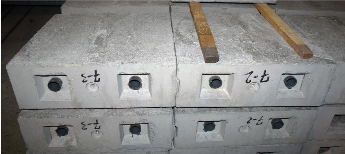
Bild 179. RC-Betonsteine 2 und 3, Ausschalen, Kennzeichnung & Lagerung
