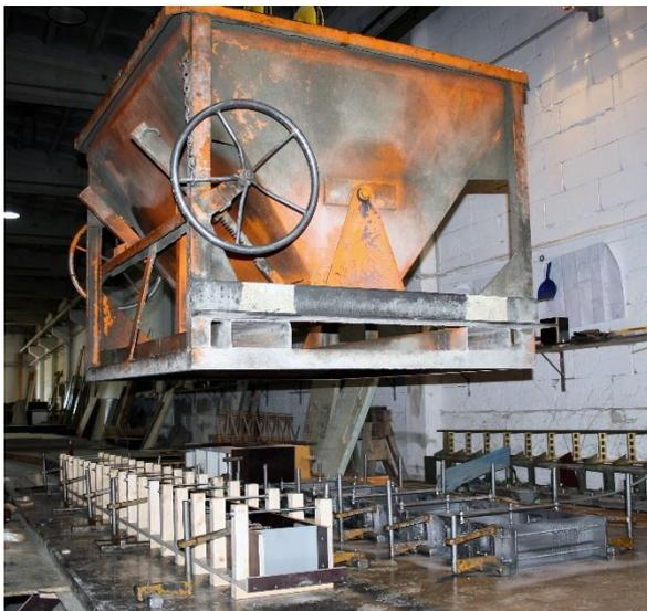
Bild 201. RC-Balken, Betonier-Vorgang
