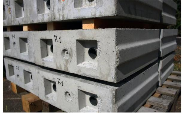
*Bild 171. Ausschalen der RC-Betonsteine    Bild 172. Kennzeichnung der fertigen RC-Betonsteine*
