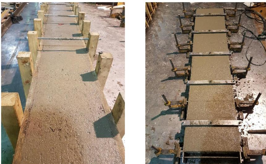
*Bild 281. Herstellung RC-Balken sowie RC-Steine im Betonfertigteilwerk der Fa. M&L*
