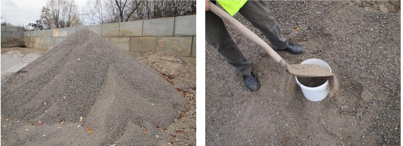
*Bild 24. Probenahme vom Haufwerk 0/16 mm Betonbruch auf dem Betriebsgelände der Firma Heim Deponie & Recycling GmbH*
