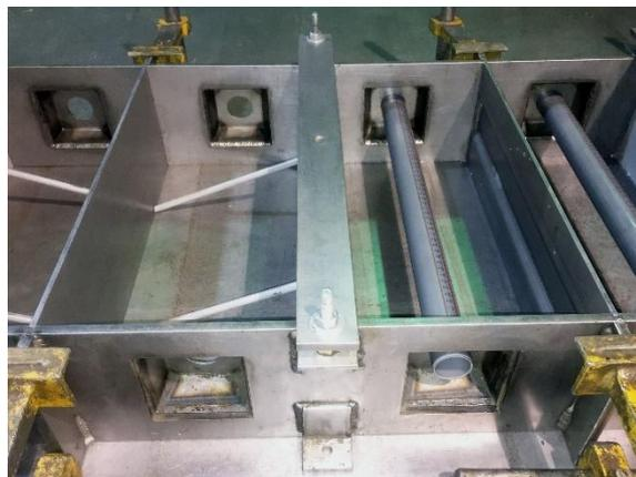
*Bild 183. Schalung für RC-Beton-Halbsteine*      *Bild 184. Schalprinzip für Halbsteine*
