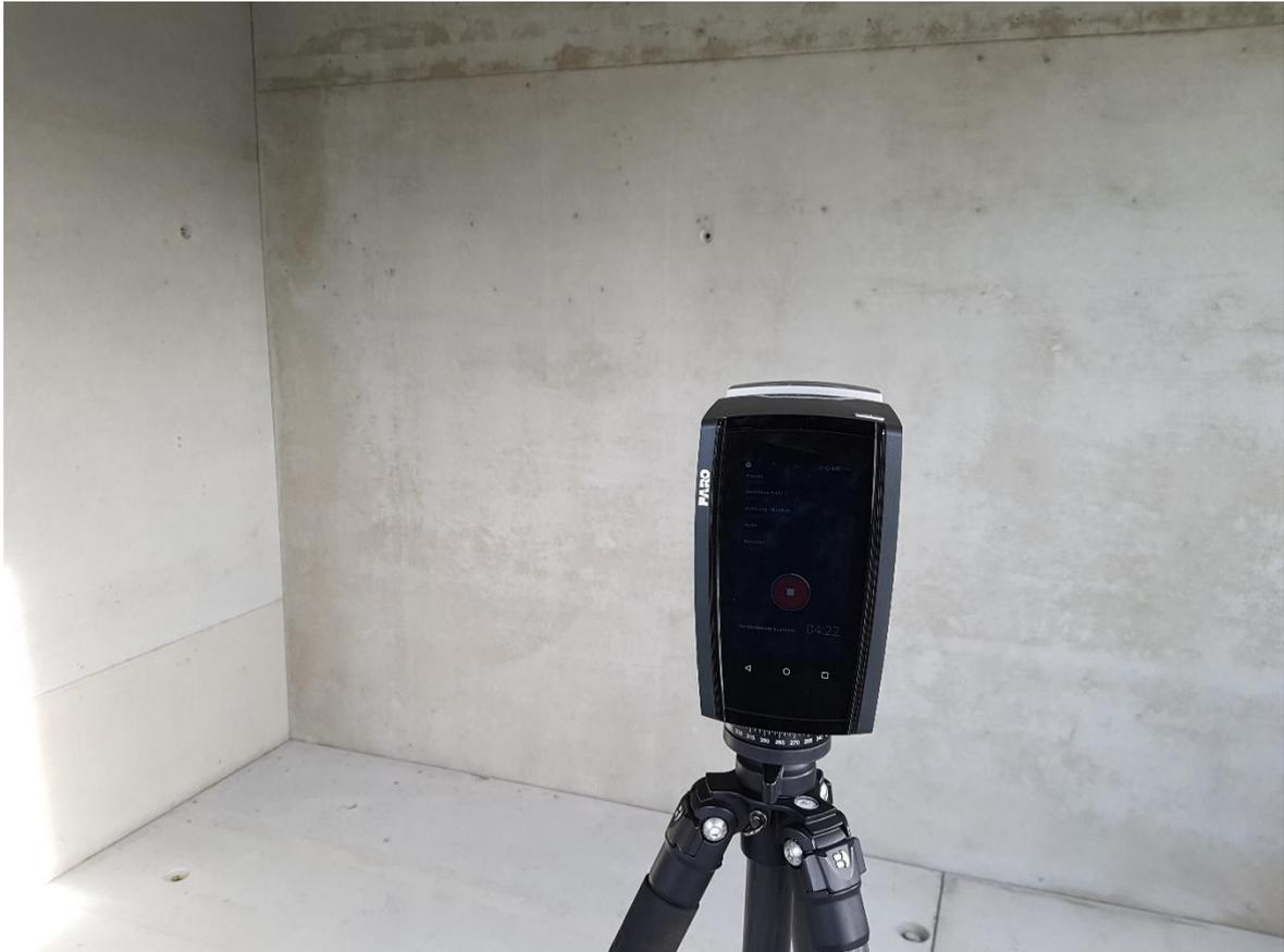
*Bild 252. 3D-Verformungsmessung/ Laser-Scanning nach der Fertigstellung der RC-Wohneinheit*
