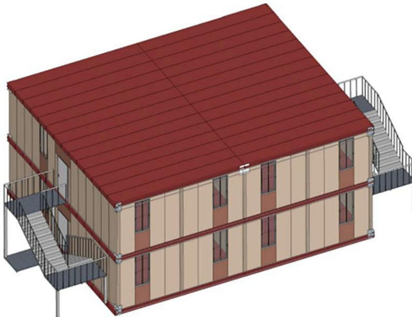
*Bild 54. Modifizierte RC-Wohneinheit aus Bauteilelementen*
