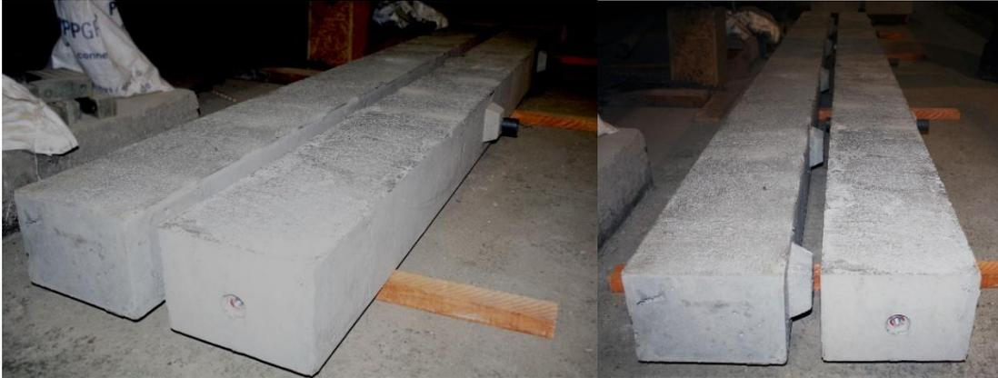
Bild 207. RC-Balken 1 & 2 nach dem Ausschalen
