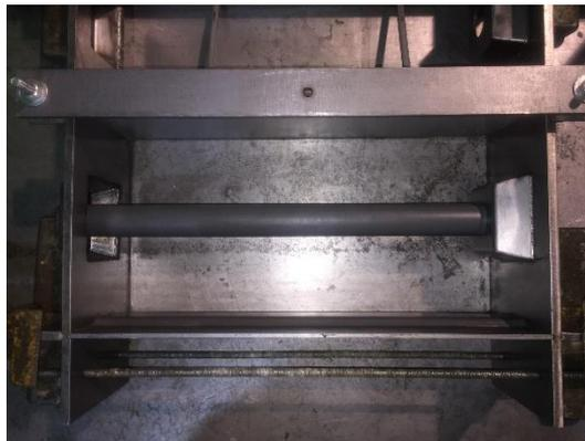
Bild 279. Rohrverbindung für die Gewindeverankerung zwischen den Schalungswänden
