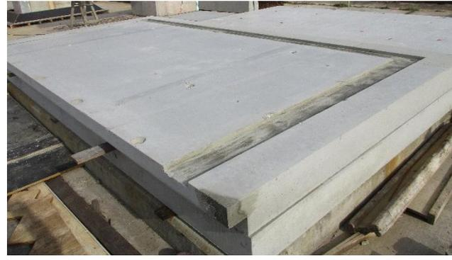
*Bild 132. RC-Bodenplatte 1 nach der Ausschalung*
