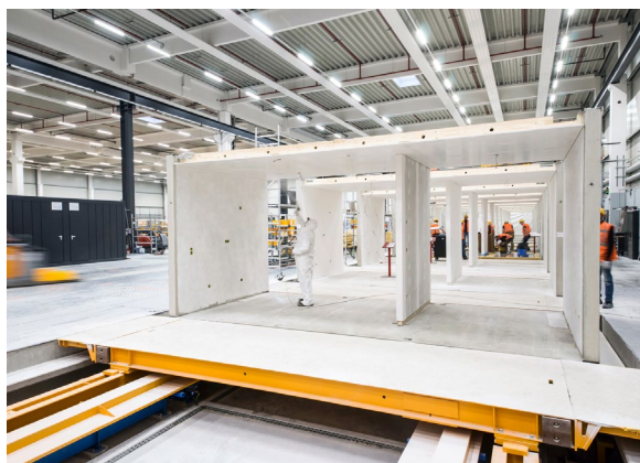
Abb. 16: Produktionsschritte in der Vorfertigung: Herstellung der Fertigeteile, Montage, Innenausbau (Quelle: Max Bögl Modul AG)
