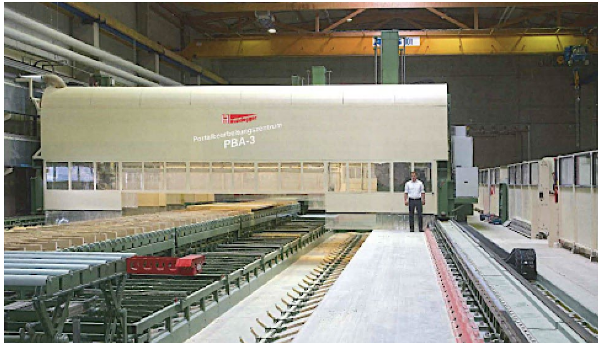
Abb. 23: Abbundanlage in Aichach (Quelle: Jauk, Günther, Der flinke Riese - Abbund-Megaprojekt in Aichach; Zeitschrift Holzkurier; Wien, 21.04.2016.)
