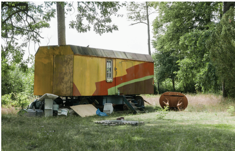
Abb. 3.8.7: Bauwagen als provisorische Unterkunft für die Bauzeit
