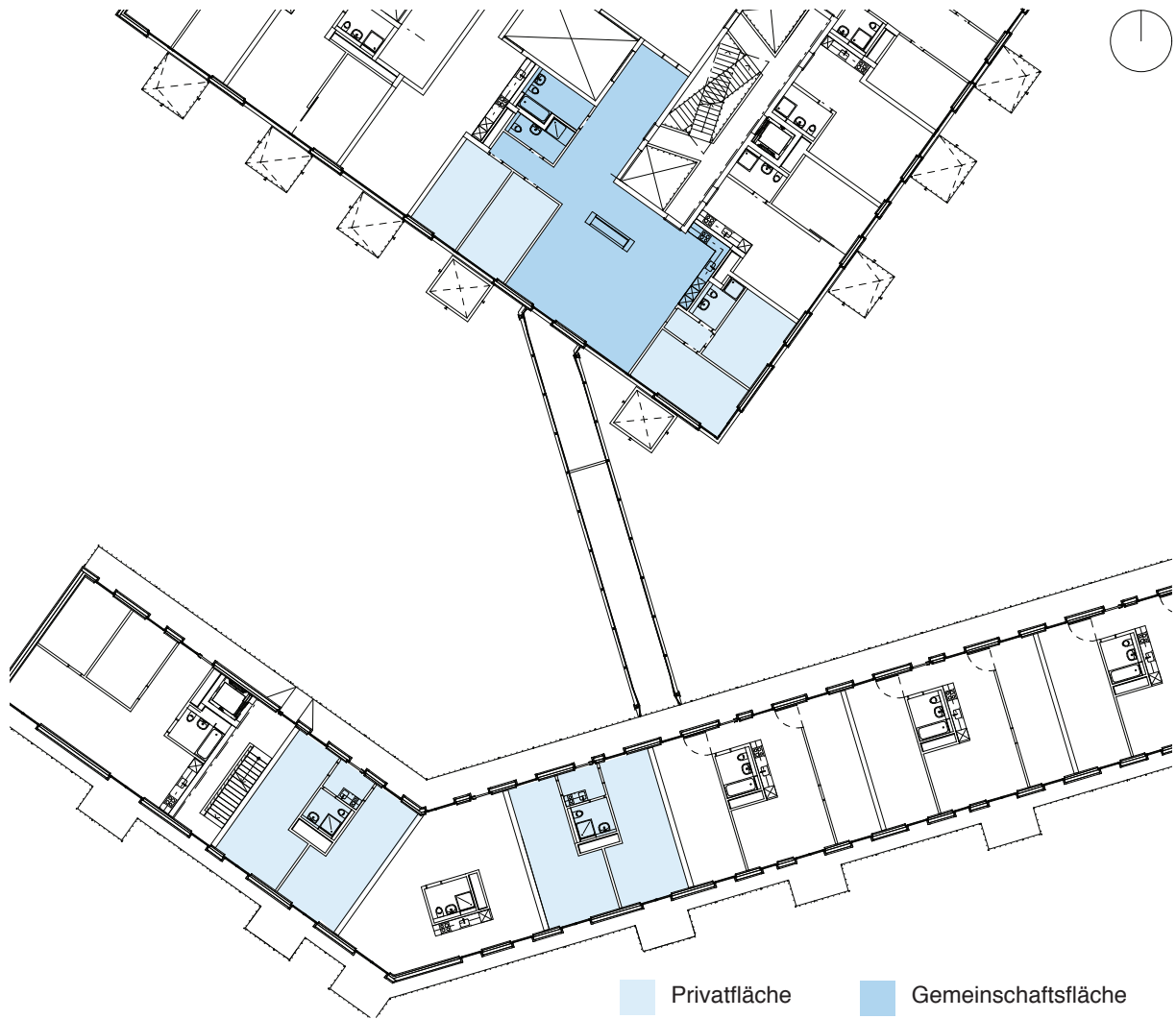
Abb. 3.5.3: Grundriss der Cluster-Wohnung im 5.OG der Gebäude 5 und 6 von Zwicky Süd (Ausschnitt), M 1:400
