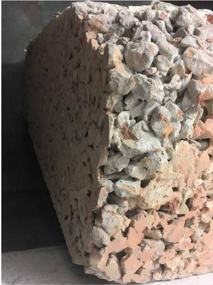
Abb. 5: Teil eines Bohrkerns aus Original-Ziegelsplittbeton. Er wurde bei einer Umbaumaßnahme im Keller entnommen und enthält wesentlich mehr Mauerwerksbruch als heutige R-Betone mit Typ 2-RC-Körnung.
