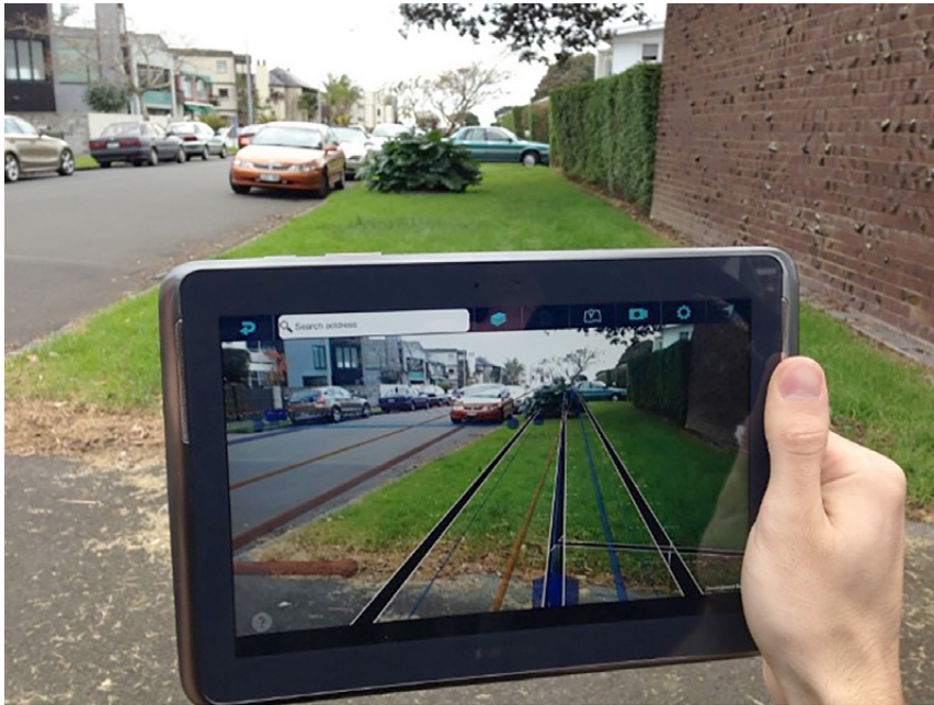
Abb. 02: Augmented Reality für Leitungsvisualisierung (erstellt mit dem AR-System AugView)
