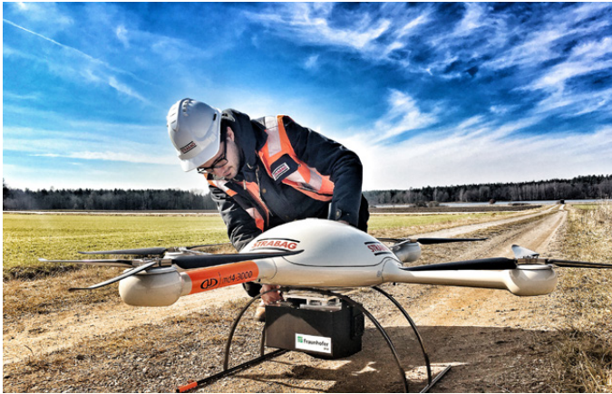
Abb. 07: Präzisions-Laserdrohne [STRABAG AG]
