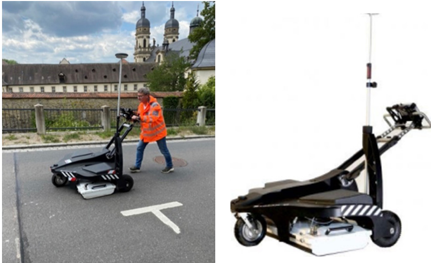
Abb. 08: Leitungsortung durch Wilhelm Dresselhaus mit dem Ortungsgerät »Stream C«
