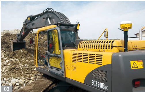
Abb. 03: Bagger mit Trimble GNSS [SITECH]
