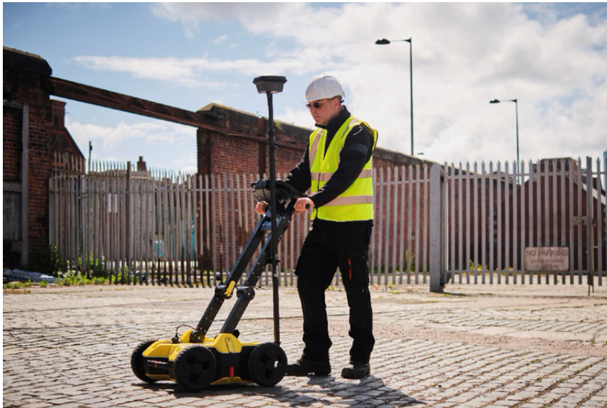
Abb. 02: Leitungsortung durch Bodenradar [Quelle: Hexagon Geosystems]
