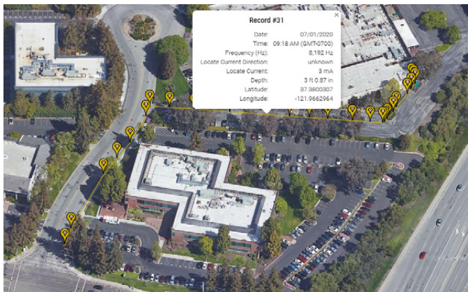
Abb. 10: Auswertung der Daten, zum Beispiel mit Google Earth [Quelle: Vivax-Metrotech]
