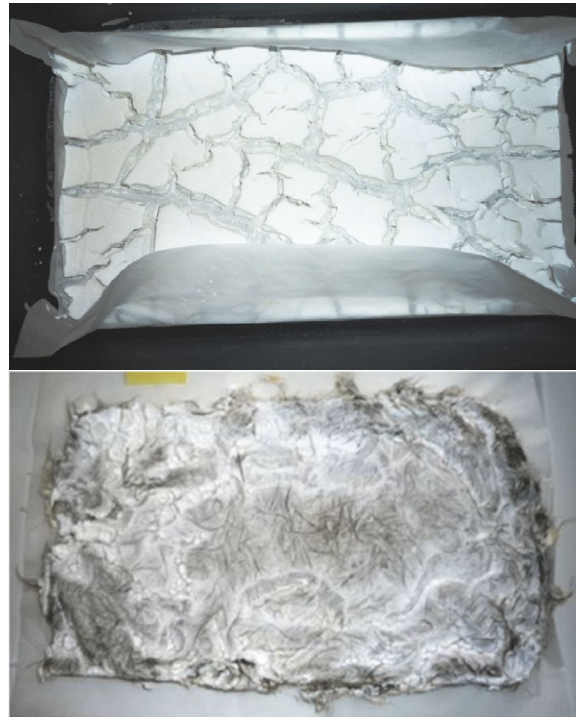
Bild 2 Bild einer unbewehrten Aerogelplatte nach der Trocknung (oben) und einer bewehrten Platte (unten) [Quelle: GETA mbH]
