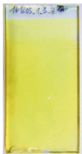
Bild 4 Gegenelektrode, Aufbau: Glas/transparente leitfähige Schicht/Metalloxid.
