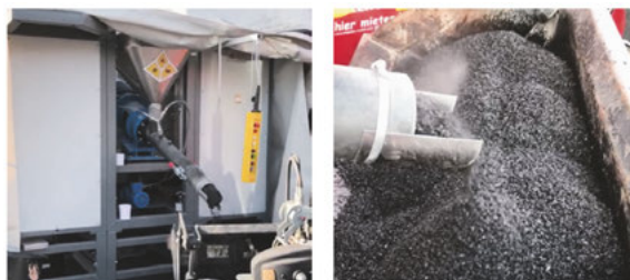
Bild 4 Dosieranlage (links) und hergestelltes Mischgut (rechts) [1, 3]
