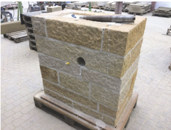
Bild 3 Im Technikum versuchsweise verfülltes zweischaliges Mauerwerk mit Einbringungsbohrung (Quelle: CASEA GmbH)
