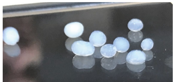
Bild 1 Kontinuierlich hergestellte Aerogel-Kugeln für die Anwendung in Aerogeldämmputzen. (Quelle: PROCERAM GmbH & CO. KG)
