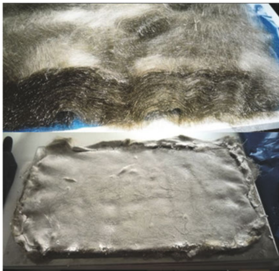
Bild 3 Unvernaedeltes Basaltfaservlies (oben) und Aerogel-Dämmplatte mit unvernaadeltem Basaltfaservlies als Bewehrung nach der Trocknung (unten). [Quelle: GETA mbH]
