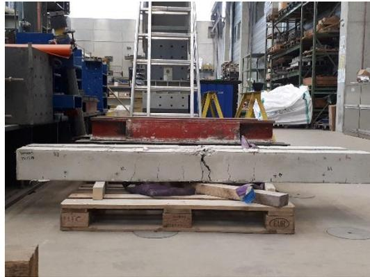
Abbildung A 46: Entwicklung des Versagensrisses unmittelbar vor dem Bauteilversagen (links) und Versuchskörper (Q.S8.C25.0,44.3,5) nach der Prüfung (rechts)
