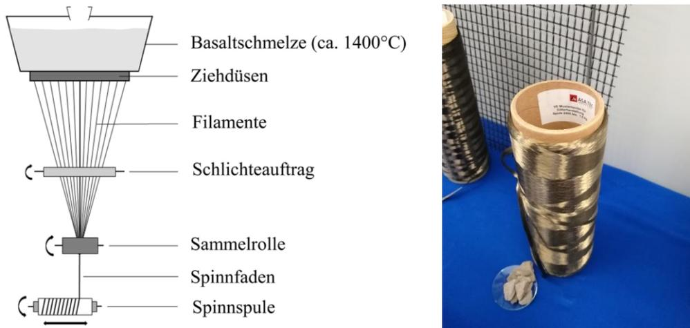
**Abbildung 3.2: Herstellprinzip des Düsenziehverfahrens aus Deutsche Basalt Faser GmbH (2016) (links) und eine Basaltfaser auf einer Spinnspule (rechts)**
