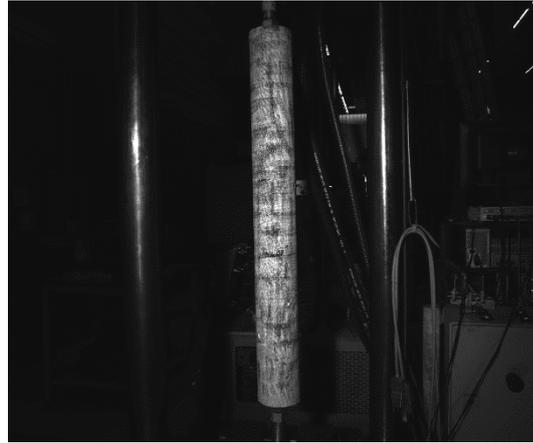
**Abbildung A 14: Zentrischer Zugversuch am Betonzylinder Z.B10.75.1,72 (links) und Z.B8.100.1,00 (rechts)**
