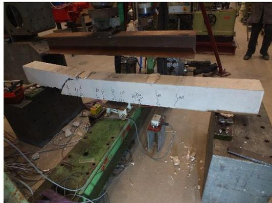
Abbildung A 47: Entwicklung des Schubrisses unmittelbar vor dem Bauteilversagen (links) und Versuchskörper (Q.S8.C25.0,89.3,5) nach der Prüfung (rechts)
