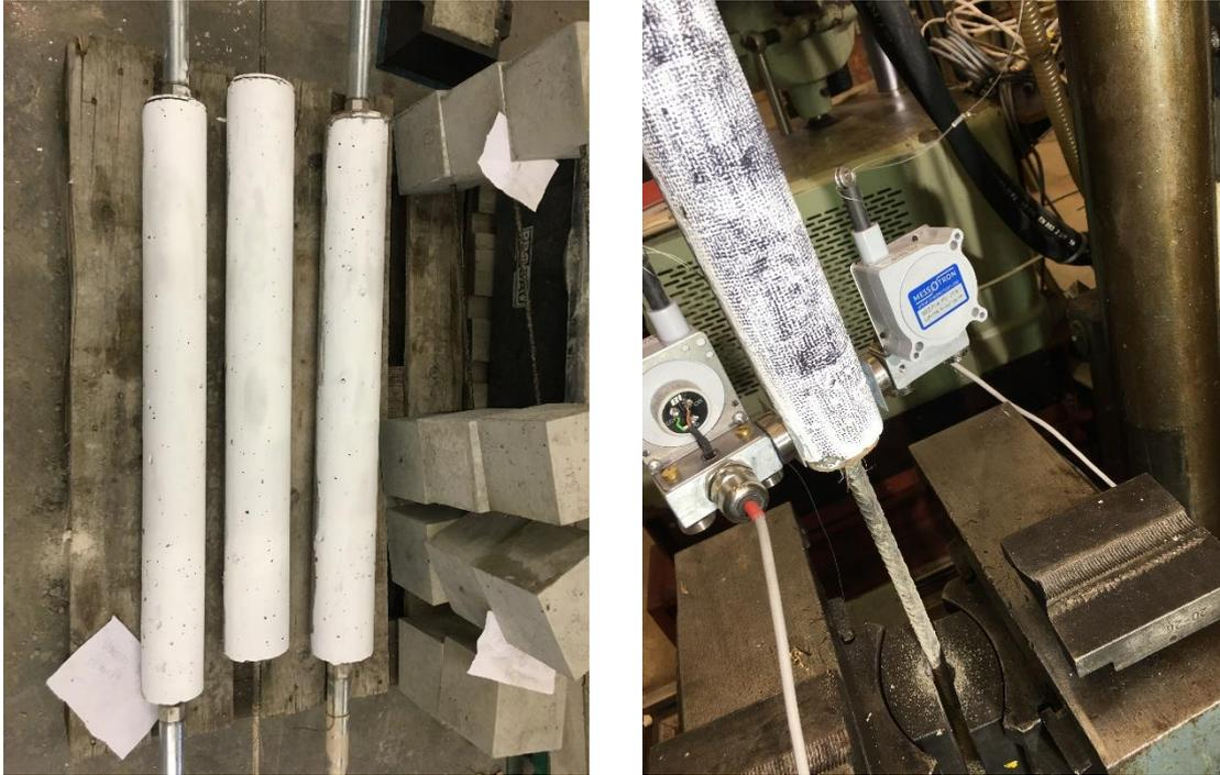
Abbildung A 12: Betonzylinder vor der zentrischen Zugprüfung (links); Detailaufnahme der Position der analogen Messtechnik – Seilzugwegaufnehmer (rechts)
