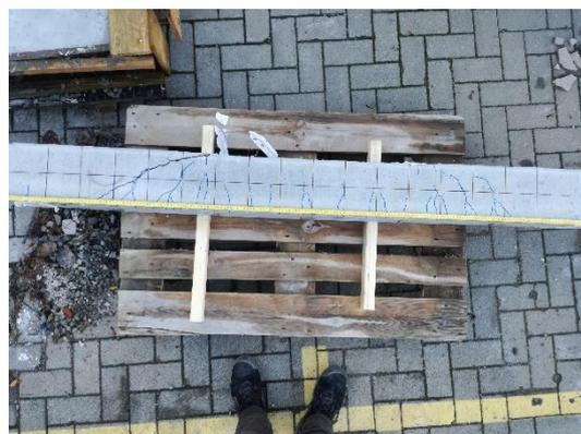
Abbildung A 45: Entwicklung des Schubrisses unmittelbar vor dem Bauteilversagen (links) und Versuchskörper (Q.B8.C50.1,19.3,5) nach der Prüfung (rechts)
