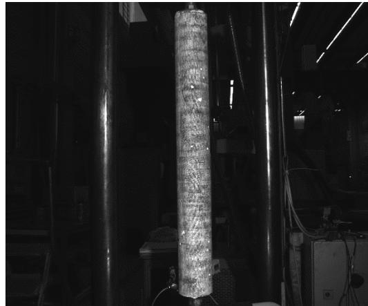
**Abbildung A 15: Zentrischer Zugversuch am Betonzylinder Z.B10.110.0,81 (links) und Z.B10.125.0,62 (rechts)**
