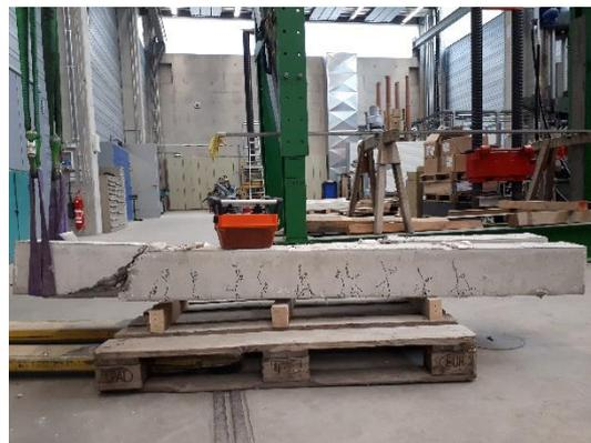
Abbildung A 42: Entwicklung des Schubrisses unmittelbar vor dem Bauteilversagen (links) und Versuchskörper (Q.B8.C25.0,37.2,0) nach der Prüfung (rechts)
