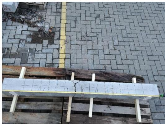
Abbildung A 48: Entwicklung des Versagensrisses unmittelbar vor dem Bauteilversagen (links) und Versuchskörper (Q.S8.C50.0,48.3,5) nach der Prüfung (rechts)
