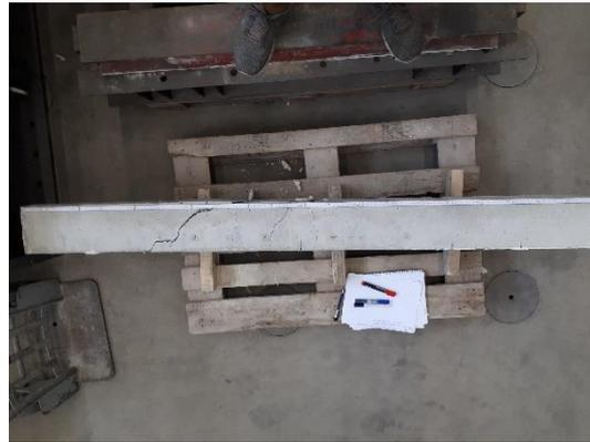
Abbildung A 40: Entwicklung des Schubrisses unmittelbar vor dem Bauteilversagen (links) und Versuchskörper (Q.B8.C25.0,37.5,0) nach der Prüfung (rechts)
