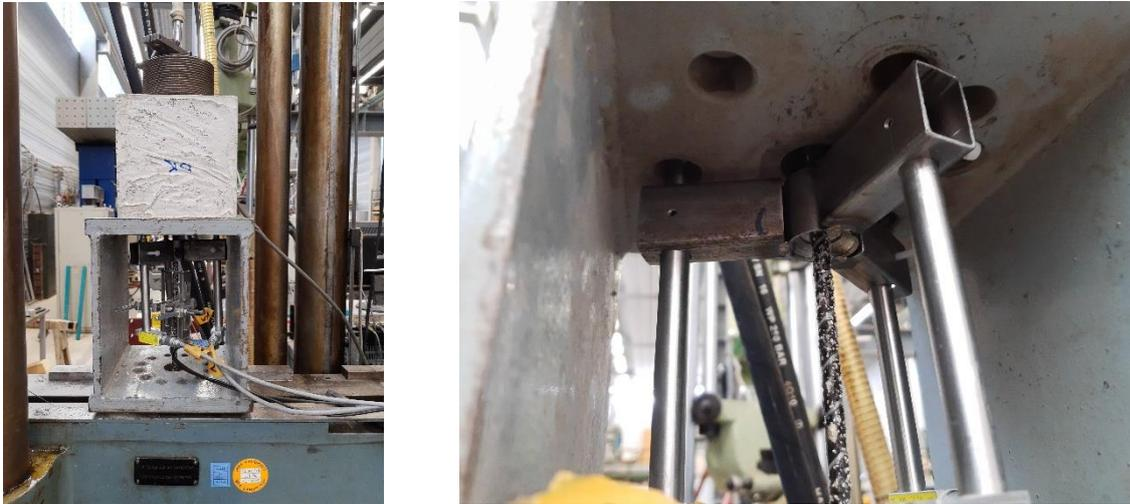
Abbildung A 6: Versuchsaufbau der Auszugsversuche mit angebrachter Messtechnik
