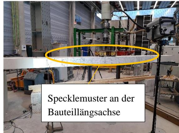
**Abbildung 4.7: Specklemuster der Messbereiche zur Anwendung der digitalen Bildkorrelation für die Dokumentation der Biegeversuche am Plattenstreifen**
