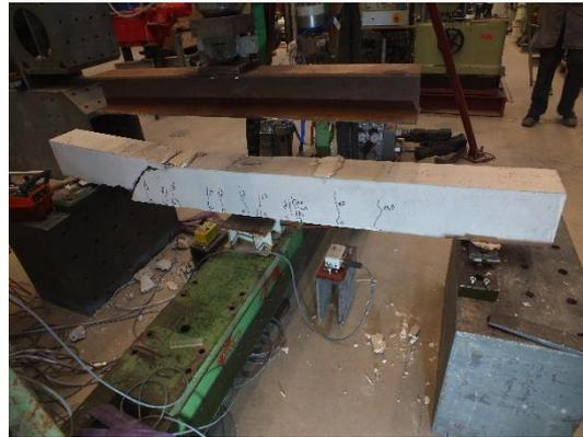
Abbildung A 43: Entwicklung des Schubrisses unmittelbar vor dem Bauteilversagen (links) und Versuchskörper (Q.B6.C25.0,39.3,5) nach der Prüfung (rechts)
