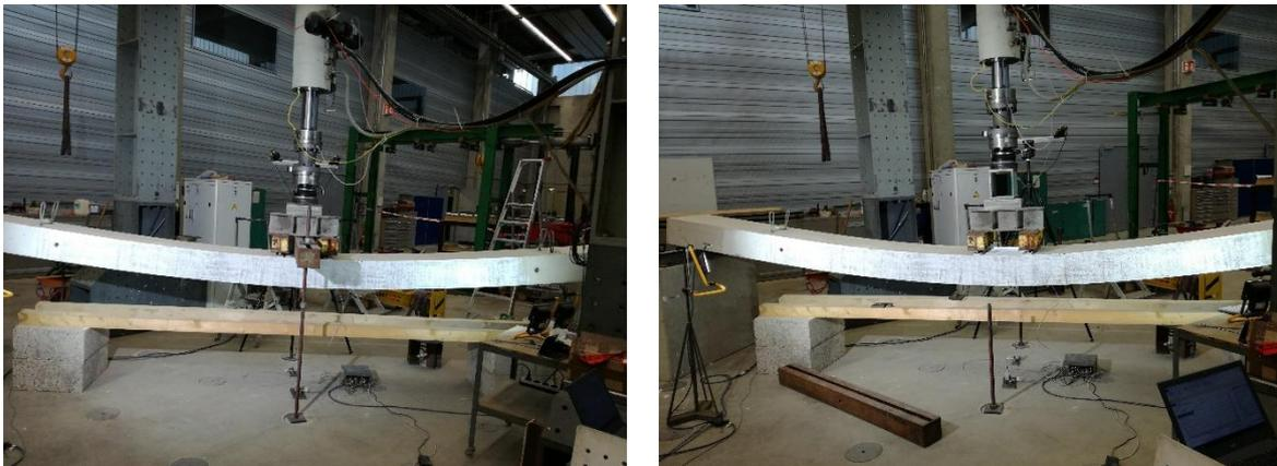
**Abbildung 4.6: Abspannung des Bauteils bei maximalem Hydraulikzylinderweg von 250 mm (links) und Unterfütterung des Hydraulikzylinders nach der Abspannung (rechts)**
