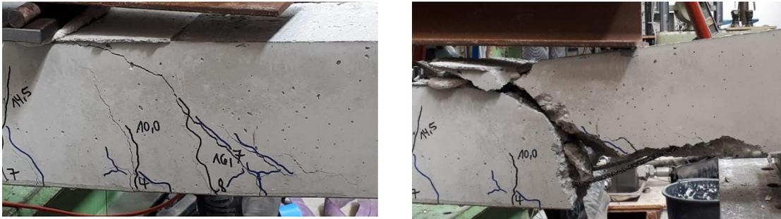
**Abbildung 6.1: Bildung des kritischen Schubrisses am Versuchskörper BR.B8.C25.0,37.3,5 unmittelbar vor (links) und nach (rechts) dem Erreichen der maximalen Traglast**
