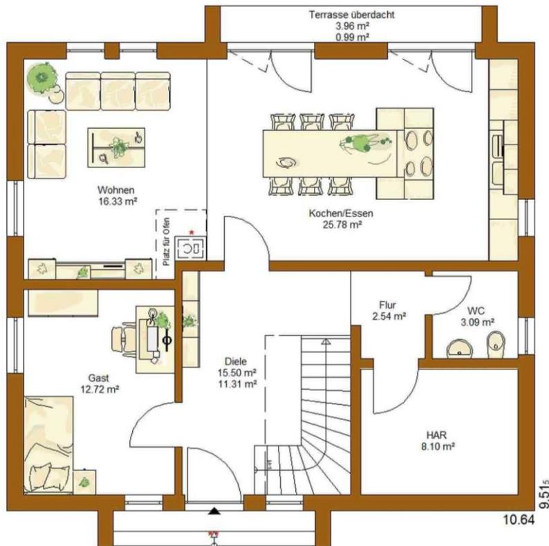
Abbildung 2.5: Typischer Regelgrundriss eines Einfamilienhauses <sup>1</sup>
