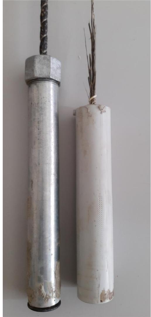
**Abbildung 5.2: Probe in der Zugprüfmaschine (linkes Bild), Verankerungshülsen aus Stahl (Durchmesser 8 mm und 10 mm) und Kunststoff (Durchmesser 6 mm) (rechtes Bild)**
