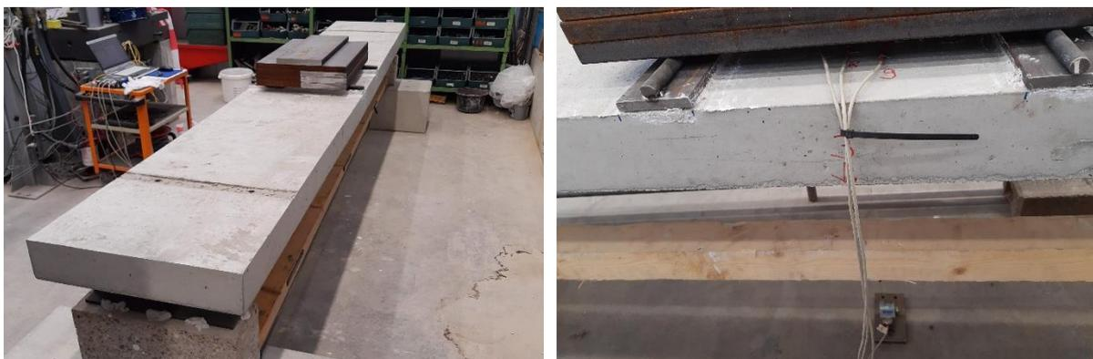
**Abbildung 4.9: Versuchsstand der Langzeitversuche (links) und angebrachte Messtechnik (rechts)**
