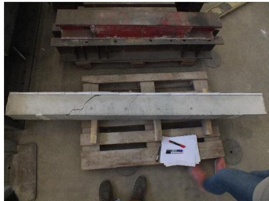
Abbildung A 41: Entwicklung des Schubrisses unmittelbar vor dem Bauteilversagen (links) und Versuchskörper (Q.B.8C25.0,37.3,5) nach der Prüfung (rechts)
