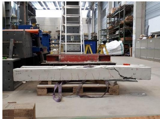
Abbildung A 44: Entwicklung des Schubrisses unmittelbar vor dem Bauteilversagen (links) und Versuchskörper (Q.B8.C25.0,73.3,5) nach der Prüfung (rechts)
