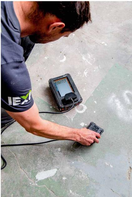
**Abb. 4:** Gunter Hahn analysiert mit einem Impuls-Echo-Radar die Decke über dem ersten Geschoss und sieht so, wo im Inneren des Betons die Stahlbewehrung verläuft. Das muss er wissen, um eine geeignete Position für den Stahlrahmen und die Verankerungspunkte zu bestimmen (Foto: Maximilian Johnson/HTWK Leipzig)
