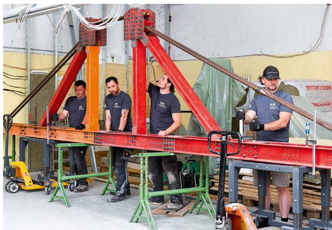
**Abb. 1:** Um die Traglast zu überprüfen, errichtet das Team von IEXB ein neun Meter langes Stahlrahmensystem. Es dient als Rückverankerung für die hydraulischen Pressen, welche genau dort auf den Boden drücken, wo es kritisch werden könnte. Diese Stellen haben die Bauingenieure Gunter Hahn (2.v.l.) und Markus Fischer (3.v.l.) in der Vorplanung berechnet. (Foto: Maximilian Johnson/HTWK Leipzig)
