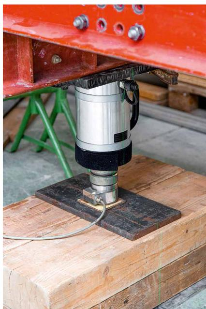
**Abb. 2:** Beim Belastungstest wird ordentlich Druck gemacht: Ein Hydraulikzylinder kann bis zu 38 Tonnen Last erzeugen. Zwei davon sind in Limbach im Einsatz (Foto: Maximilian Johnson/HTWK Leipzig)
